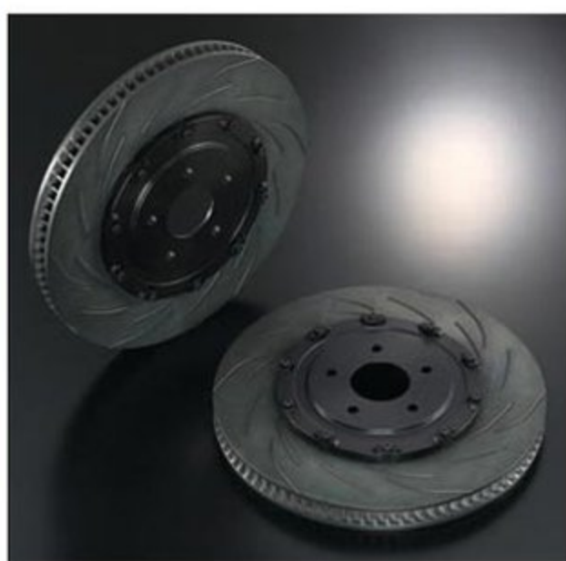
バージョンS以上の曙ブレーキ製キャリパー装着車にそのまま装着できるオリジナルローター。ノーマルと違い、サーキットの連続周回も難なくこなすことができる高性能アイテムだ。ベルハウジングはハードアルマイト加工が施されており、価格は13万円となっている。
