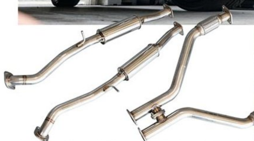
スーパーチャージャーのハイフロー化に合わせてフロントパイプ&センターパイプをよりヌケの良いものへとリニューアルするそうだ。フロントパイプは左右を連結しているのがポイントで、サウンドが大きく変わるということ。
