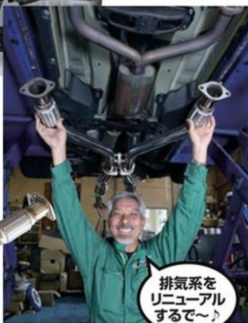
スーパーチャージャーのハイフロー化に合わせてフロントパイプ&センターパイプをよりヌケの良いものへとリニューアルするそうだ。フロントパイプは左右を連結しているのがポイントで、サウンドが大きく変わるということ。
