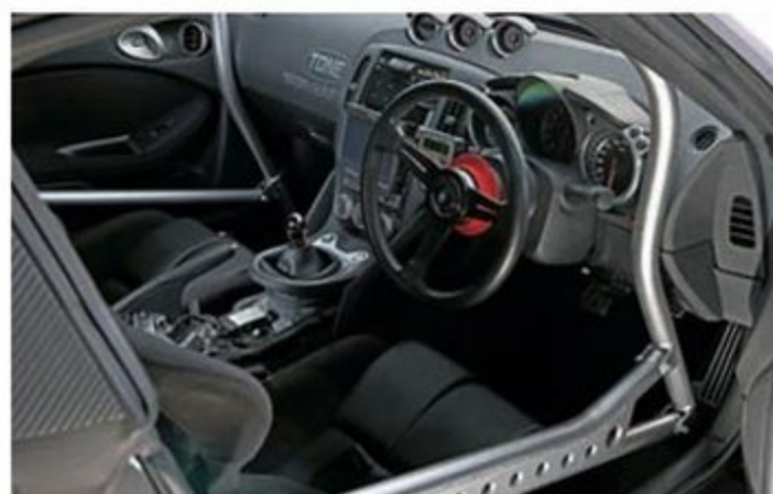
ストリートでの使用を前提とした室内にはオーディオも装備する。サーキットでの安全性を確保するためにロールオーバーも組み込まれる。車重は1430kgほど。
