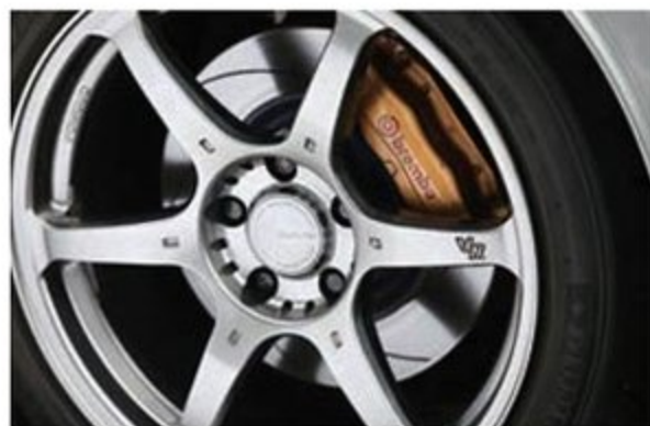
エンドレスのノーマルサイズスリット入りブレーキローターとパッド、ホースで強化したブレーキがお気に入り。ホイール&タイヤはVR.G2にディレッツァZII☆(245/40R18、275/35R19)の組み合わせだ。
