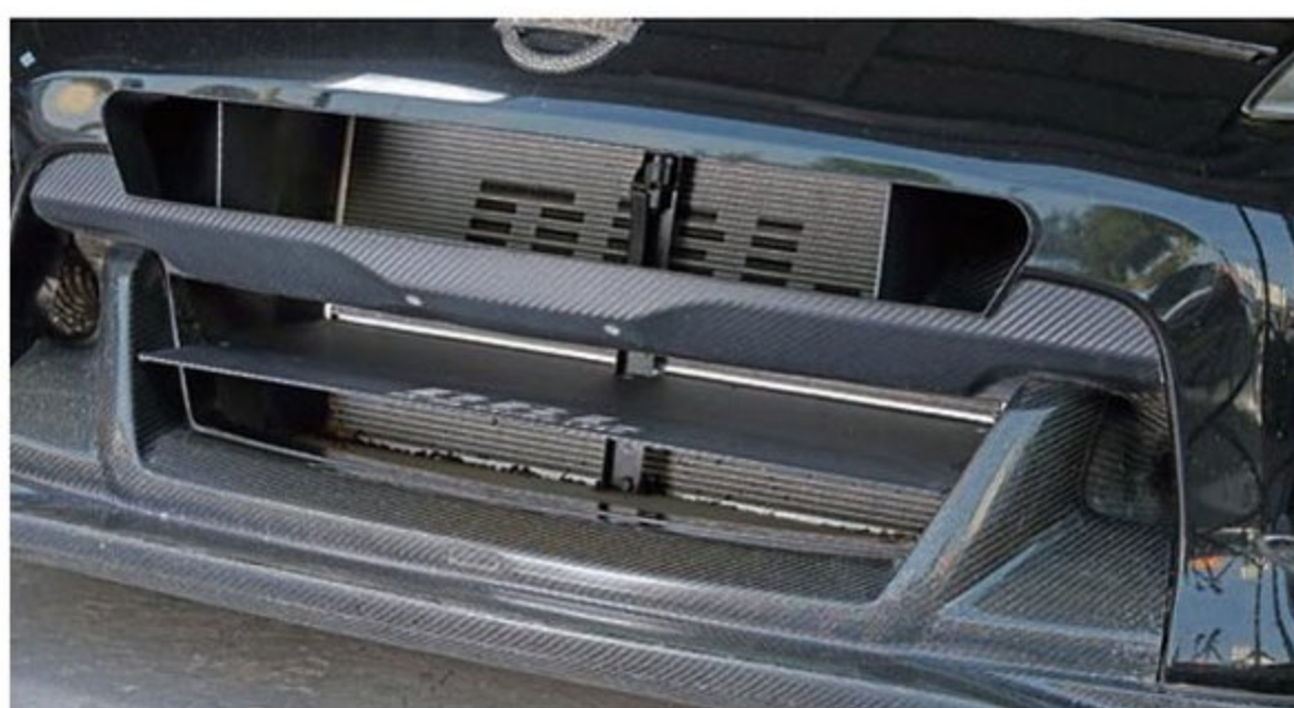
バンパーダクトから取り入れた走行風を逃がさないようにシュラウド状にすることで、安定した冷却性能を発揮。ラジエターはオイルクーラーを一体化したDRL対の4413オリジナルバージョン。こちらはオイルクーラーが大型化されており、真夏の連続周回も可能になる。水温90℃、油温120℃で安定させる。
