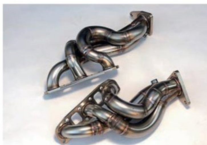
42.7φ→50φ→60φのエキマニもオリジナル。太さを変えるポイントを50mm単位で調整することで、トルクピークの回転域をチューニングしている。
