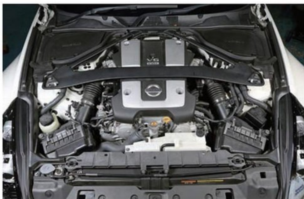
エンジンチューニングは吸排気とコンピューターのみ。速さを求めているわけではないのでこれでも十分なのだが、今後はATミッションとの相性も良いスーパーチャージャー仕様へと進化するかもしれない。
