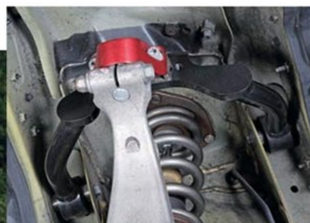
キャンバー&キャスター角が調整できるオリジナルのアップーリンクを装着してアライメントを煮詰めている。また、フロントのロアアームピロブッシュ(12万円)を装着するとステアリングの剛性感とブレーキングの安定性がアップするそうだ。
