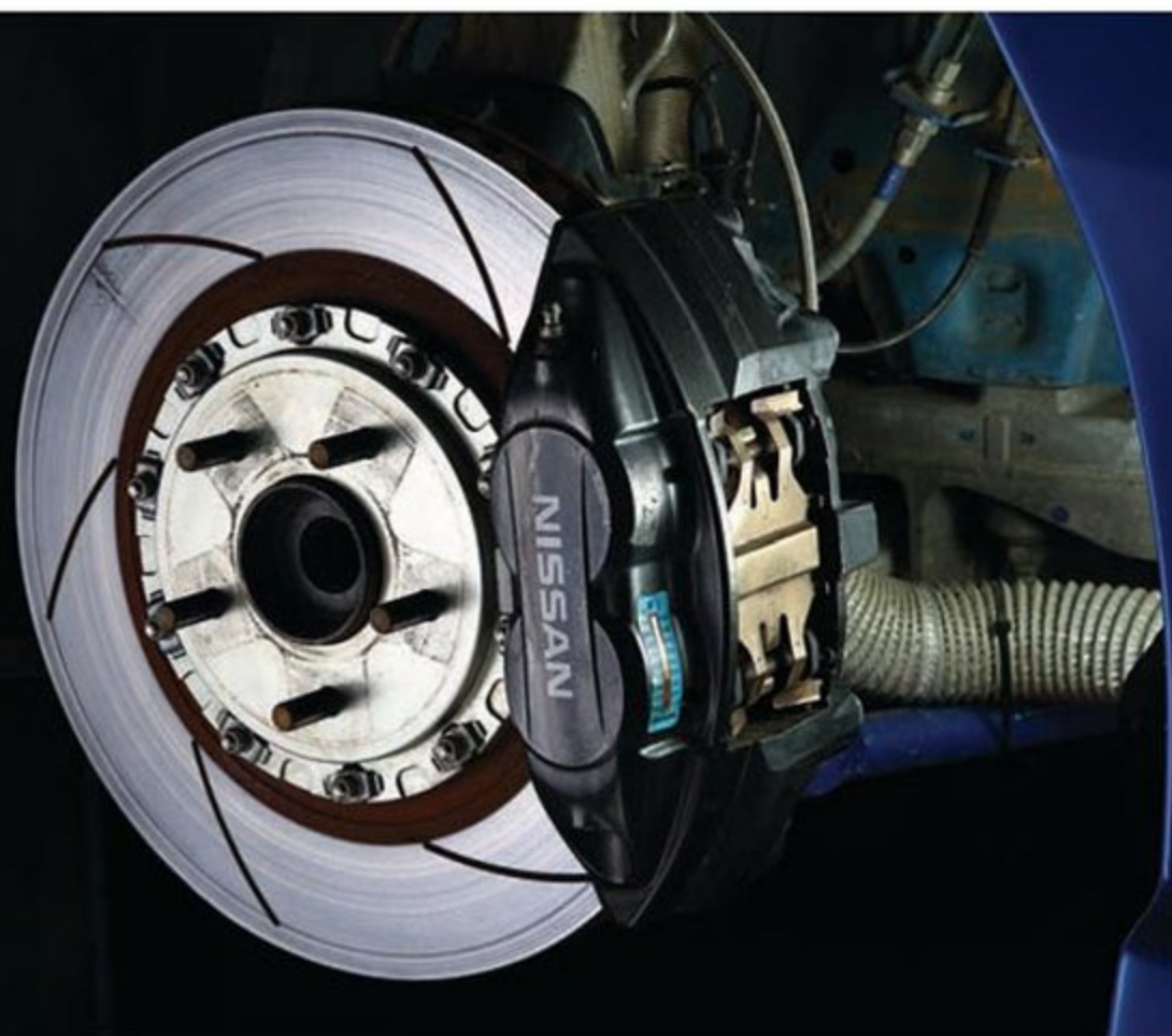
バージョンS以上の曙ブレーキ製キャリパー装着車にそのまま装着できるオリジナルローター。ノーマルと違い、サーキットの連続周回も難なくこなすことができる高性能アイテムだ。ベルハウジングはハードアルマイト加工が施されており、価格は13万円となっている。
