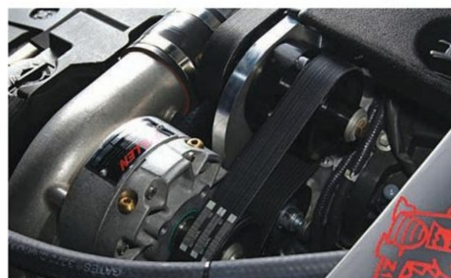
コンパクトながら大風量を実現しているコンプレッサは遠心式。Z34にはオプションのハイブーストブリーを装着することで、よりハイパワーを可能にしている。全域が底上げされる扱いやすいパワーで、速さと乗りやすさを同時に手に入れることができる。
