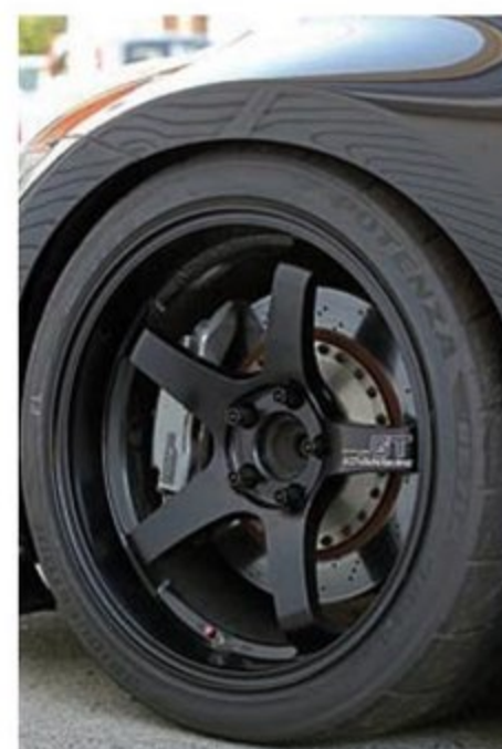
アドバンレーシングGTの19インチに275/35サイズのポテンザRE-71Rを組み合わせる。ラジアルタイヤは荷重移動させてこそグリップ力を引き出せるとの考えから、適正量のロールを受け入れるセッティングにしているようだ。
