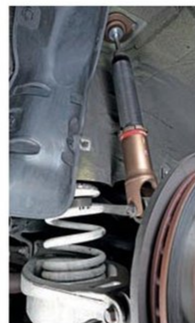
足まわりはスピリット製のダンパーを使用したフジムラオートのオリジナルスベック。スプリングレートはサーキット走行向けにフロントが16kg/mm、リヤが14kg/mmとなっている。
