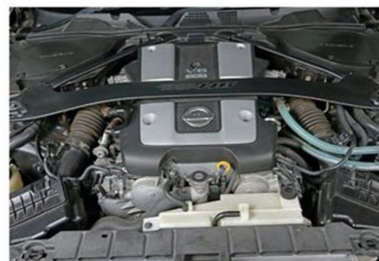
エンジン本体には一切手を加えていない。オリジナルのエキマニ&マフラー、チューンドECUで最高出力398ps、最大トルク41kg・mを発揮する。レプリミットは8500rpmに設定。
