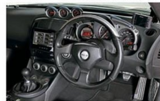
純正のスタイルをしっかりとキープしたシンプルなメーターまわり。エンジンからの各種情報は、HKSのCAMP 2でナビのモニターに表示させている。コンビメーターと3連メーターにはオリジナルの人工皮革エクセーヌ仕上げのカバーを装着して質感を向上させている。
