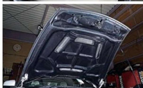
オリジナルのエアロボンネットは特殊な形状によってエンジンルーム内に雨水の浸入を最小限に抑えているということ。カーボン綾織仕様は13万8000円でFRP仕様は9万8000円となっている。
