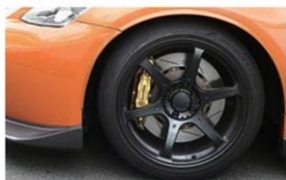
そのほかでお気に入りのパーツといえばブレーキ。フロントはブレンボF50タイプキャリバーとローターにPFCパッド、リヤはエンドレスローターを組み合わせている。タイヤはフロント265、リヤ275サイズのポテンザRE-71Rを選択。
