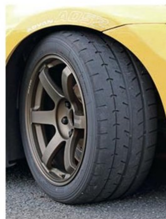
以前は19インチでテストを行っていたが、現在はよりグリップ力の高いアドバンA052の18インチ(フロント255/40-18&リヤ295/35-18)を装着。ホイールはTE37SAGAの9.5J&10.5Jをチョイスしている。
