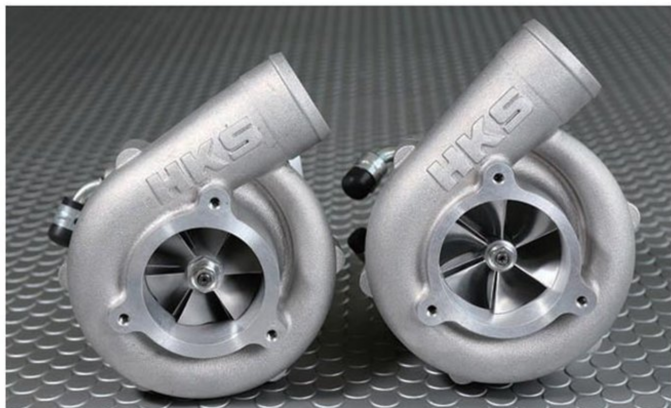
右側が今後装着される予定のハイフローユニット。ブレードのサイズはノーマルがHKS製タービンでいうところのGT3240クラスであるのに対し、ハイフロー仕様はGT3540あたりの風量になるという。エンジン内部がどこまで耐えるかはテストしてみないとわからないとのことだが、現在装着されている550ccインジェクターを使い切る500psオーバーを狙うということだった。
