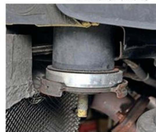
リヤメンバーの取り付け剛性を飛躍的にアップさせることができるリヤメンバーカラー。リヤの挙動が掴みやすくなると同時にトラクションもアップする。
