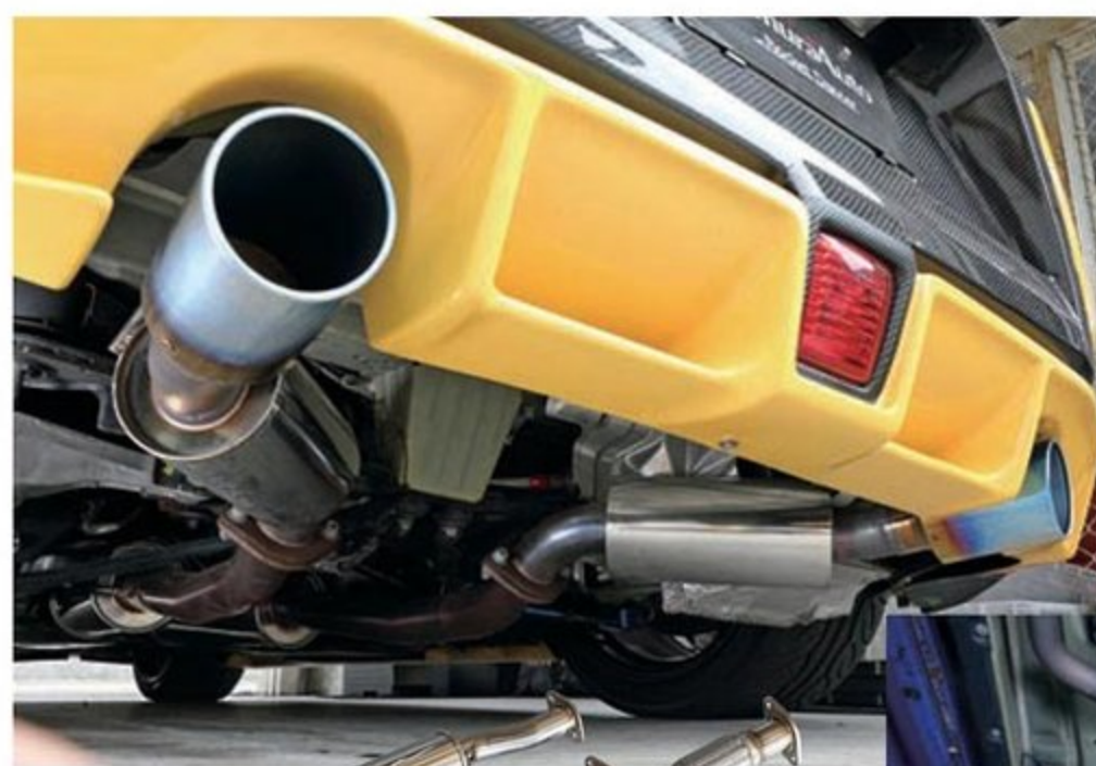
Z34のリヤスタイルに迫力を与えるチタンテール2本出しマフラーは、ジェントルサウンドマフラーの限定モデル。排気効率は大幅に向上しているが、独自の消音構造によりノーマル以下の音量となっている自慢の逸品だ。価格は10万8000円(6万9000円/ステンテール)となっている。
