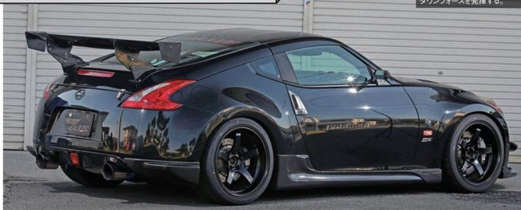
アドバンレーシングGTの19インチに275/35サイズのポテンザRE-71Rを組み合わせる。ラジアルタイヤは荷重移動させてこそグリップ力を引き出せるとの考えから、適正量のロールを受け入れるセッティングにしているようだ。
