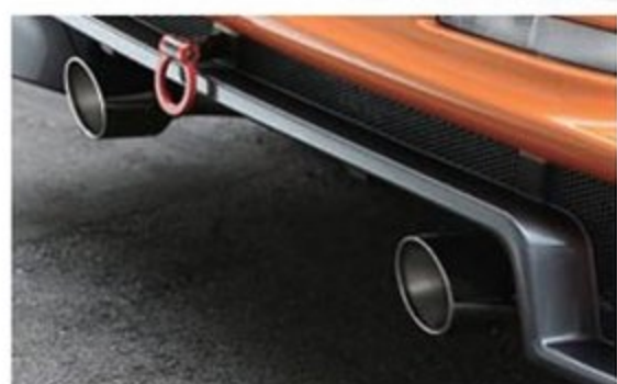
なんといっても自慢なのは、取材当日に取り付けたばかりの新作スポーツタンマフラー。取り外したマフラーと持ち比べながら、純正比8.6kg減の軽さを実感して大満足の様子だったぞ。
