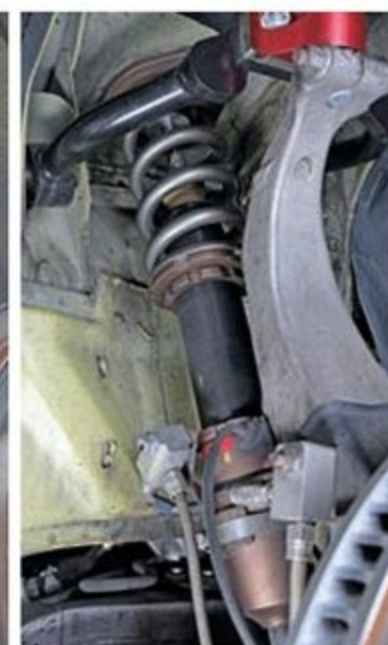
足まわりはスピリット製のダンパーを使用したフジムラオートのオリジナルスベック。スプリングレートはサーキット走行向けにフロントが16kg/mm、リヤが14kg/mmとなっている。
