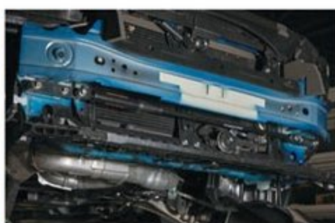
軽量高剛性なエアインテーク。パウダースノー対策で装着されているレゾネーター部の蓋を解放することにより本来の性能を発揮する。
