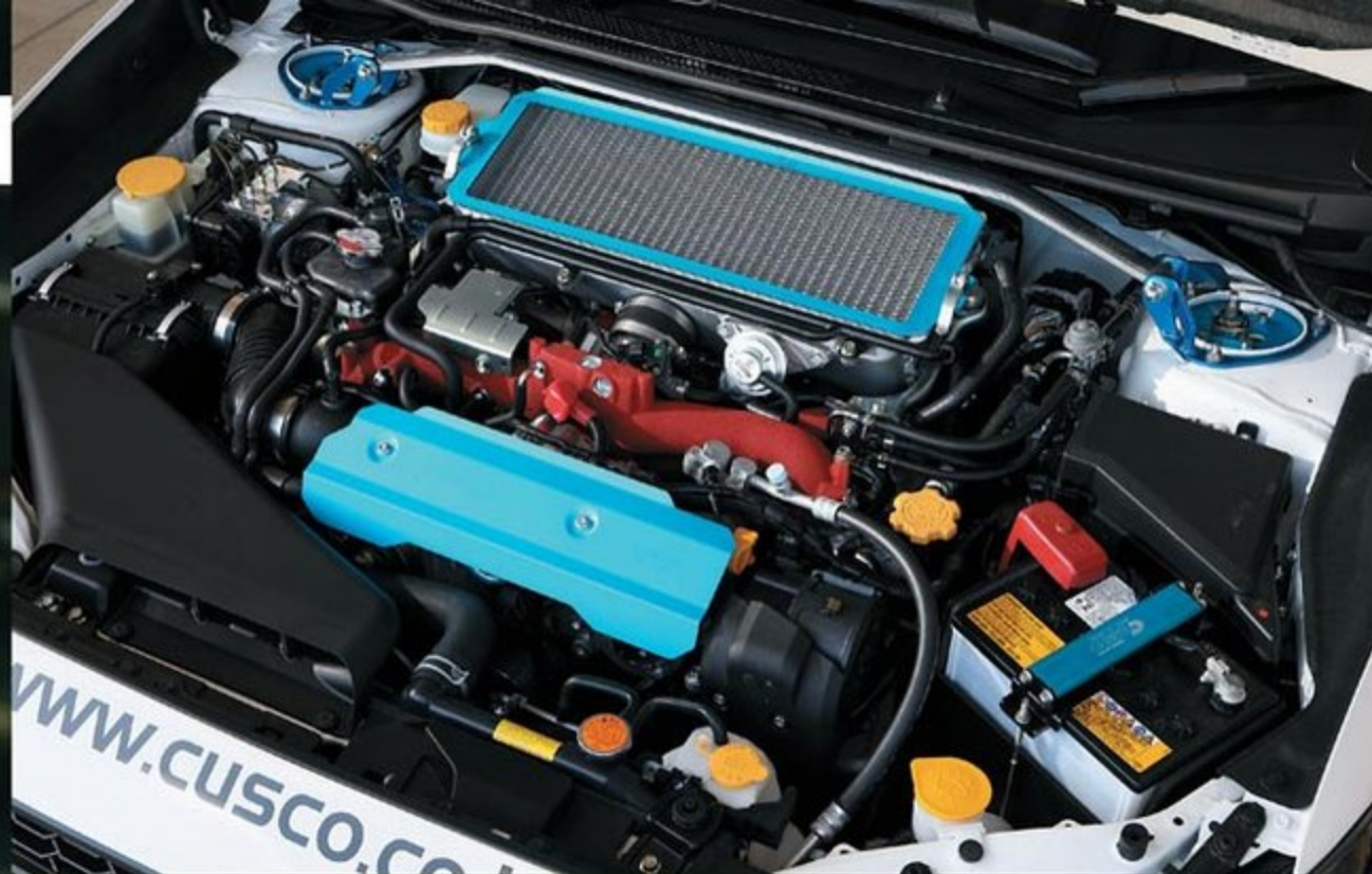
左右のストラットタワーをバーで結合して不要なヨレを低減するタワーバー(1万5000円)や小石などによるコア破損を防ぐインタークーラーネット(1万4800円)も人気だ。
