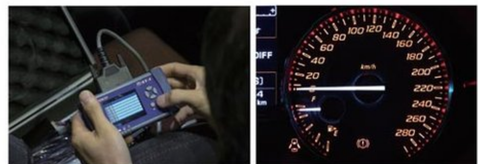
ツールは故障診断端子につないで、本体に記憶されている該当車種を選択後、リセットを掛ける。チェックランプはこれでしか消せない。
