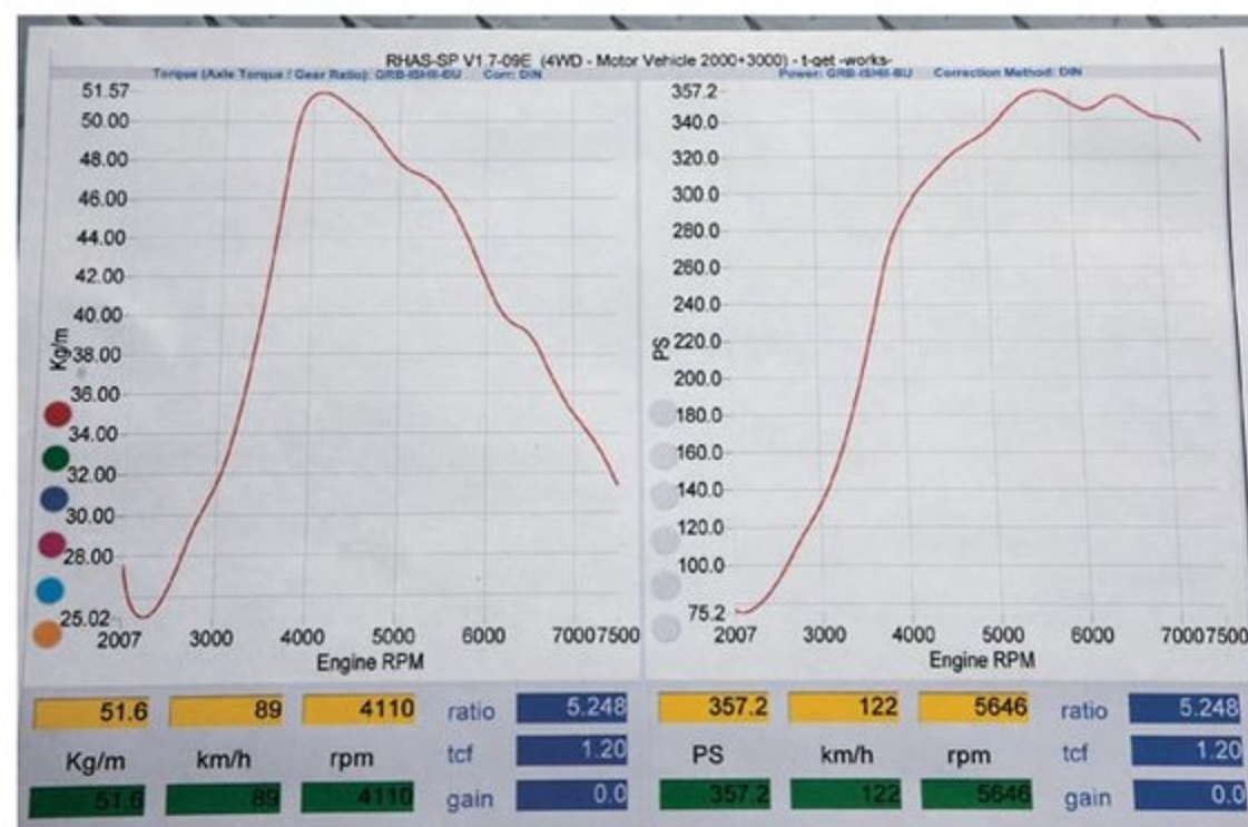
写真のGRBのデータ。このクルマもエアフロ取り付け法から換えている。ツルシデータでも問題ないだろうが現車セッティングのほうがよりよい結果になる。
