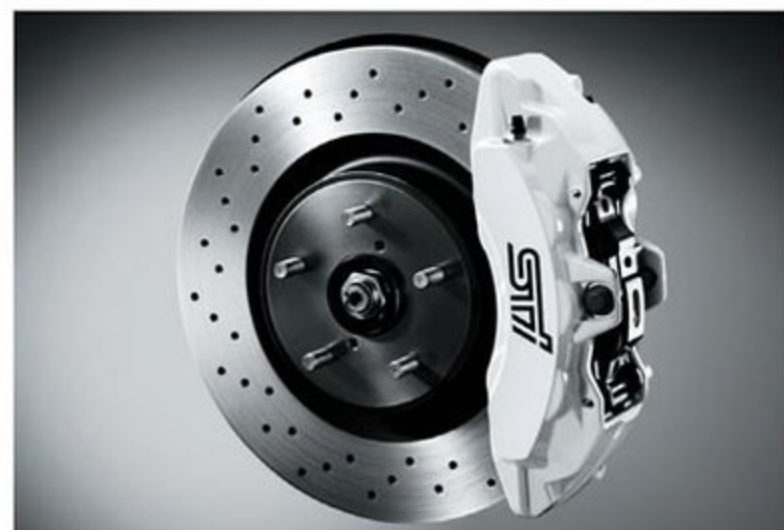
ストップパワーだけでなくコーナリングでのコントロール性や耐久性なども考慮して採用された、ブレンボ製の6ポット・モノブロックキャリパー
