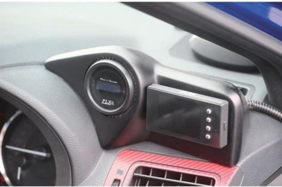
追加メーター(60φ)とコントローラー&レーダー探知器を取り付けるための便利アイテム。純正パネルに沿った形状となっており、スッキリと収まるのがマル。カーボンとFRPの2タイプ。
