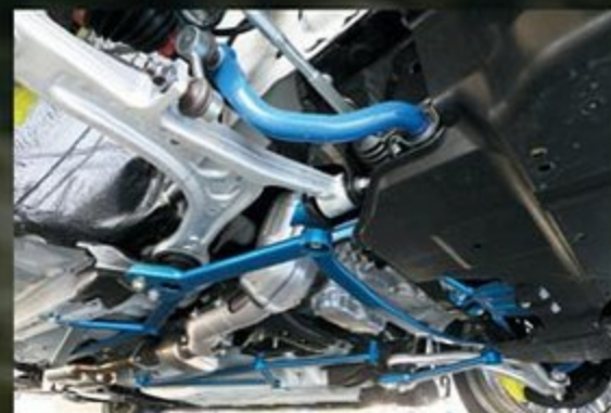
フロントメンバー周辺やロアアームまわりも徹底補強。普段は見えないパートだが、下まわりの補強は大きな効果が期待できる。フロントロアアームバー(7500円)も追加。
