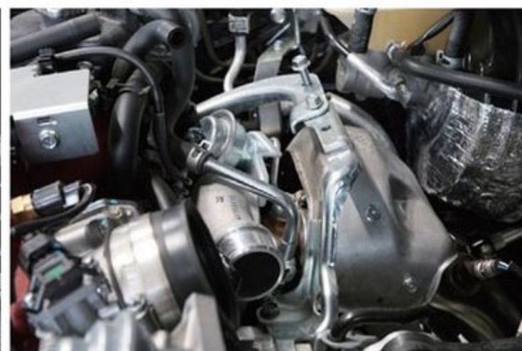
ブーストはピークで1.4kg/cm2。ノーマルより落としているがパワーは出ている。また、EVC6でブーストマップの調整も行なっているのでタレも少ない。EVC6は「ブーストアップパック」に含まれている。
