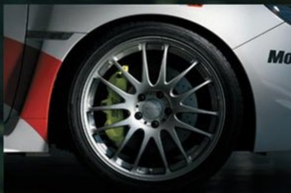
シティユースをメインに考えてセレクトしたポテンザS001の19インチタイヤは255/35サイズ。ホイールはプロドライブGC-014iでサイズは8.5J×19+43となる。
