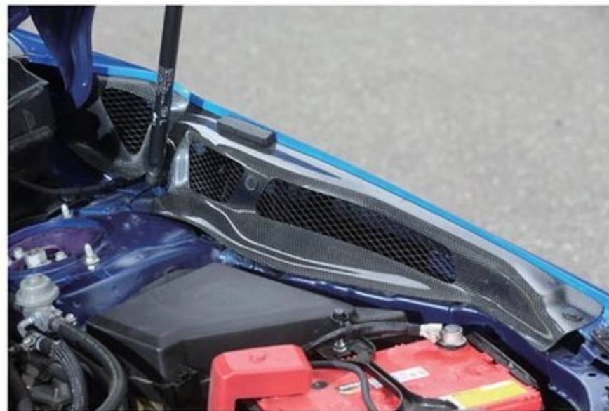
エンジンルームのドレスアップにも貢献するカーボン製のフェンダープロテクター。オプションの穴開け加工をすれば、エンジンルームの熱気を排出することも可能だ。S耐車両にも投入される逸品。
