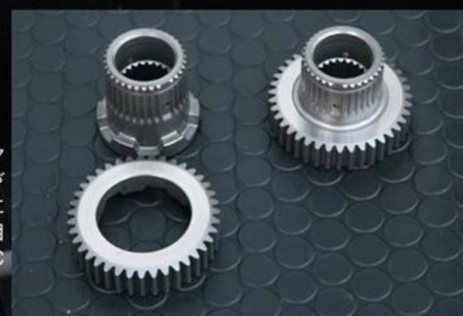
DCCDのハード面はサンギアが変更となった。写真右側が新たにVAB-D型から採用になった一体式で、左側が鷹目GDBインプレッサからVAB-C型までの分割式。
