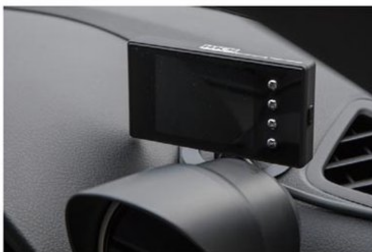
ブーストはピークで1.4kg/cm2。ノーマルより落としているがパワーは出ている。また、EVC6でブーストマップの調整も行なっているのでタレも少ない。EVC6は「ブーストアップパック」に含まれている。
