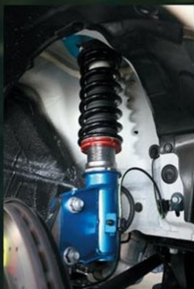
ストリートからミニサーキットまで対応するゼロA車高調(16万円)は、40段の減衰力調整機構付き。バネレートはF:7kg/mm、R:8kg/mmで、全長調整機能も備える。
