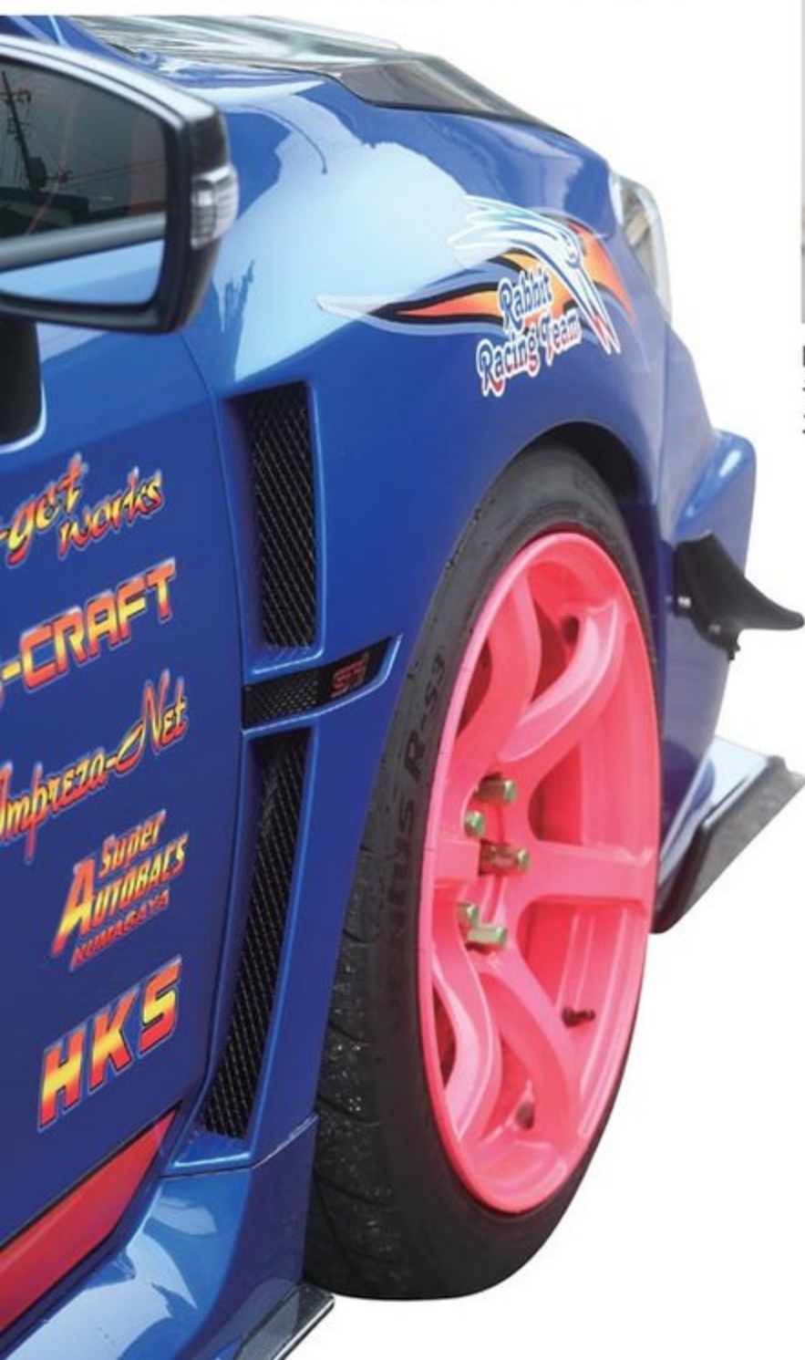
程よいポリウム感を持たせつつ、エンブレムの上下にスリットダクトを設けたフロントフェンダーは、記載変更なしで車検に対応できる片側8mmワイドタイプとなる。
