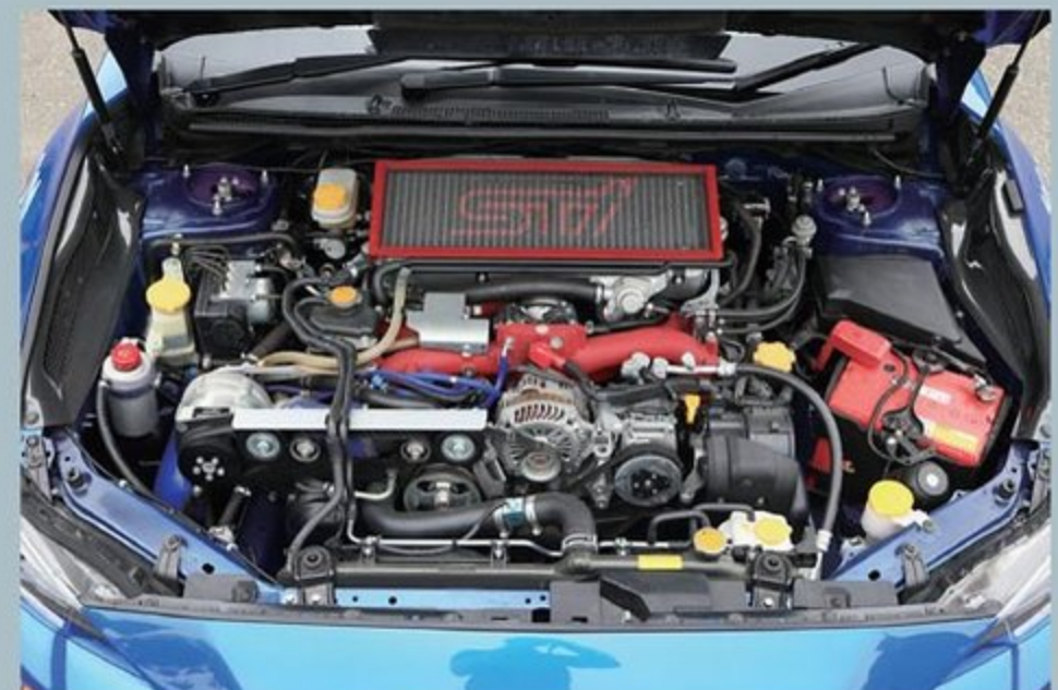
EJ20ターボにHKSスーパーチャージャーをドッキングしたツインチャージャー仕様は、下から上からスキなしの加速を披露。このようなパワーチューンにも対応する。
