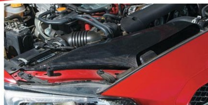
軽量高剛性なエアインテーク。パウダースノー対策で装着されているレゾネーター部の蓋を解放することにより本来の性能を発揮する。
