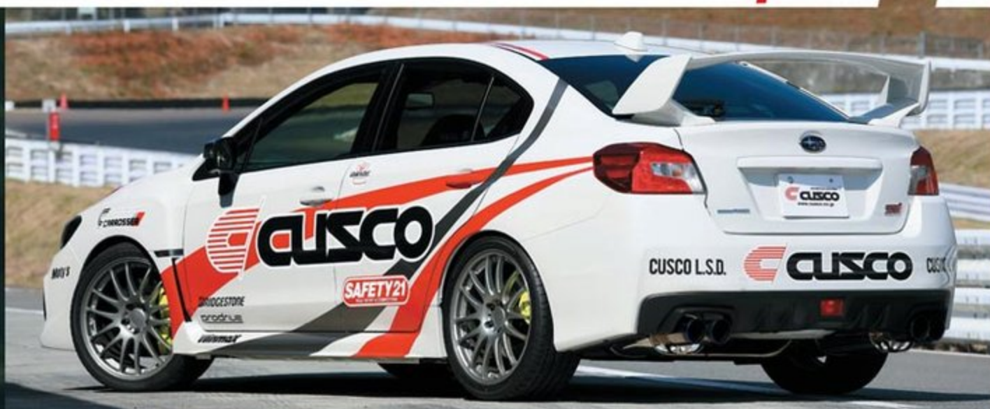
ストリートゼロA車高調により約25mmローダウンし、精悍さを増したクスコのWRX STI。一見、スパルタンな仕様に見えるが、パワー系はほぼノーマルのライトチューン。
