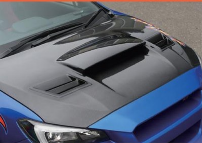
センターバルジ一体デザインとなるFRPボンネットは、熱気を排出するためのアウトレットも追加。雨水の浸入を防ぐカバー付きの親切設計で、純正ヒンジにも対応(撮影車両はワンオフのカーボン製を装着)。
