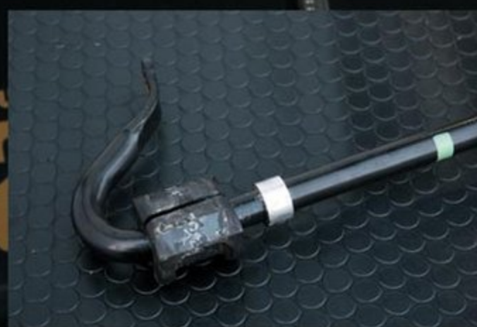
実はリアスタビライザーは、VABのA-C型で20mm径を採用していたのだが、今回のビックマイナーで19mm径に変更された。
