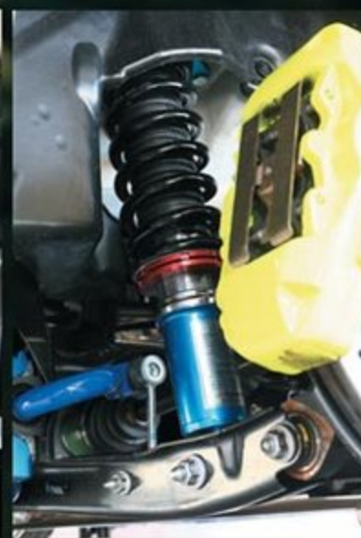
ストリートからミニサーキットまで対応するゼロA車高調(16万円)は、40段の減衰力調整機構付き。バネレートはF:7kg/mm、R:8kg/mmで、全長調整機能も備える。
