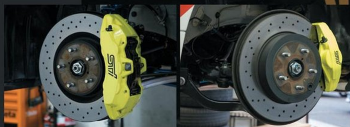
今回のマイナーでもっとも目を引くのはブレーキシステムかもしれない。鮮やかなイエローのbrembo製モノブロックキャリパーはフロント対向6ポット、リア対向2ポット。
