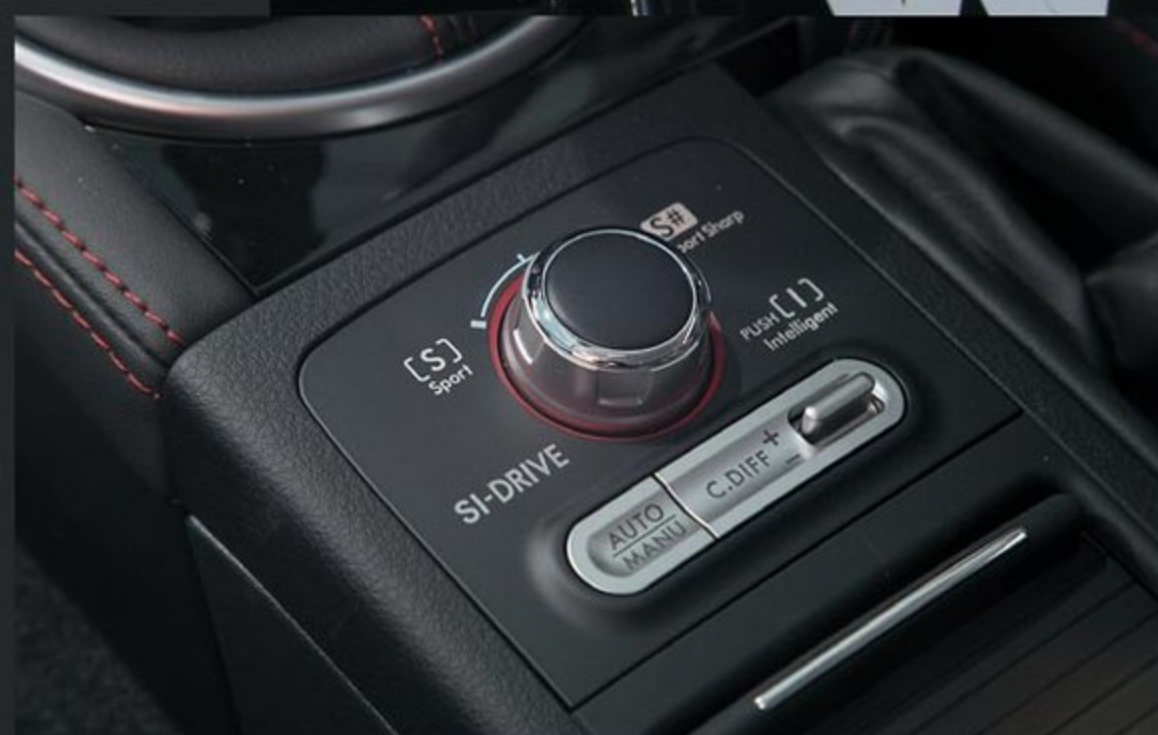
マルチモードDCCD(ドライバーズコントロールセンターデフ)は4つのトルク制御モードを採用。電子制御というソフト面は、アプライドごとに細かく仕様変更している。
