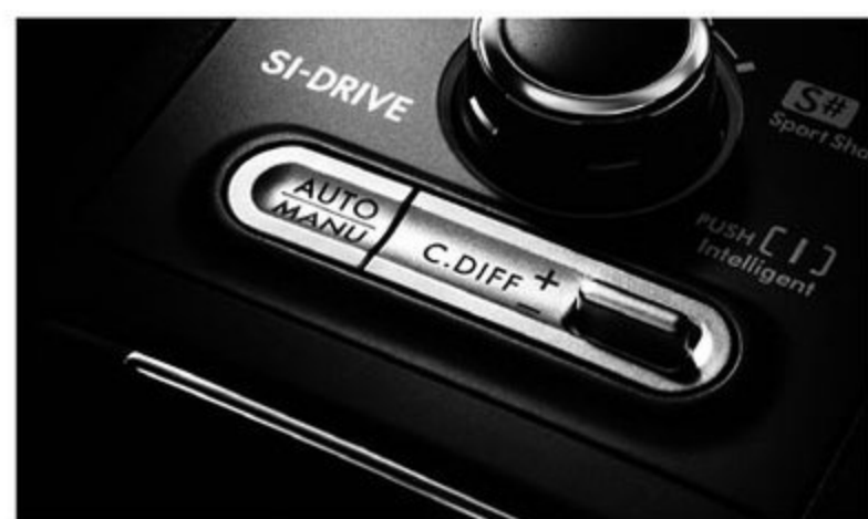
フル電子制御化された新DCCDでは回答性が大幅に向上。FRのような走りは、BRZで得られた知見が活かされているのだ
