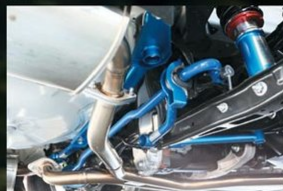
リアメンバーサイドやラテラルスタビ、メンバー&エンドのパワーブレースなどで補強することで後方のフロア剛性を高める。純正比130%の強化スタビライザーもセット。
