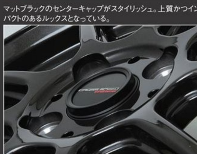
スポークのサイド面も剛性を確保しつつ、できる限り軽量化できるように考慮されている。リムのアウトサイドポリッシュがオシャレだ。
