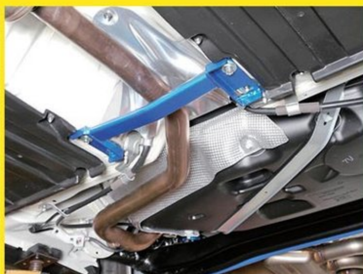
シャシー剛性をアップさせてくれるパワーブレースはフロント用が1万8000円、リヤ用が1万円とお手ごろ価格ながら効果絶大。この強化スタビなどもリリースを開始している。
