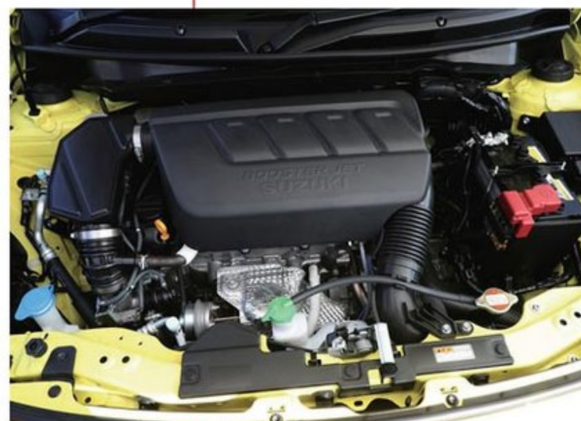
軽量化とともにより強靱なボディシェルを実現させたスイスポの走り味はスムーズで滑らかだ。エンジンは1.4ℓ直噴ターボ（140ps/23.4kgm）を搭載する。タイヤは195/45R17、ホイールは新開発の専用17インチアルミを履く。ちなみにフロント・サスはストラット、リアがトーションビーム。
