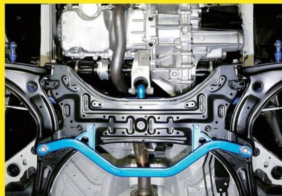
強化ピッチングストッパーは加減速時のレスポンスアップや挙動の乱れを抑制してくれるアイテム。価格は2万円となっているぞ。
