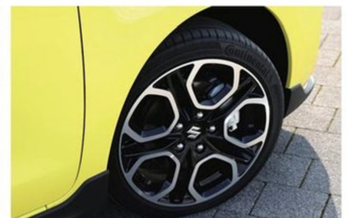
軽量化とともにより強靱なボディシェルを実現させたスイスポの走り味はスムーズで滑らかだ。エンジンは1.4ℓ直噴ターボ（140ps/23.4kgm）を搭載する。タイヤは195/45R17、ホイールは新開発の専用17インチアルミを履く。ちなみにフロント・サスはストラット、リアがトーションビーム。
