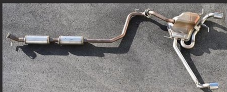
こちらは純正マフラー。メインパイプ以降のパイプの長さを揃えるなどかなり凝った設計だという。大きめのタイコで音質を調整しているのでは? との見解であった。
