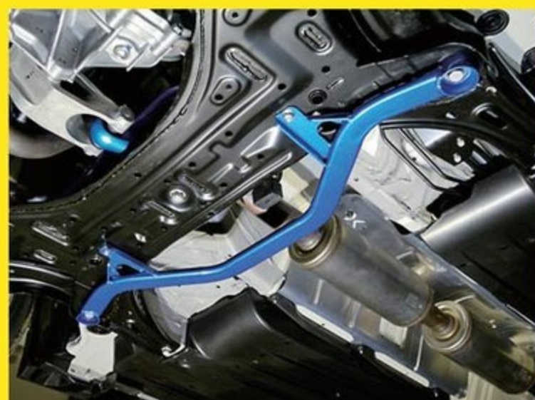
シャシー剛性をアップさせてくれるパワーブレースはフロント用が1万8000円、リヤ用が1万円とお手ごろ価格ながら効果絶大。この強化スタビなどもリリースを開始している。
