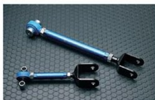
リヤタイヤの横方向の動きとアライメント変化を抑制する役割のリヤラテラルリンク。フロント側はピロボール、リヤ側は強化ゴムブッシュを採用。トー調整でコーナリング安定性やタイヤの接地性アップが可能。
