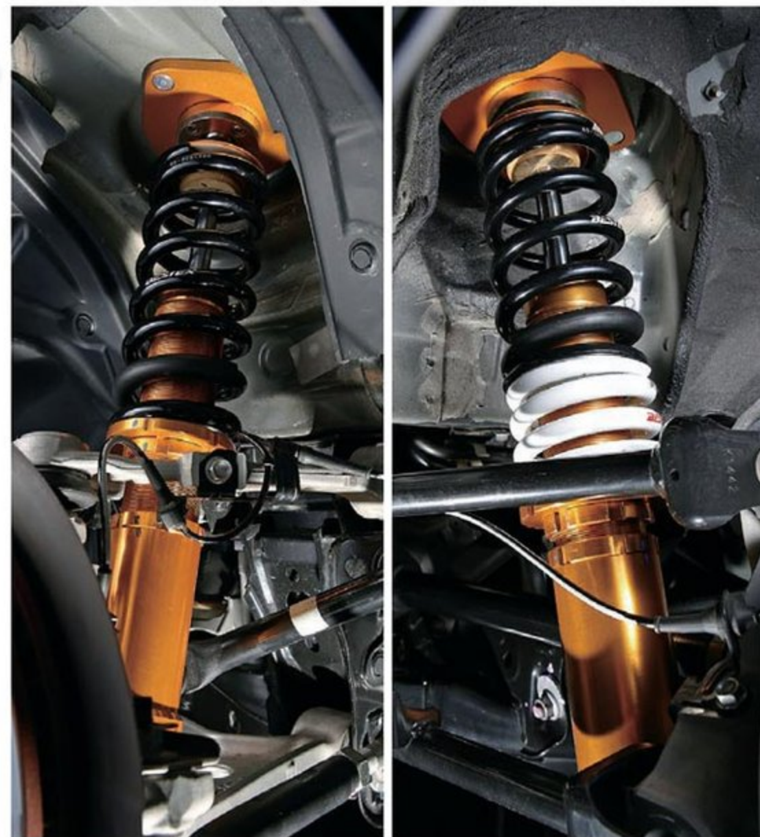
スピリットとの共同開発で生まれた「モナコススペシャル(28万8000円)」は、セミオーダー方式で好みに応じたセッティングに対応。スプリングはHALの低反発タイプで、フロント10kg/mm、リヤ8kg/mmが標準設定だ。
