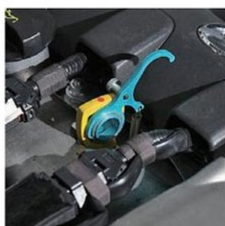
高回転、高負荷の連続走行によるオイルレベルゲージの抜けを防止するのが、発売されたばかりのレベルゲージストッパー。クスコブルーのアルミアルマイトは、エンジンルームのドレスアップ効果も高い。
