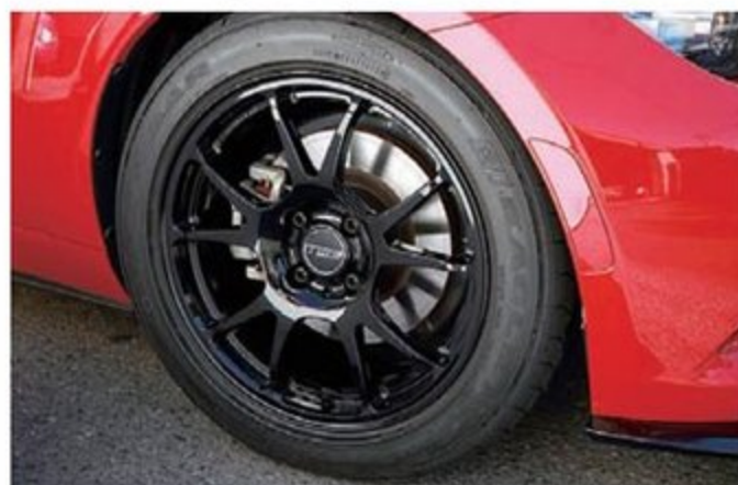
ロードスターに最適化された16インチのTWS製T66-JFD。軽くて強い鍛造品で、リム幅は7.5でインセットは+28。色はグロスブラック、フラットブラックの2種類をラインアップする。
