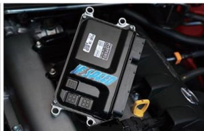
コンピュータチューニングは、フラッシュエディター（HKS標準/ジョイファスト仕様の2種類）、そして純正ECU書き換えメニューを用意。デモカーでは、オープン車には書き換え、RFにはフラッシュエディター（ジョイファスト仕様）が採用されている。
