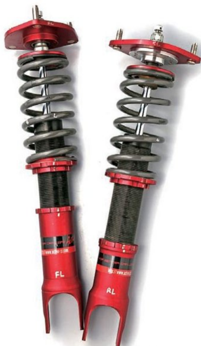
スピリットとの共同開発で生まれた「モナコススペシャル(28万8000円)」は、セミオーダー方式で好みに応じたセッティングに対応。スプリングはHALの低反発タイプで、フロント10kg/mm、リヤ8kg/mmが標準設定だ。
