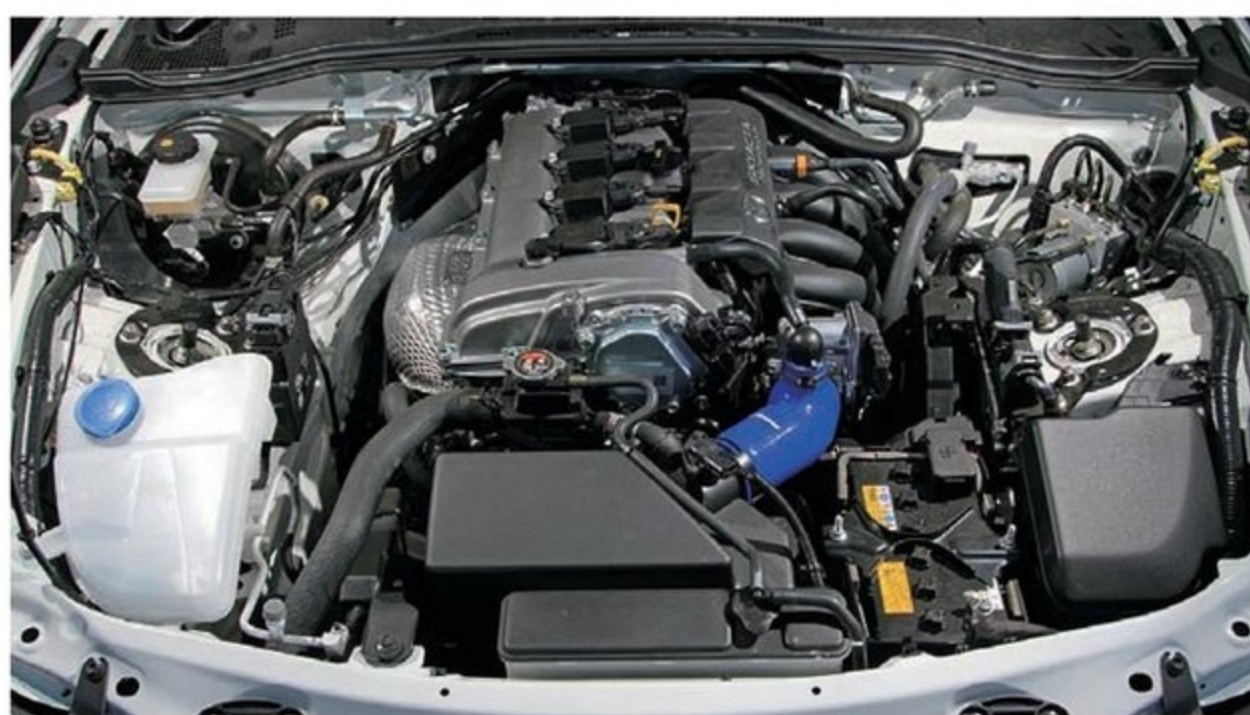
1.5LのNAということで大幅なパワーアップは難しいが、ビッグスロットルの装着を始めたライトチューンでグンと楽しくなる。駆動系や冷却系までしっかりとやれば、サーキットの連続周回でも問題ナシだ。
