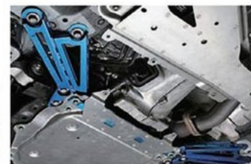
ボルトオンで効果的にボディ剛性アップが図れるパワーブレースは、フロント、フロアーセンター、フロアーリヤの3タイプをラインアップ。なかでもフロアーセンターは、前後ねじれの抑制効果が大きく効果を体感できる。
