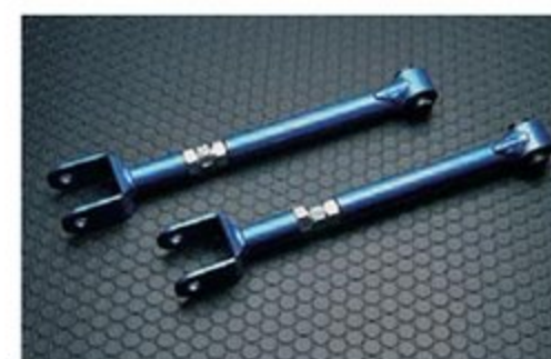
トールリンクロッドによるキャスター角調整で、リヤタイヤの前後の動きとアライメント変化を抑制。加減速時のジャダー防止やタイヤの接地性を向上させる。ボディ側ブッシュは強化ゴムタイプを採用。
