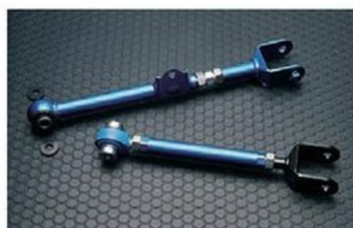
キャンバー角調整を可能にするのがリヤアッパーアーム。タイヤの内ベリや不安定な挙動の改善のほか、トラクションやブレーキ性能の向上を可能にする。フロント側、リヤ側ともピロボールタイプ。
