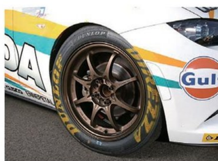
足元はボルクレージングCE28にディレツァβ02を組み合わせる。サイズは16×7.5Jに205/50。ジムカーナの定番サイズをきっちり使い切る仕様となっている。
