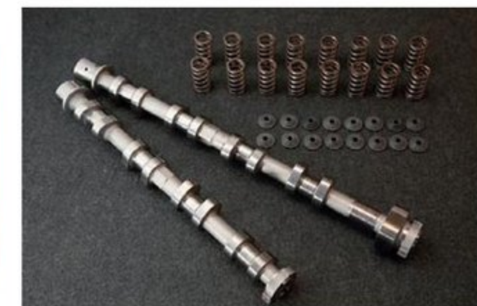
2ℓエンジン用に開発を進めているオリジナルのカム。高回転まで回すことを念頭に、バルブスプリング、リテーナーを設定。完成が楽しみだ。
