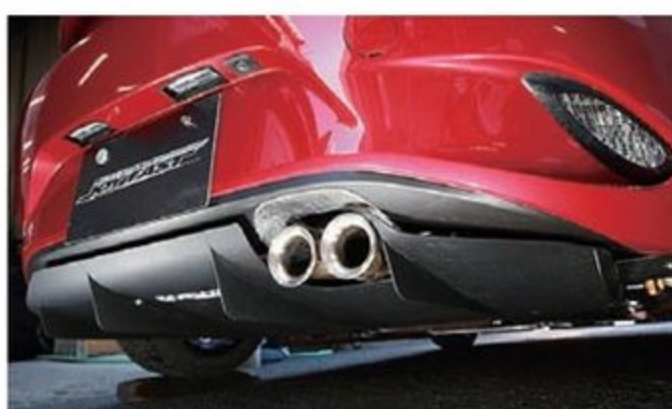
RFにはVELOX製のディフューザーも装着されていた。ダウンフォースの獲得、リアまわりのスポーツ性アップに貢献。
