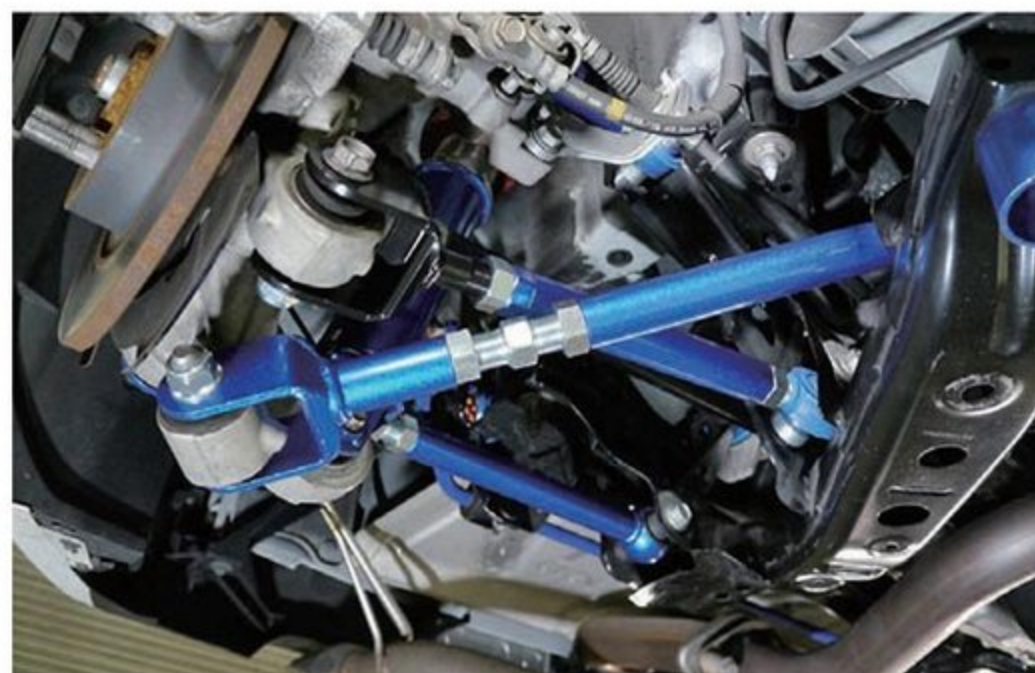
マルチリンク形式を採用するND系ロードスターのリヤサスペンション。車高調やハイグリップタイヤのポテンシャルを最大限に発揮させるために、調整式のアーム類が新たにラインアップされた。
