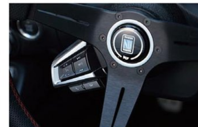
社外ステアリングに交換した際に、スイッチを移植するためのアダプターも開発（2万6000円）。使い勝手を損なわないアイテムも多数用意。
