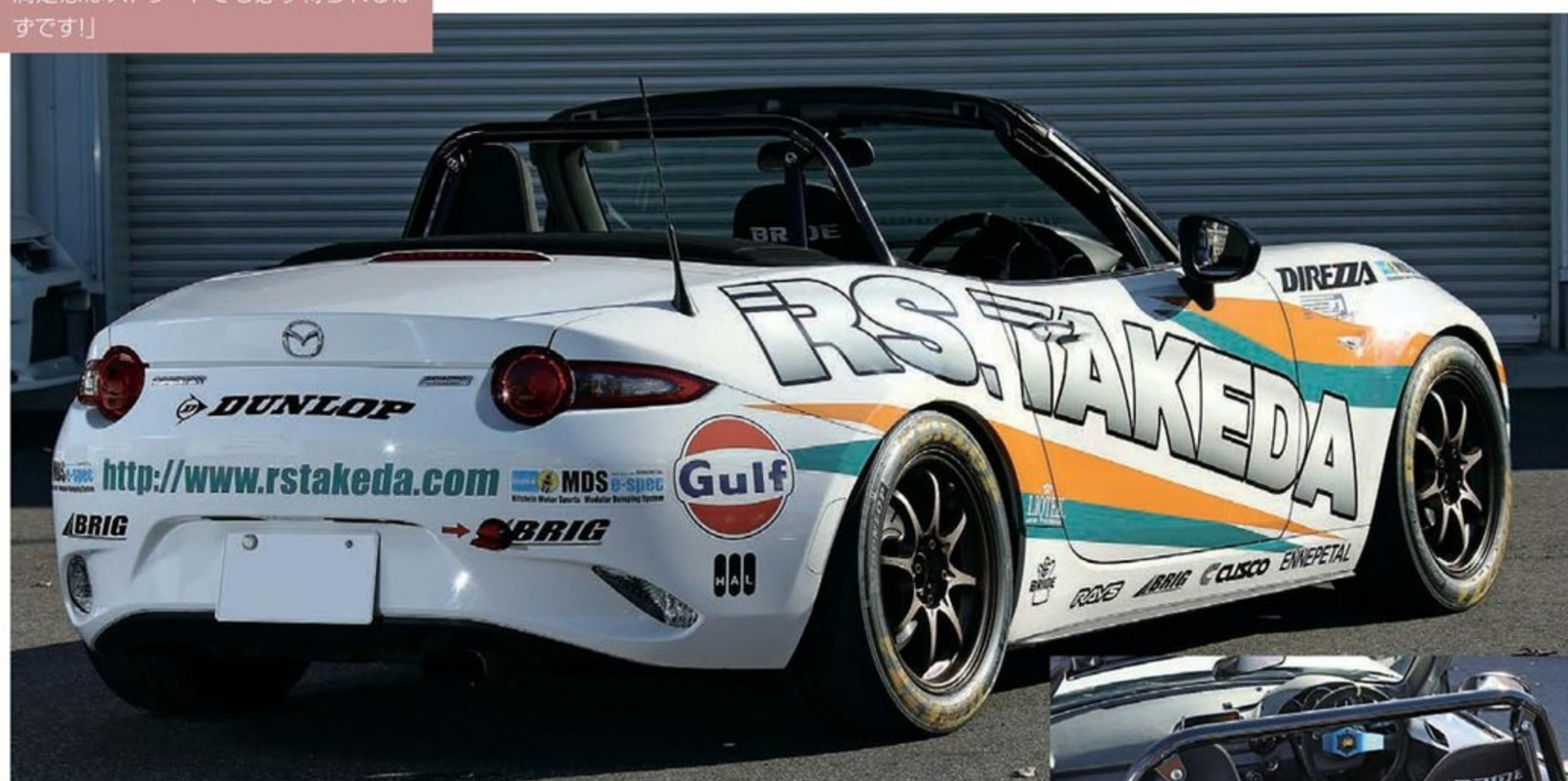
足元はボルクレージングCE28にディレツァβ02を組み合わせる。サイズは16×7.5Jに205/50。ジムカーナの定番サイズをきっちり使い切る仕様となっている。
