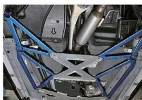
ボルトオンで効果的にボディ剛性アップが図れるパワーブレースは、フロント、フロアーセンター、フロアーリヤの3タイプをラインアップ。なかでもフロアーセンターは、前後ねじれの抑制効果が大きく効果を体感できる。
