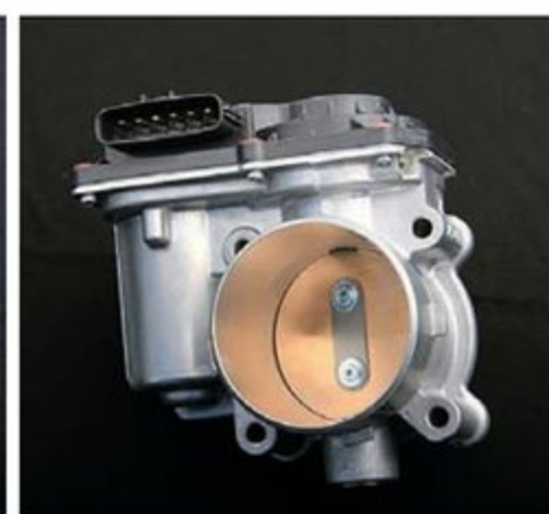
1.5LのNAということで大幅なパワーアップは難しいが、ビッグスロットルの装着を始めたライトチューンでグンと楽しくなる。駆動系や冷却系までしっかりとやれば、サーキットの連続周回でも問題ナシだ。
