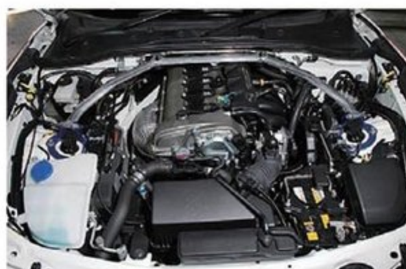
1.5・DOHCのP5型エンジンは完全なノーマルで、マグネット内蔵のスポーツオイルフィルターとネオジムドレンボルト、ハイプレッシャーラジエターキャップを装着。ストラットバーはオーバルシャフトタイプを前後に装着している。
