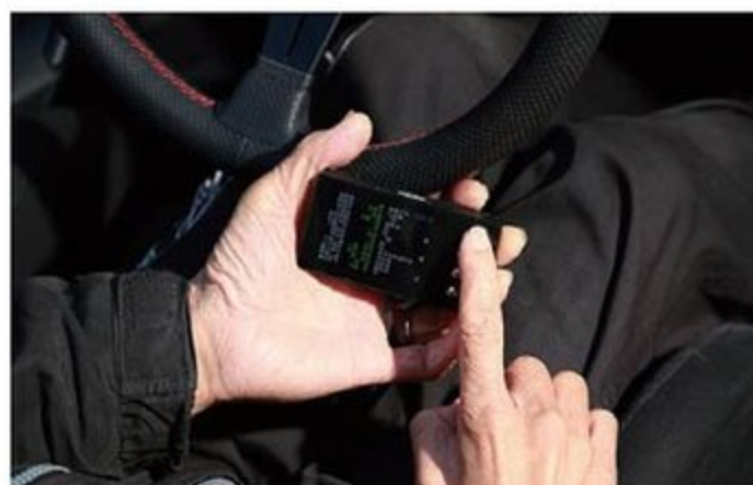
コンピュータチューニングは、フラッシュエディター（HKS標準/ジョイファスト仕様の2種類）、そして純正ECU書き換えメニューを用意。デモカーでは、オープン車には書き換え、RFにはフラッシュエディター（ジョイファスト仕様）が採用されている。
