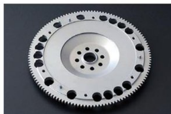
ノーマルの7.3kgに対し、4.5kgの設定とした超軽量フライホイールは、街乗りでの扱いやすさとシャープなレスポンスをバランスさせている。ほかに強化タイプのクラッチディスクとカバーもラインアップしている。
