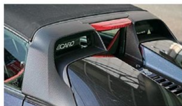
エアインテークダクトはカーボン調シートを張り込んだ。本物そっくりの質感だ。ウィズインターナショナルの各店舗ではこうしたラッピング施工の相談も大歓迎。美しく仕上げてくれる。
