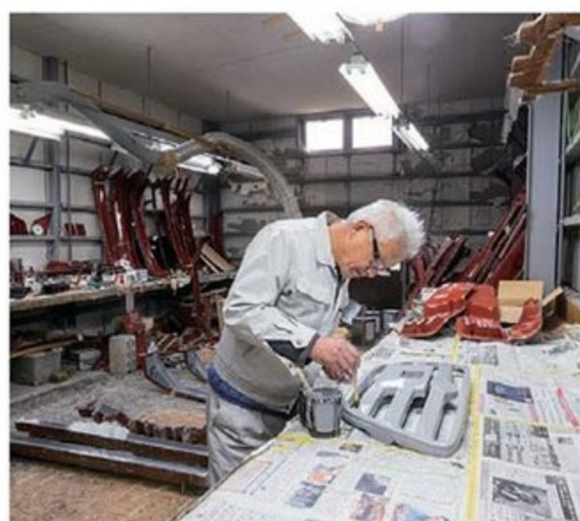
丁寧な手作業で高品質エアロを製作する、ジェイモードの奈良代表。この道40年以上の職人ワザが、歪みのない形状と高いフィッティング性、強度と耐久性を兼ね備えた製品を生み出す。
