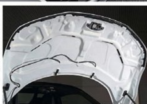
左右にエアアウトレットが配されたFRP製エアロボンネットは11万8000円(未塗装)。純正同様の2重構造となっており、強度はバツグン。水抜きに対しても考慮されているので雨天でも問題なく使用できるようになっているのだ。
