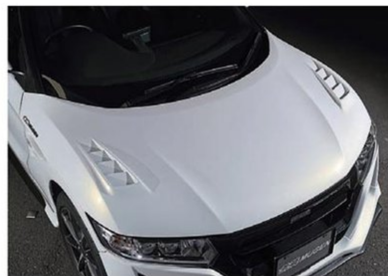
左右にエアアウトレットが配されたFRP製エアロボンネットは11万8000円(未塗装)。純正同様の2重構造となっており、強度はバツグン。水抜きに対しても考慮されているので雨天でも問題なく使用できるようになっているのだ。
