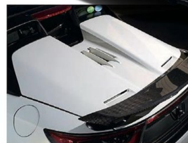
美しいツヤありブラック塗装済となっているFRP製ハードトップ。車内側にはルーフレイニング(内張り)も装備されており、標準ロールトップと同様にレバーにてロックできるようになっている。価格は21万8000円と高価ではあるものの、つい最近までバックオーダーを抱えていたというほどの人気アイテムとなっている。
