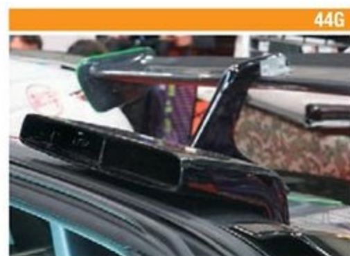
GT1 エンジンルームダクト
