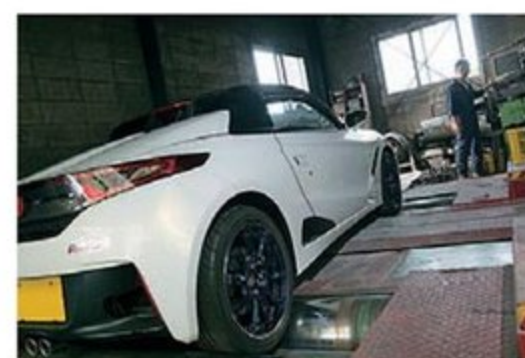
セッティングを変えてはシャシーダイナモで計測。不満な箇所はその場で改善。この地道な作業の繰り返し、乗り易くパワフルなクルマを生み出す源動力となっている。
