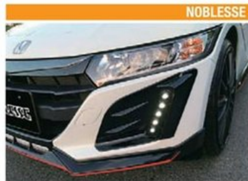
フォグダクトフレーム
