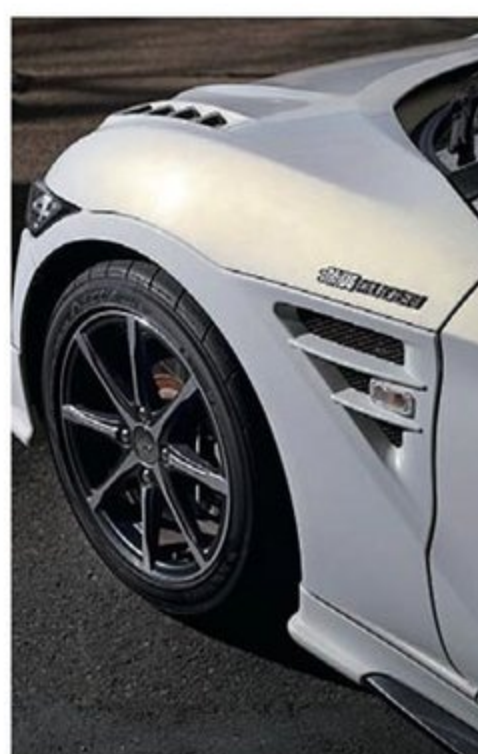
スチール製の標準フロントフェンダーに対してFRP製となるフロントエアロフェンダーの価格は8万円。エアアウトレットがスポーティなイメージを演出してくれる。
