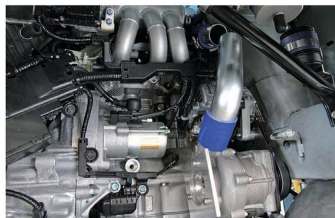
テストケースとして製作したスーパーチャージャー仕様。右下にHKSのコンプレッサーユニットが見える。過給機を感じさせない、中低速のトルクの太さが持ち味だった。
