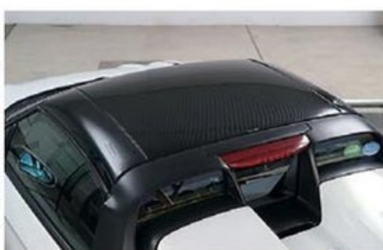
美しいツヤありブラック塗装済となっているFRP製ハードトップ。車内側にはルーフレイニング(内張り)も装備されており、標準ロールトップと同様にレバーにてロックできるようになっている。価格は21万8000円と高価ではあるものの、つい最近までバックオーダーを抱えていたというほどの人気アイテムとなっている。
