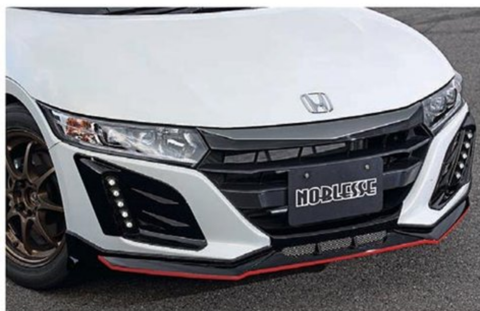
純正バンパーにそのまま装着できるフロントリップスポイラー。エアロ側面は純正穴を使ってボルトナットで固定する安心設計。価格は3万8000円(未塗装/ブラック塗装済は4万8000円)。
