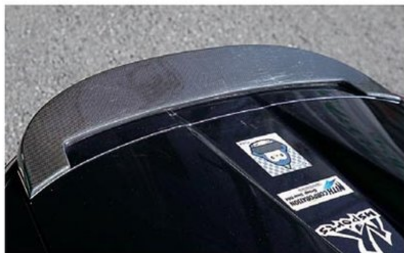
純正アクティブスポイラーよりひと回り大きいサイズというリヤウイング(3万6000円)もカーボン仕様となっている。高速走行時のダウンフォースが増して、安定感のある走りを披露する。
