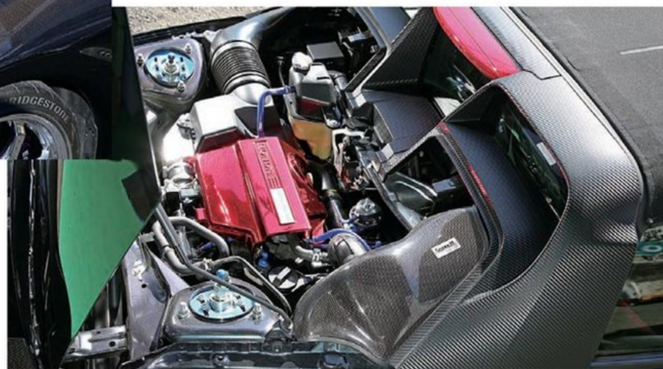
HKS・GT100Rタービンやトラスト・インタークーラーによりパワフルに生まれ変わったエンジン。ECUセッティングはフラッシュエディターで行った。マイルドなパワー特性なので、街乗りメインでもタービン交換をするメリットは大きいという。ちなみにメッキ塗装仕上げのエンジンカバーもオリジナル。新品ベースの加工品でカラーはレッドとブルーを用意。
