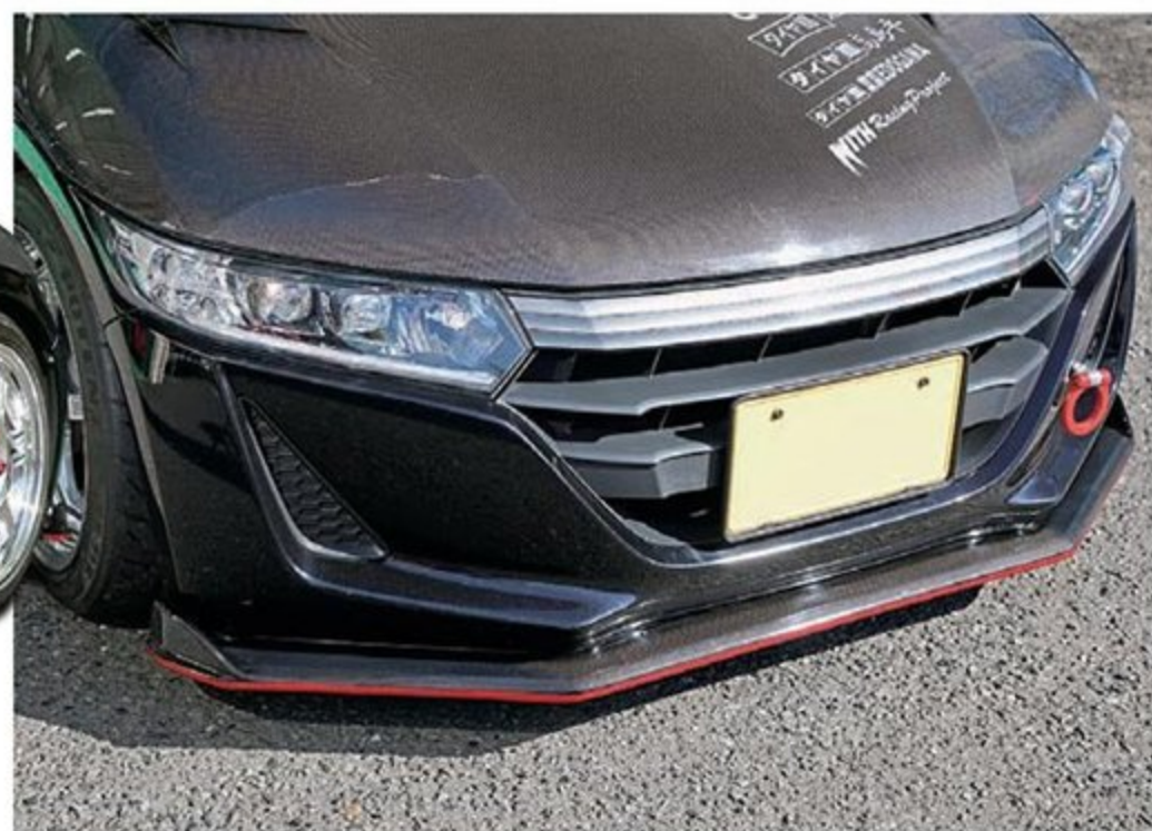
純正バンパーに追加するカーボンのリップスポイラー(5万8000円)は、フロントまわりの接地性を向上させる効果が期待できる。赤いストライプを追加しているのもオシャレ。
