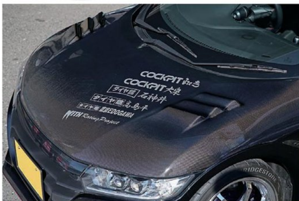
左右にダクトを設けたスタイリッシュなカーボンネット(9万9000円)もオリジナル。雨水の浸入を避けるため製品にはあえてダクト穴は開けていない(別料金で穴開け加工に対応する)。同社のカーボンアイテムはクリア塗装済みとなり耐候性もばっちりだ。
