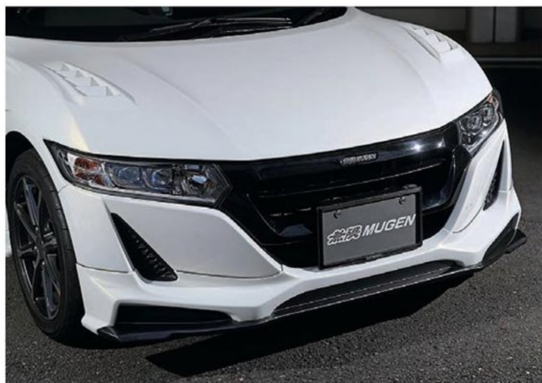
フロントアンダースポイラーは真空成型のPPE製。ワイドに張り出したデザインと、ブラックアウトの処理がスポーティな印象を強める。設定6色×ダークガンメタリック塗装の2トーンカラー仕上げで価格は5万1000円。2ピース構造となっており、バンパー下部に被せて装着。
