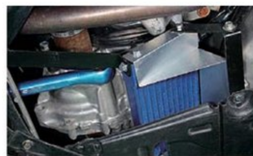
元々油温が厳しいS660だけに、タービン交換車ではオイルクーラーの装着は必須ともいえそう。このデモカーではトラスト製をセットする。その横の青い棒はクスコのピッチングストッパー。シフトがスルスルと入るようになるが、車内に多少の振動が伝わってくる。サーキット向けとのこと。
