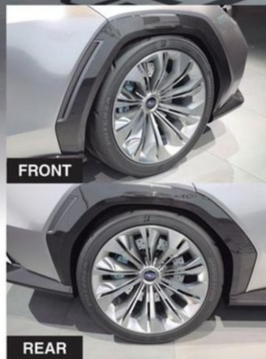
245/40R20サイズのタイヤ&ホイールはショースペシャルである。特徴的なデザインのクラッシングは、視覚的効果だけでなく空力操安にも寄与している機能部品だ。
