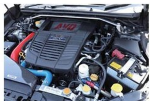
チューニングは吸排気系、冷却系、ボディ剛性、足回りとトータルに実施されている。
