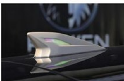
シャークフィンアンテナはプリウスG's用にLEDを埋め込んで点灯するように加工。
