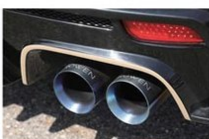
出口がチタンフィニッシュカラーの左右4本出しマフラー(90φ×4)はロエン製。
