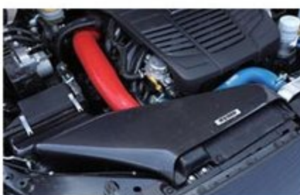
カーボン製のエアインダクションボックスはシムス製。パイピングやホースも交換されている。
