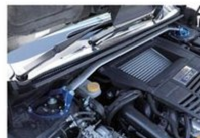
エンジンルームには見た目とフロントの剛性アップに貢献するクスコのタワーバーを装着。
