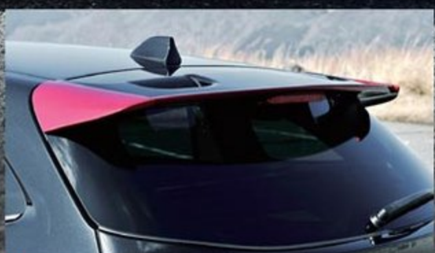
③ リアスポイラー 天面2箇所に穴が空いた、独創的デザインで人気を博す純正交換型のウイング。部分的な塗り分けがオススメ。
