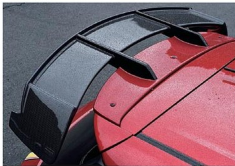
新たに追加されたアイテムがエアロパーツ。複雑な形状を再現したウェットカーボン製リアウイングは、スタイリング強化にも役立つ。
