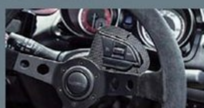
ステアリングは変更可能。遠征時に便利な純正クルーズコントロールのスイッチをカーボンの台座(今村選手の手作り)を介し装着している。
