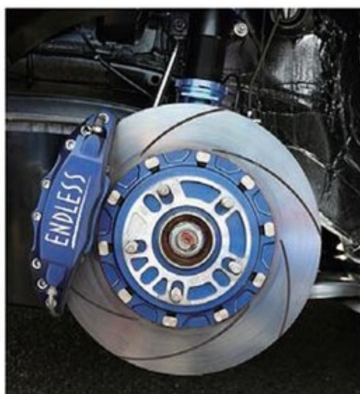
フロントブレーキはエンドレスのブレーキキットを、リヤにはノーマルキャリパーにエンドレスのCC-Rgを組み合わせる。コントロール性を重視した組み合わせだ。
