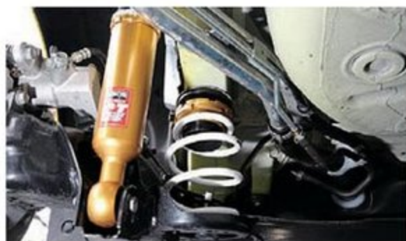
フロントに倒立式を採用するハイパーマックスIVGT。全長調整式で30段の減衰力調整機能も備える。F: 4kg/mm、R: 3kg/mmの設定。
