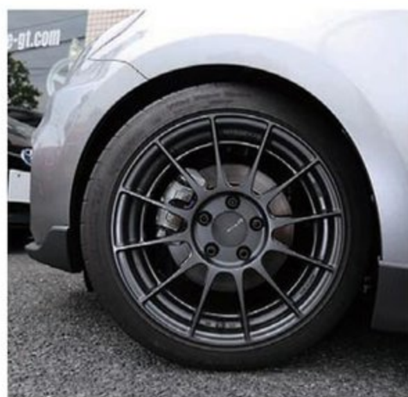
エンケイNT03RR(8J×17+48)にミシュランパイ ロットスポーツ(215/45-17)を組み合わせる。純正より外 径がひとまわり大きくなることで、トルクステアの解消に も繋がる。パッドはエンドレスを使用。フロントがCC-Rg で、リヤはMX72をチョイス。
