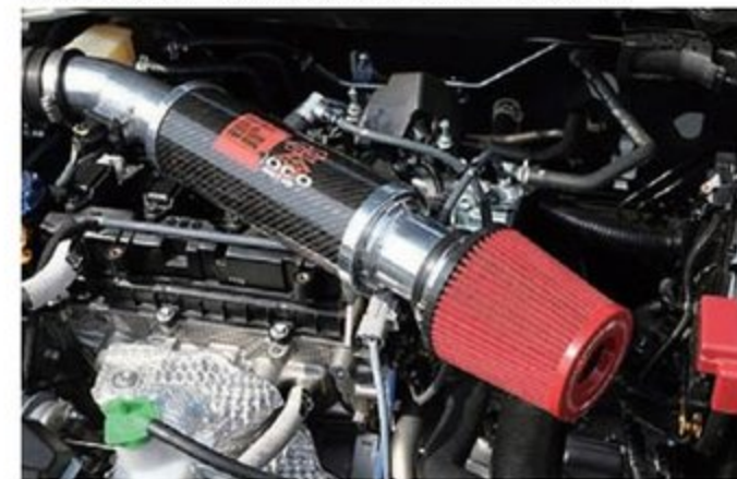
この段階ではタービンもノーマルのまま。1.0kg/cmにブーストアップこそ行なっているが、コンピュータもノーマルのままのため最高出力は150psにとどまっている。
