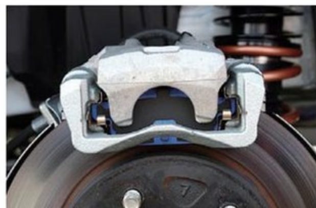
フロントブレーキはエンドレスのブレーキキットを、リヤにはノーマルキャリパーにエンドレスのCC-Rgを組み合わせる。コントロール性を重視した組み合わせだ。
