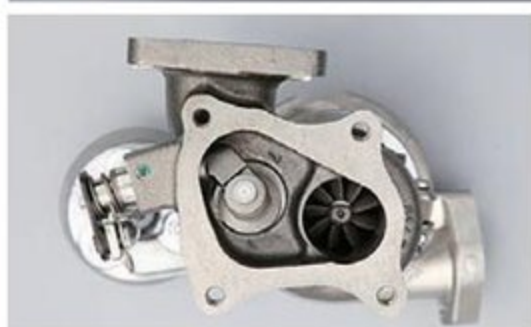
排圧や吸気温度の抑制にも効果的というGTIII-FXタービン。ボン付け可能で、ノーマルECUのままでも8.6psアップを実現する。
