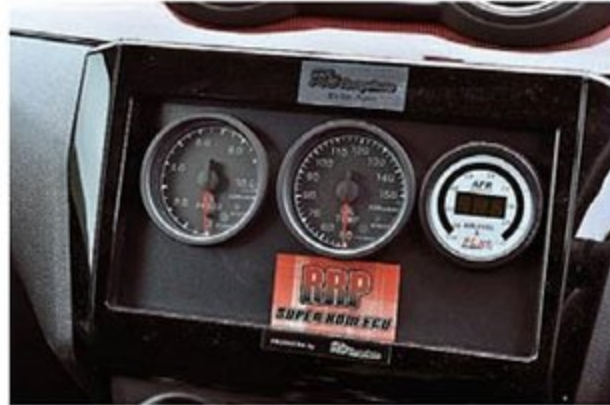
センターコンソール内にはAF計と油温、油圧計を設置。高回転まで多用するため、オイル関連の数値はきっちりモニタリングしている。
