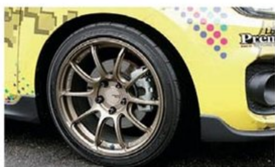
アドバンRZIIにネオバAD08Rを組み合わせる。サイズは前後とも205/45R17。車高はF: -35mm、R: -32mmだ。
