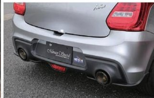
マフラーはフジツボのオーソライズRM+c。そのパ ワーアップ効果は侮れず、特に高回転では10psくら い差があるのではないかと。ちなみに機械式LSDは クスコRSの1.5ウェイをセットする
