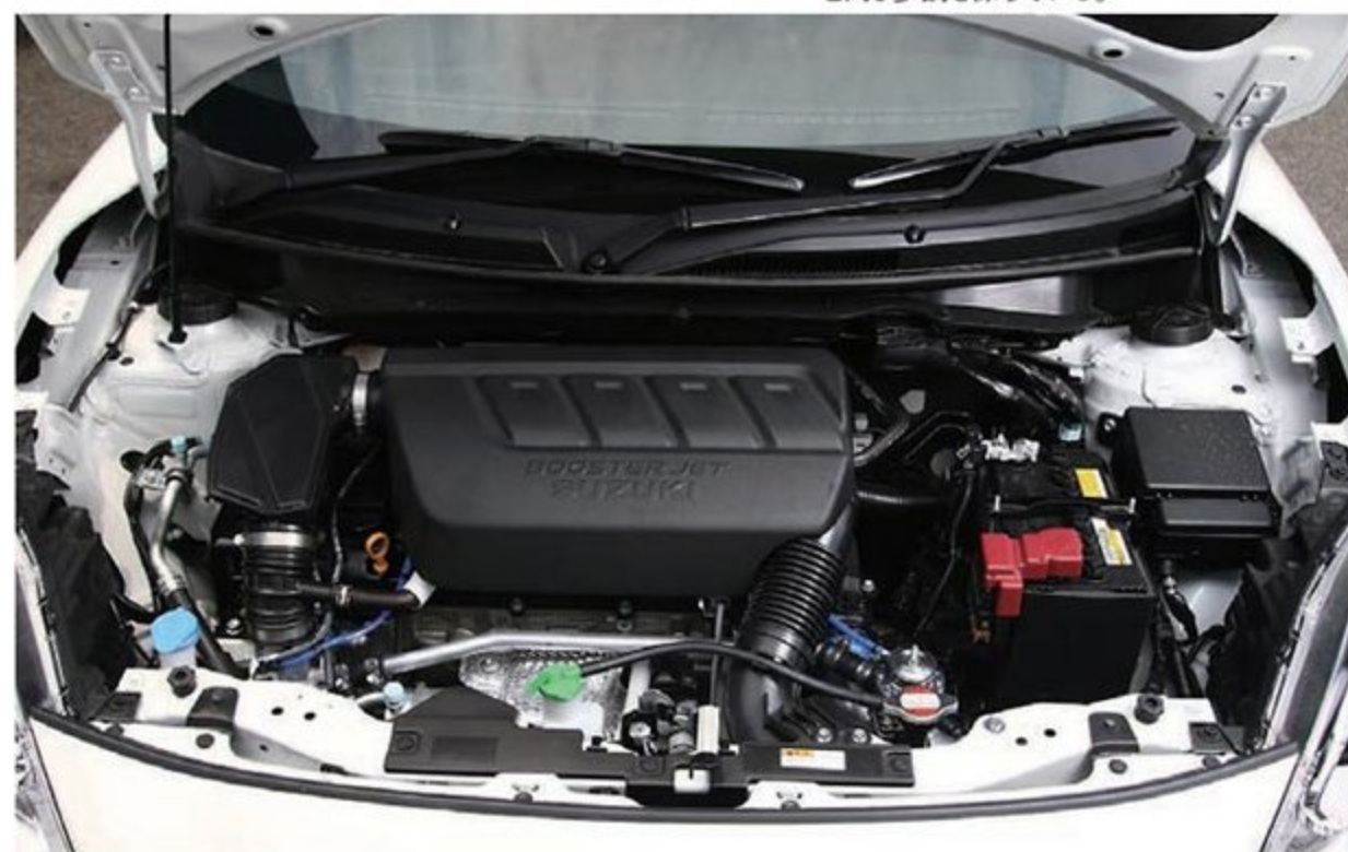
インタークーラーのパイピングはトラストのキットをチョイス。プロ オフバルブ取り付けタイプを選択し、今後のステップアップの 際でも無駄にならないパーツチョイスを基本としている。
