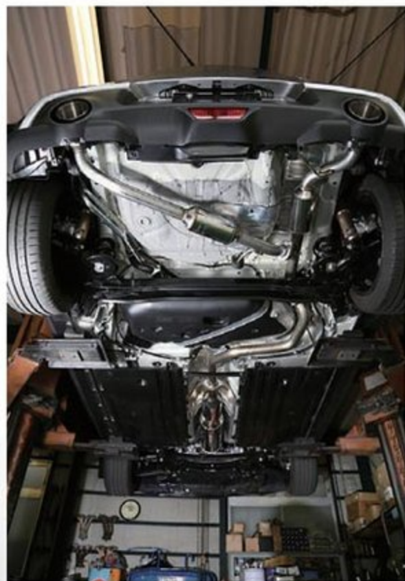
マフラーはフジツボのオーソライズRM+c。そのパ ワーアップ効果は侮れず、特に高回転では10psくら い差があるのではないかと。ちなみに機械式LSDは クスコRSの1.5ウェイをセットする
