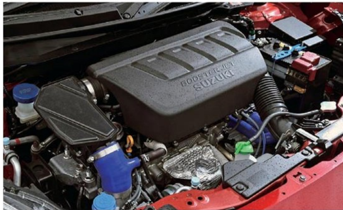
吸気系は純正エアクリナーボックスを利用する純正交換タイプを利用。吸気温度を下げるためにはこの組み合わせがベスト。
