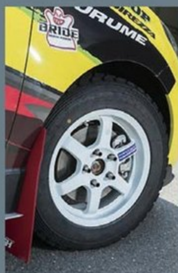
ホイールはレイズTE37。タイヤはダート競技用のダンロップ・ディレッツァ88R。サイズは185/65-15。ブレーキパッドはウインマックスitzz。
