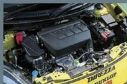
もちろん、エンジンはノーマル。変更が可能な部分はエンジン/ミッションマウント程度。ストラットタワーバーの追加も禁止されている。
