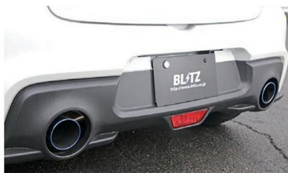
マフラーはスポーティなサウンドを奏でる保安基準対応モデル、ニュルスベックVSRをセット。パイプ径はメイン50φ、テール114.3φ×2。
