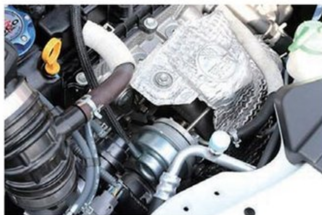
この段階ではタービンもノーマルのまま。1.0kg/cmにブーストアップこそ行なっているが、コンピュータもノーマルのままのため最高出力は150psにとどまっている。
