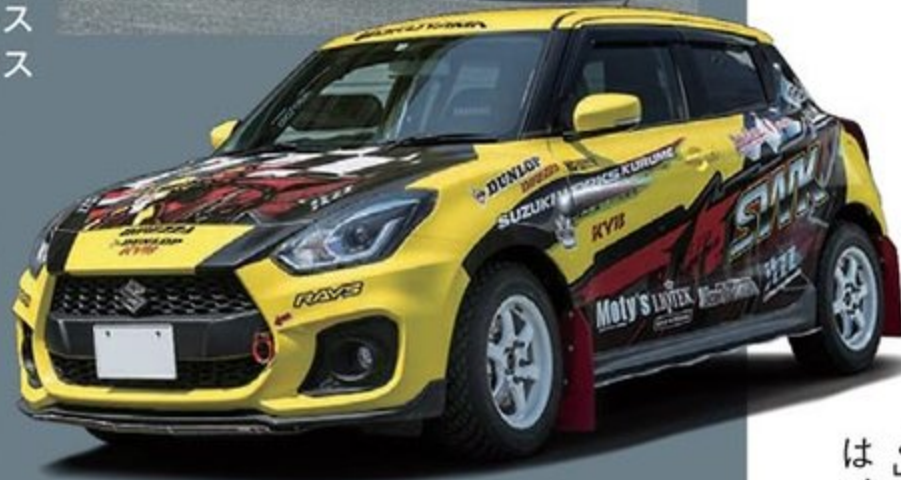
ホイールはレイズTE37。タイヤはダート競技用のダンロップ・ディレッツァ88R。サイズは185/65-15。ブレーキパッドはウインマックスitzz。
