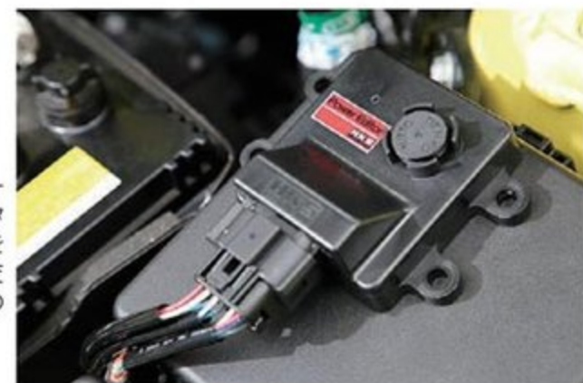
ブーストアップモジュールとなるパワーエディターも開発中。過給圧を高めることでマフラー交換プラス10ps程度の上乗せが期待できる。
