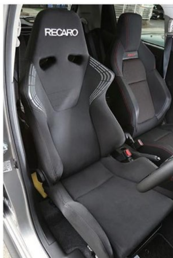
以前はフルバケを使用していたがポジションが下が りすぎて街中での使い勝手がスポイルされたので、リク ライニング可能なレカロSR-6に変更した。これにより ほどよいポジションとなり、ペダルの踏みやすさも向 上したという。
