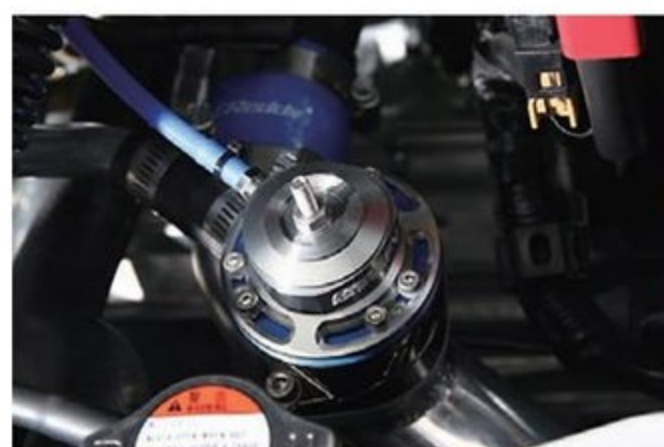
インタークーラーのパイピングはトラストのキットをチョイス。プロ オフバルブ取り付けタイプを選択し、今後のステップアップの 際でも無駄にならないパーツチョイスを基本としている。
