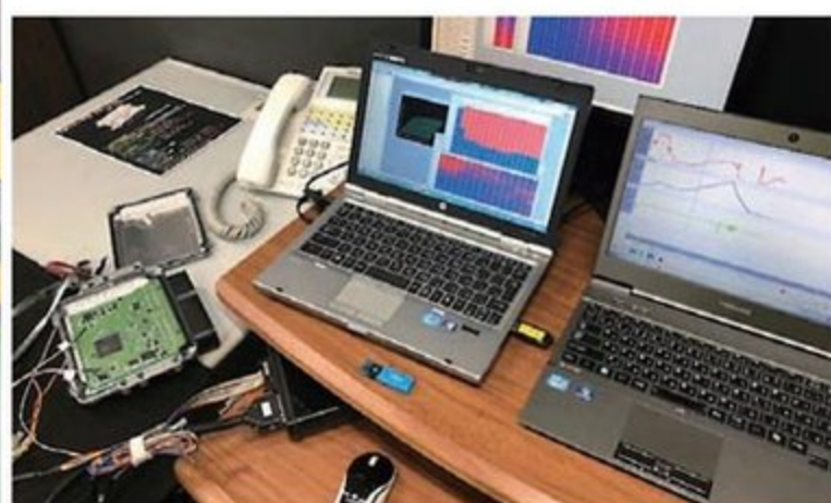
ECUチューニングは超お得意の分野。リミッター制御やクルーズコントロールの設定変更など、独自の味付けが施されたSWKプレミアムスポーツECUも好評。
