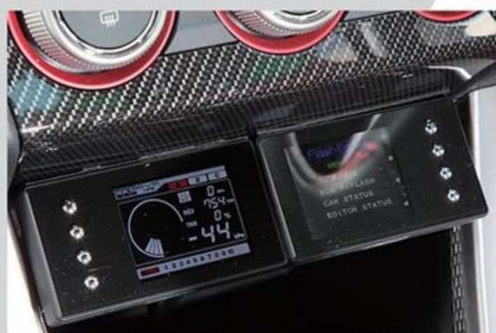
ブースト制御にはHKSのEVCをチョイス。マップ機能を駆使してピークのブースト圧だけでなく、そこまでの過渡特性も見直されている。
