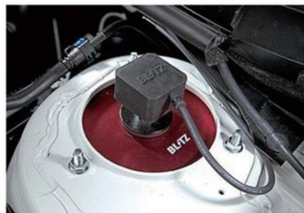
WRX S4用のアッパーマウントは、静音性やしなやかな乗り味を追求して前後とも強化ゴム。WRX STI用はフロントがピロアッパー仕様になっている。写真の減衰力調整ダイヤル上にあるのが、車内から減衰力調整を行うDSCのステッピングモーターだ。
