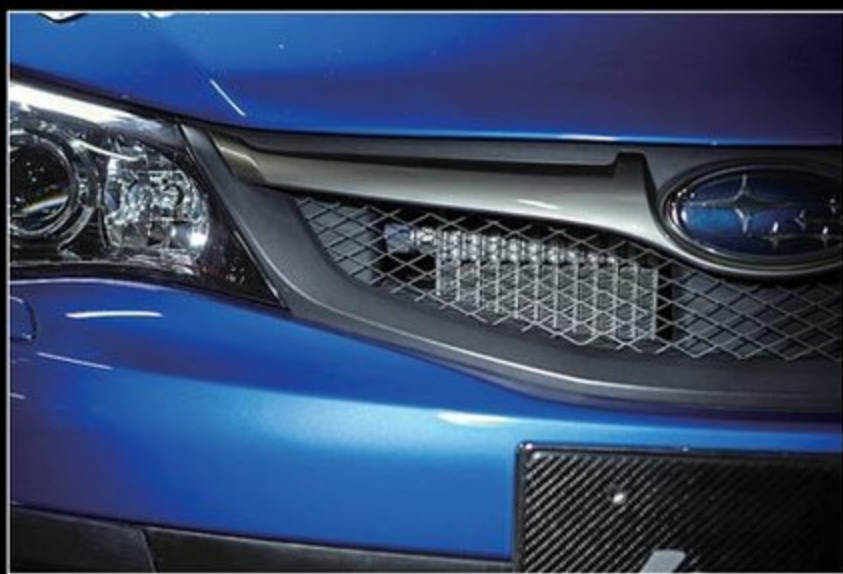
EJ20の耐久性を確保するためには油温の管理が大きなものをいう。油温を適正に保つことによってエンジン内部の保護だけでなく、水温まで下がるといふ。
