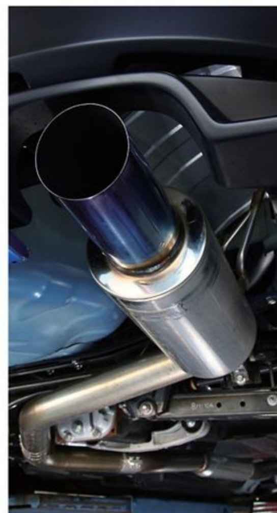
センターパイプとリアの2ピース構造によって純正比52%もの軽量化を達成。軽量だけでなく高回転域のパワーとトルクを引き出す設計は、車検対応ながらも体感レベルでのスペックアップが期待できる。また独自のスリッポン方式を採用するため、従来のフランジモデルよりロードクリアランスが確保できるのも特徴。
