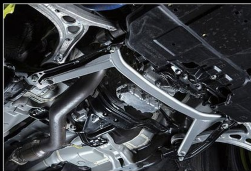
関西サービスでは各モデル用にシャシー補強パーツをラインアップ。基本的にフロア下に装着するタイプが多いが、VABのトランク内に装着するリヤタワーバーはトランクの使い勝手をスポイルしないスグレもの。
