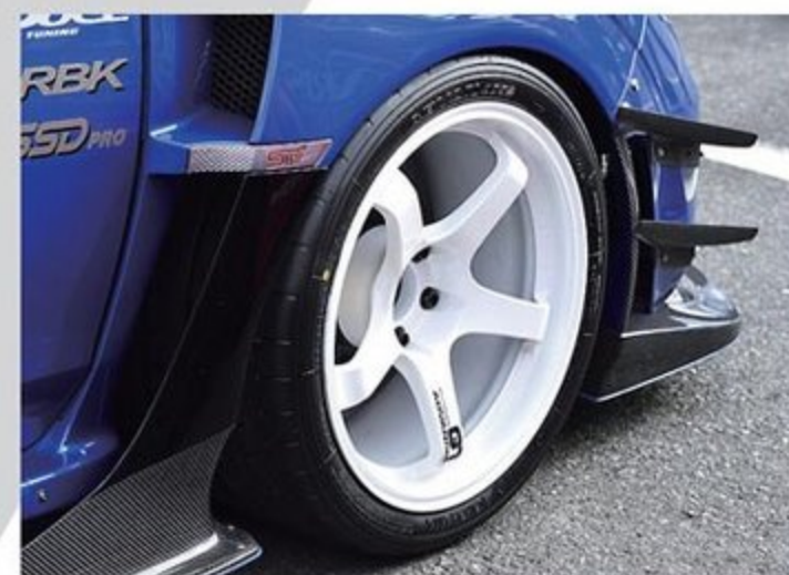
11.0Jx18+15のアドバンレーシングGTに295/35-18のアドバンA052という組み合わせ。この強大なグリップ力もモアパワーを欲しがっているのだ。
