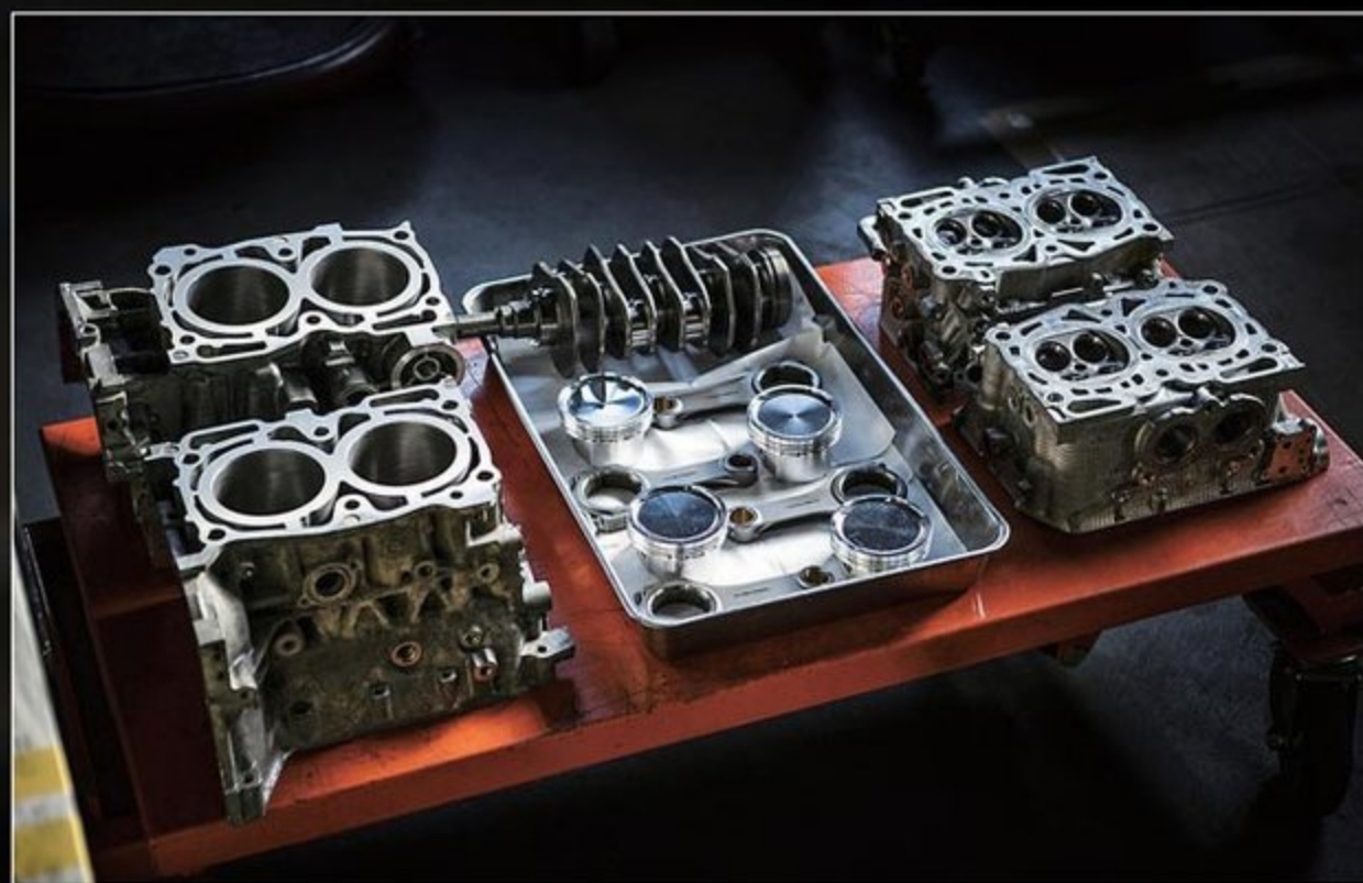
走行距離が多くなっている個体は、オーバーホールを兼ねた2.2ℓへのチューニングというプランもある。完全にブローしてしまうとシリンダー本体やヘッドまわりまで再利用できなくなってしまうので、ある程度の段階までに決心するべき。そのあたりの見極めも含め、関西サービスでは愛車の点検プランなども行っている。
