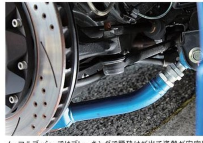
ノーマルブッシュではブレーキングで腰砕けが出て姿勢が安定しなかったが、STI強化ゴムブッシュによって狙い通りのライントレースが可能になった。また、クスコの調整式ピロアームを使ってアライメントを理想値に上げている。
