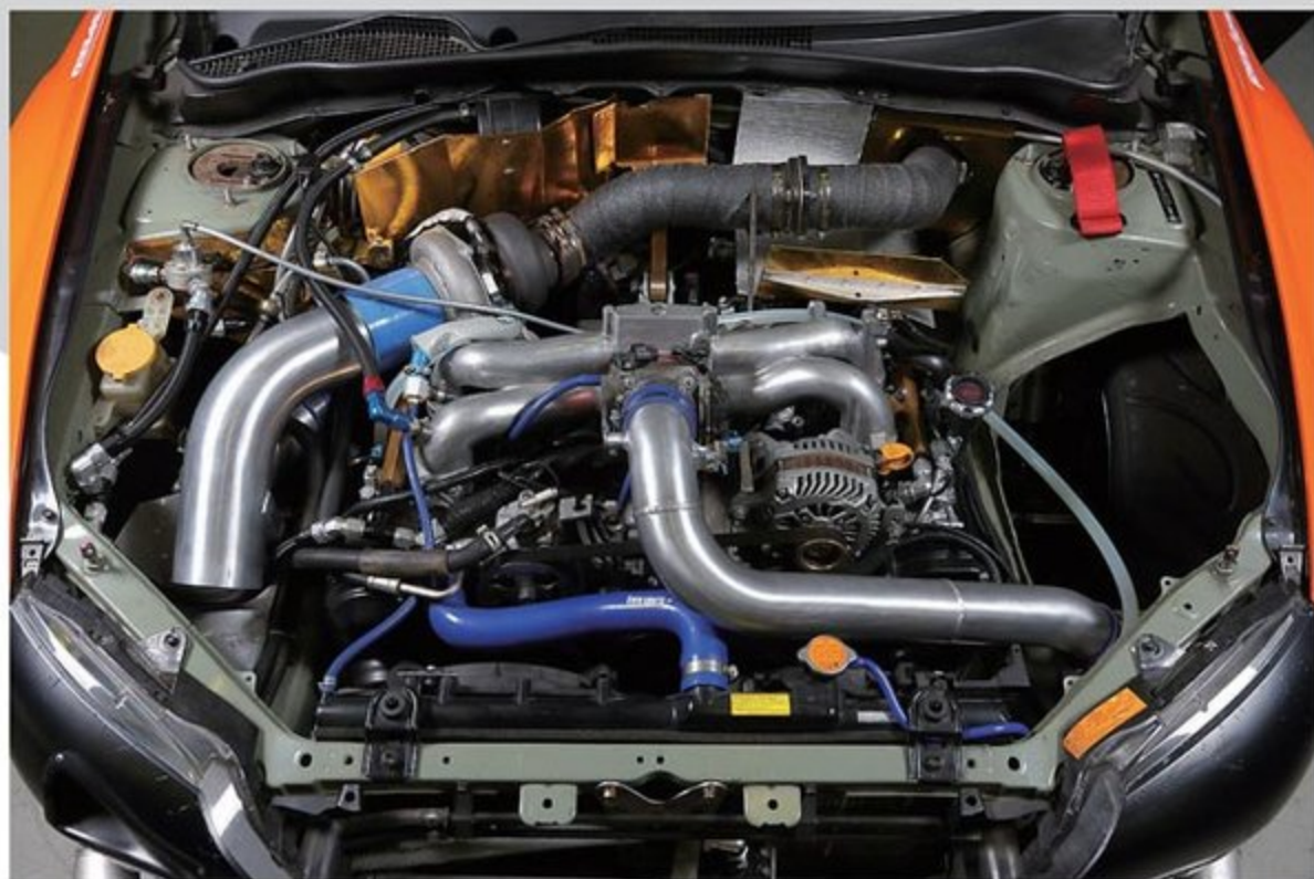
ちょっと長めの眠りから覚めたハイパワーユニット。EJ25改2.8Lエンジンは1度完全にバラしてピストン交換が行われた。実績バツグンの強心臓だ。
