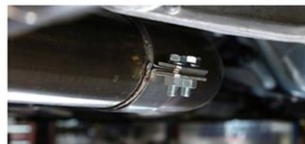
センターパイプとリアの2ピース構造によって純正比52%もの軽量化を達成。軽量だけでなく高回転域のパワーとトルクを引き出す設計は、車検対応ながらも体感レベルでのスペックアップが期待できる。また独自のスリッポン方式を採用するため、従来のフランジモデルよりロードクリアランスが確保できるのも特徴。
