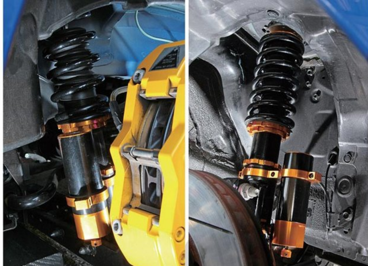
オールラウンドをカバーする高性能&多機能モデルとして展開しているランデューSSD Pro(スーパーストリートダンパープロ)。別体タンクの採用によってオイル容量を大幅に増やしているほか、減衰力を伸縮の独立して調整できるようになっている。
