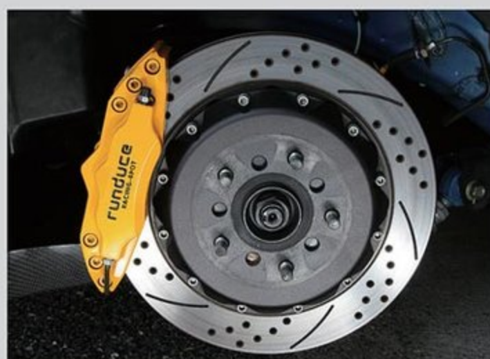
RBK(ランデューブレーキキット)はフロントが8ボット+380φローター、リヤが6ボット+356φローターという組み合わせ。絶対的な制動力はもちろんのこと、高いコントロール性も自慢のシステムだ。
