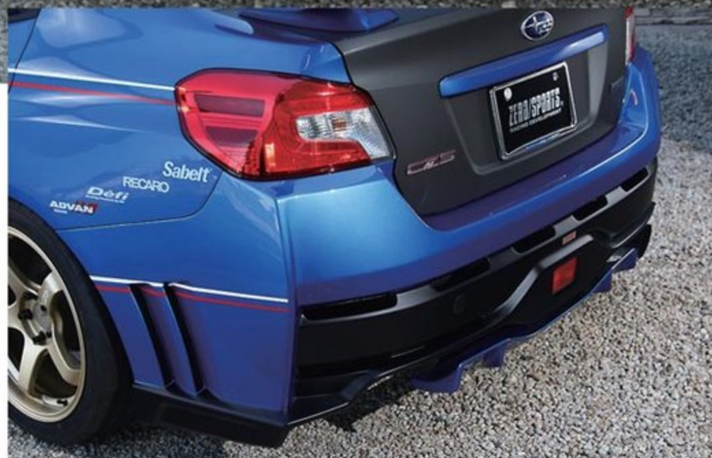
リアバンパーも空力を考慮したスタイリングを優先。特にマフラー周りの熱を逃がしつつ、パシユート効果を低減させるダクトのレイアウトや、可変式のアンダーフラップによってフロア下の空気を引き抜く効果はストリートでも違いが表れる。
