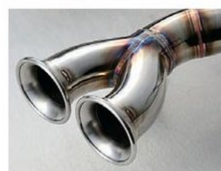
NDロードスターサイレンサーキット(18万4000円)は、純正エキマニ&触媒との組み合わせを前提として開発。メイン54φ→テール50.8φ×2で、オールステンレス製。車検対応となる。
