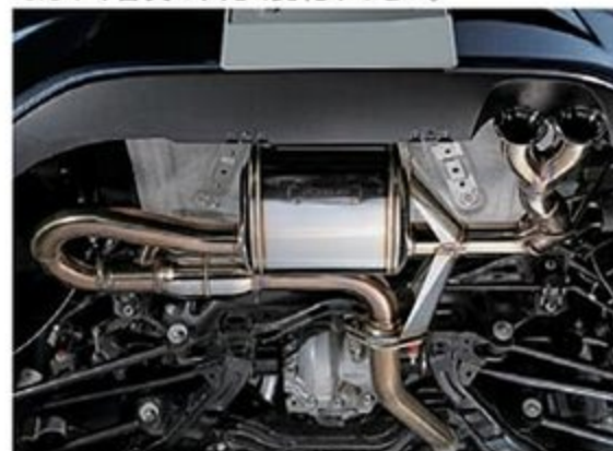
NDロードスターサイレンサーキット(18万4000円)は、純正エキマニ&触媒との組み合わせを前提として開発。メイン54φ→テール50.8φ×2で、オールステンレス製。車検対応となる。
