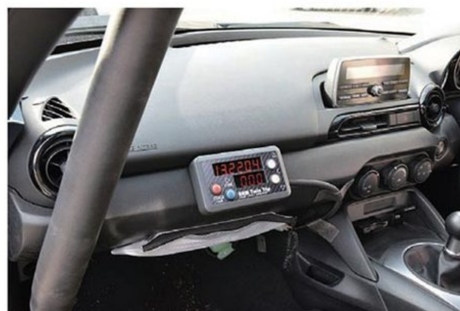
全日本ラリー参戦車両にはコ・ドライバーに現在の走行位置を知らせる意味で重要なラリーコンピュータも装着されていた。
