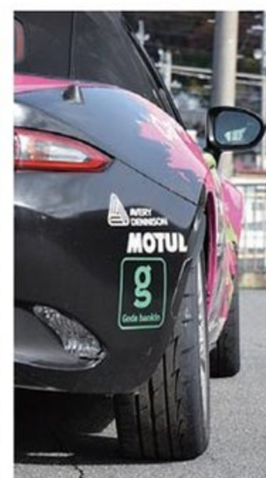
競技ベースのNR-A仕様を使い、社外パーツの使用がほぼ許されないパーティレースのレギュレーションにおいて重要なのがアライメントセッティング。コースによって曲がりやすいセットでコーナースピードを重視するか、最高速の伸びるアライメントにするかに経験が活きるという。
