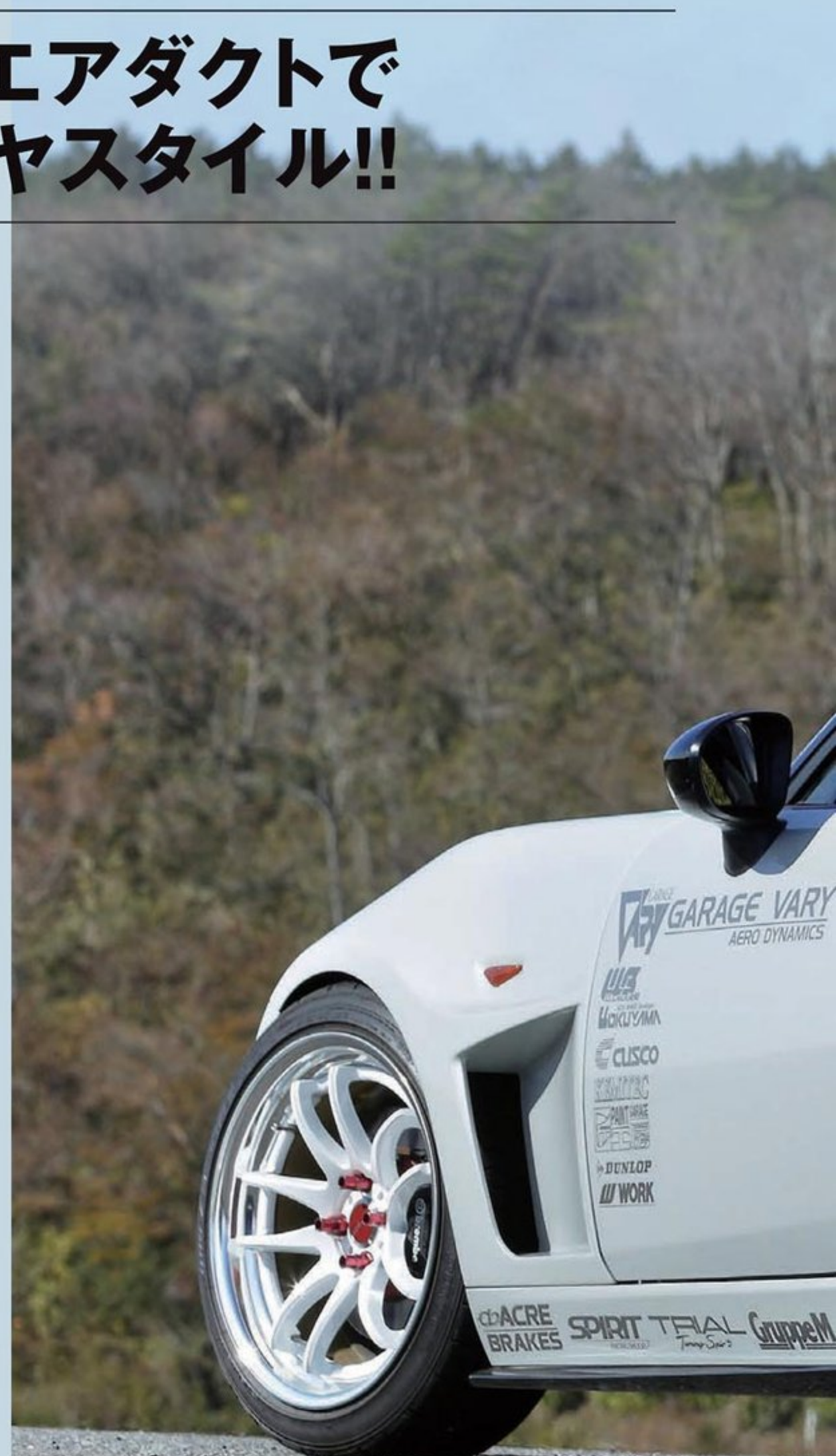
ブレーキまわりの冷却に役立つブレーキダクトスポイラー。走行風をガイドで導くことで、安定した制動性能を確保する。車両に合わせてカットして取り付けする汎用品だ。タイラップやボルトで固定して使用する。FPR製。
