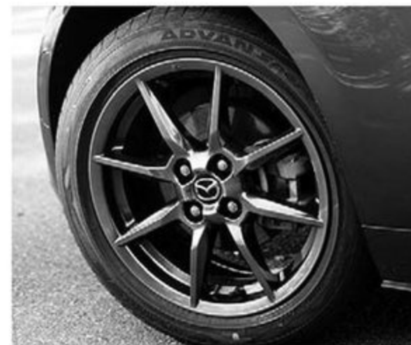
足元を引き締めるためにブラックメタリックに塗られたアルミホイール。タイヤ&ホイールサイズは195/50R16&6.5Jx16を履く。余談だがボディ同色の電動リモコン式ドアミラーも最良である。
