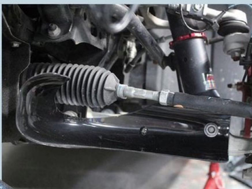
ブレーキまわりの冷却に役立つブレーキダクトスポイラー。走行風をガイドで導くことで、安定した制動性能を確保する。車両に合わせてカットして取り付けする汎用品だ。タイラップやボルトで固定して使用する。FPR製。
