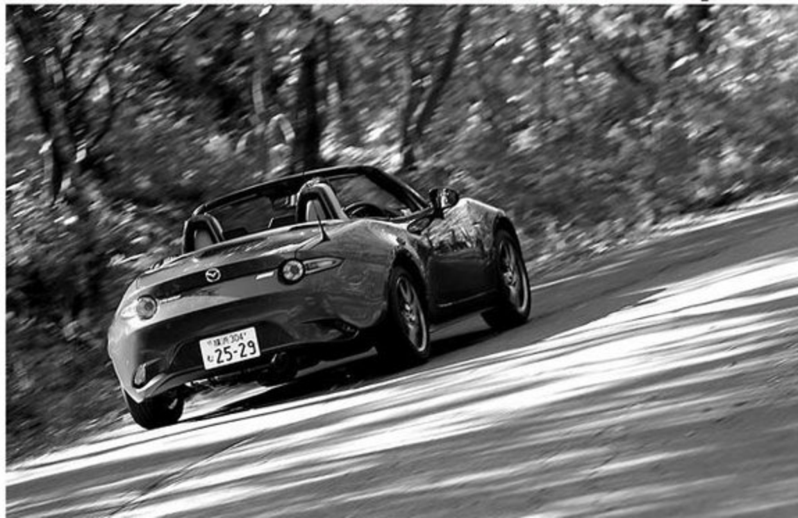
足元を引き締めるためにブラックメタリックに塗られたアルミホイール。タイヤ&ホイールサイズは195/50R16&6.5Jx16を履く。余談だがボディ同色の電動リモコン式ドアミラーも最良である。
