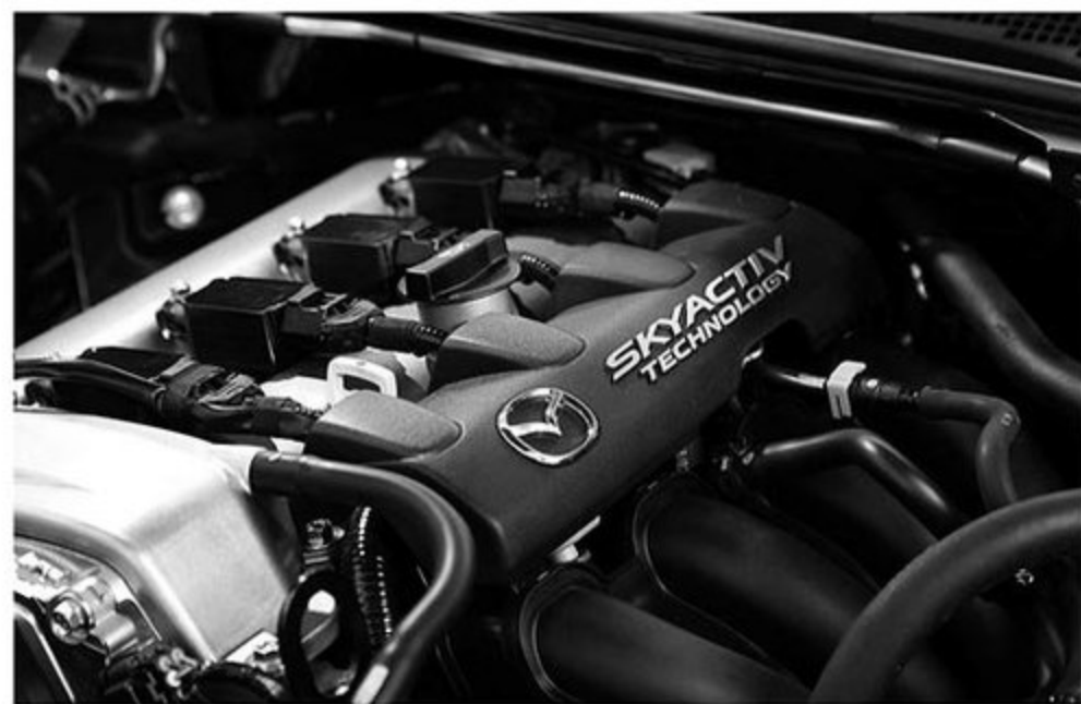
低速から滑らかなフィーリングを演出した1.5ℓ直4DOHC16バルブユニット。ちなみにテスト車両はシフトフィールのダイレクト感と優れた燃費性能を実現させた専用の6速ATを搭載。
