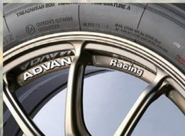
RZの進化バージョンとして誕生したRZⅡ。ツインスポークの広角側には両スポーク側面を継ぎ目なくくった“アドバンスド・サイドカット”を採用。狭角側は段付き形状で強度を確保しつつ細いスポークデザインを実現している。
