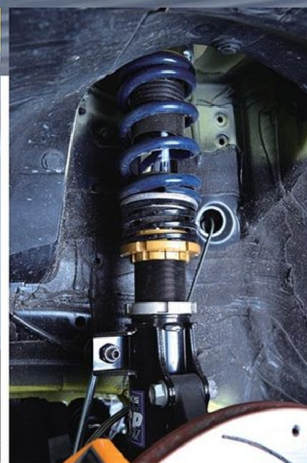
車高調整式サスペンションは、HKS ハイパーマックス MAX IV SPだが、標準のスプリングレートがフロント8kg/mm、リヤ5kg/mmに対し、フロント12kg/mm、リヤ9kg/mmとハードなものに変更している。
