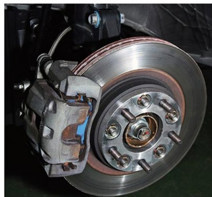
ピストン位置の関係で、サーキット走行ではフェードしやすい純正キヤリバー。現状はエンドレスMX72パッドとアクレブレーキホースで強化しているが、それでも筑波2周が限界なので、高性能キヤリバーに変更予定。
