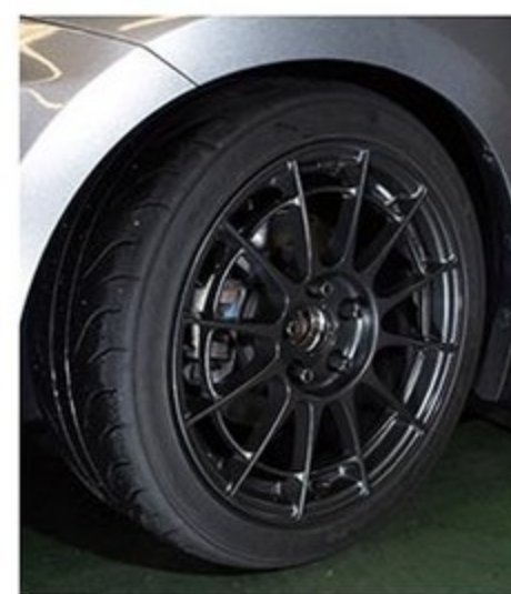
エンケイNT03RR(8J×17+48)に組み合わせているタイヤはグッドイヤーのイーグルRS(F235/40 R215/45)。ストリートラジアル装着でも筑波サーキットを1分6秒台の快足ぶりを誇る。
