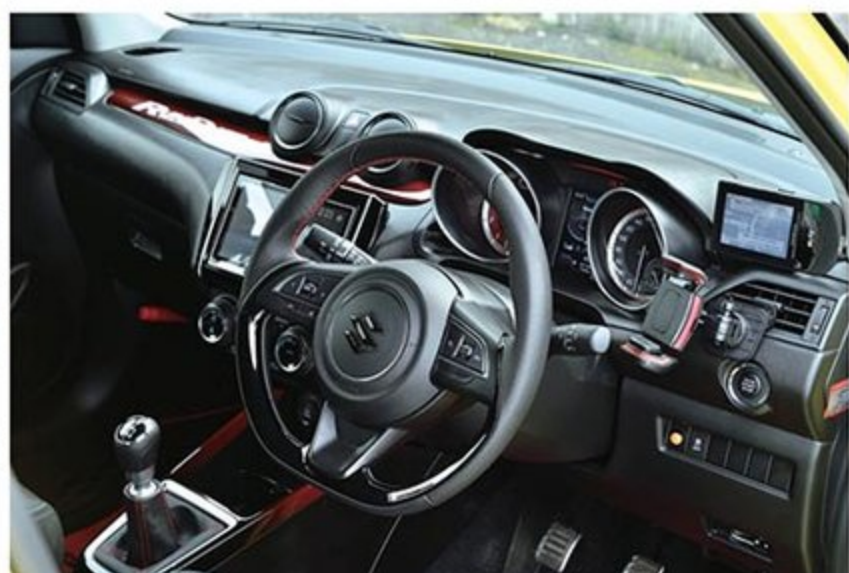
スマホホルダーが通勤快速をうかがわせるインテリア。エンジン情報はブリッツの多機能モニターで把握。シートは運転席がフルバケのレカロRS-G、助手席がリクライニングタイプのSR-7Fとなっている。
