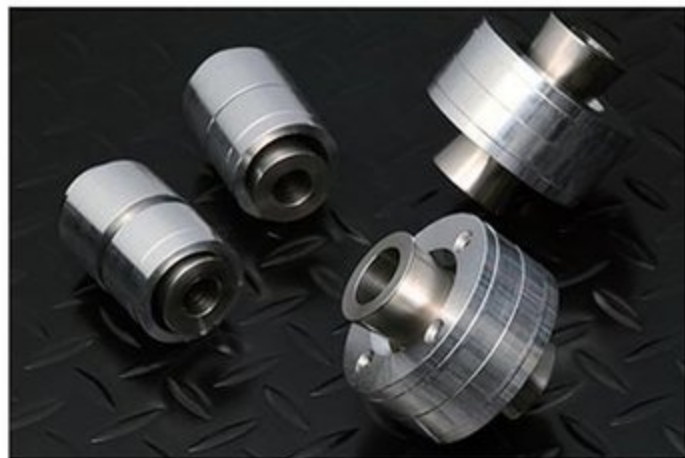
フロントアームのピコボールブッシュは1台分4個セットで4万5000円。ゴムブッシュによるヨレやトラクションの逃げがなくなり、ソリッドな挙動が可能になる。異音など不快なデメリットも心配ないお勧めパーツだ。
