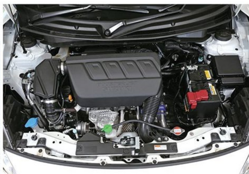
ノーマル然としたエンジンルームながら、約190psをマーク。HKS製のGTIII-FXタービンがパワーアップのキモだ。
