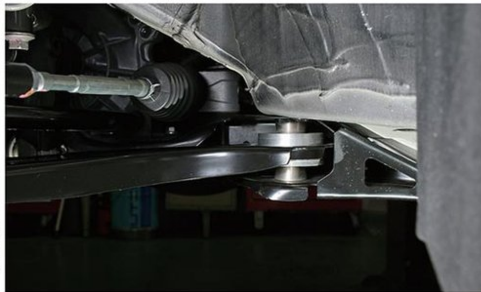
フロントアームのピコボールブッシュは1台分4個セットで4万5000円。ゴムブッシュによるヨレやトラクションの逃げがなくなり、ソリッドな挙動が可能になる。異音など不快なデメリットも心配ないお勧めパーツだ。
