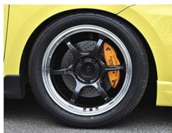
ホイール&タイヤは、アドバンRG-D2にハイグリップラジアルのA052という組み合わせ。リヤの215/45R17(7.5J+48)に対し、フロントが245/40R17(8J+37)というかなり攻めたセッティングになっている。
