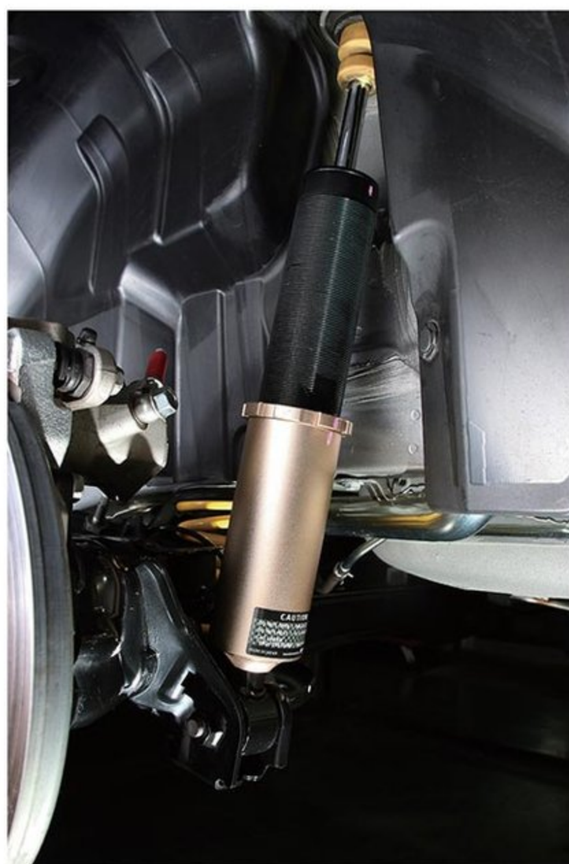
ストリートからサーキットまで、市村代表自らが徹底的に走り込んで開発したオリジナル車高調整式サスペンションキットMONACOは25万8000円から。標準設定のスプリングレートはフロント8kg/mm、リヤ6kg/mm。デモ車はリヤを8kg/mmにレートアップ。フラットでニュートラルな乗り味がこだわりの。
