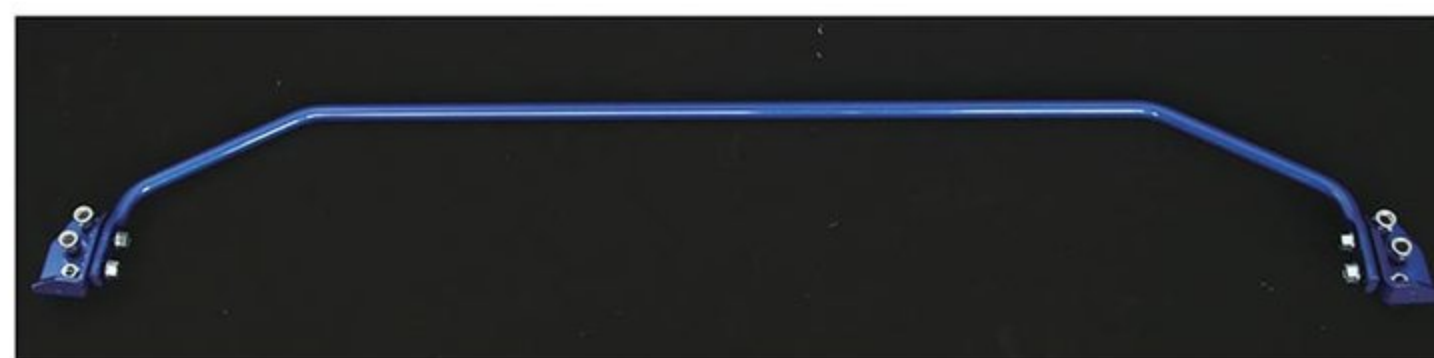
車現在開発中となるトーションビームスタビライザーは、左右リアタイヤの接地性をさらに高め、素直なハンドリングをサポートするアイテム。コーナリングでの不安定さを解消してくれる。
