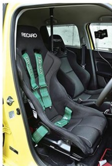
スマホホルダーが通勤快速をうかがわせるインテリア。エンジン情報はブリッツの多機能モニターで把握。シートは運転席がフルバケのレカロRS-G、助手席がリクライニングタイプのSR-7Fとなっている。
