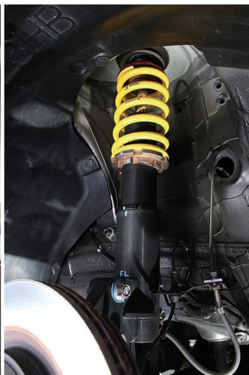
ストリートからサーキットまで、市村代表自らが徹底的に走り込んで開発したオリジナル車高調整式サスペンションキットMONACOは25万8000円から。標準設定のスプリングレートはフロント8kg/mm、リヤ6kg/mm。デモ車はリヤを8kg/mmにレートアップ。フラットでニュートラルな乗り味がこだわりの。
