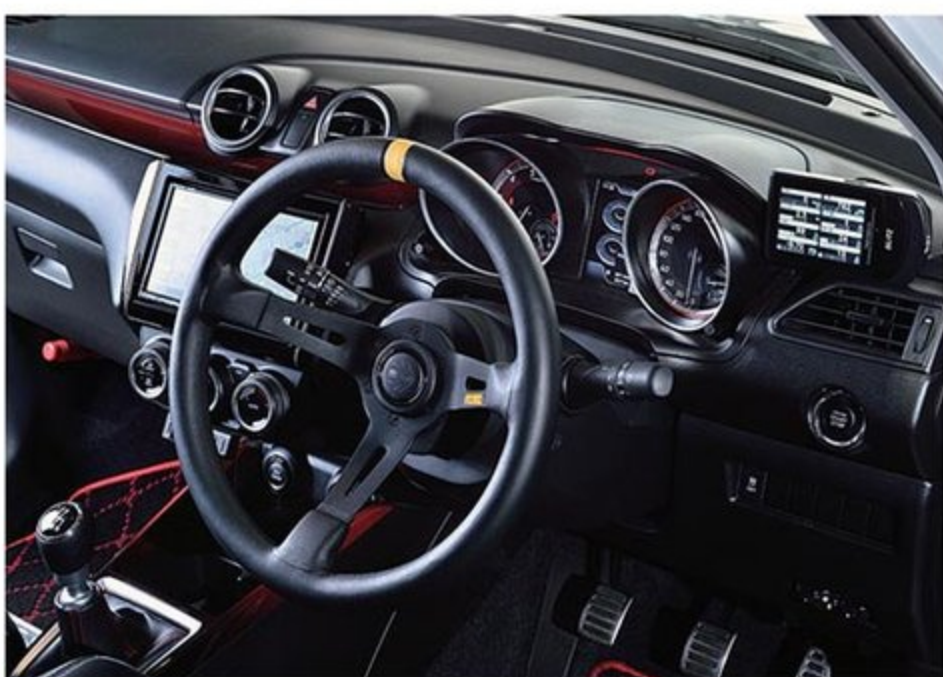
ディープコーンタイプのステアリングが走りを感じさせるデモ車のインテリア。メーター横にはOBDII接続の多機能モニター「タッチブレイン」を装着している。
