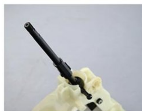
シフトワークを確実に行うレーシングクイックシフトも現在開発中。シフトストロークが大幅に短くなるため、スポーツ走行時などは操作性が大幅に向上されること間違いなしだ。
