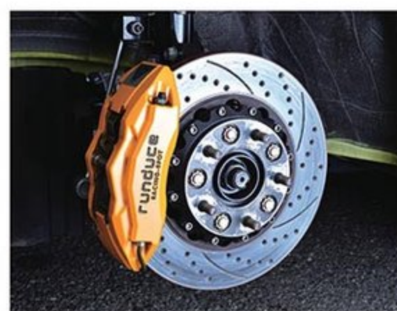
フロントブレーキはランデウスオリジナルの6ポットキャリパーと304φドリルドスリットローターに変更して、強力なストップングパワーを獲得。リヤブレーキはパッドをZONE製に変更している。
