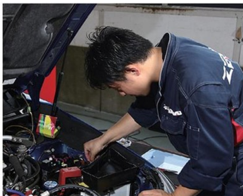
E型をベースとするゼロスポーツのデモカーにはスターターキットを装着。エンジンルーム内のヒューズボックスにある指定のヒューズを交換していくことから作業スタート。
