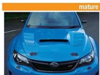
クーリングボンネット
