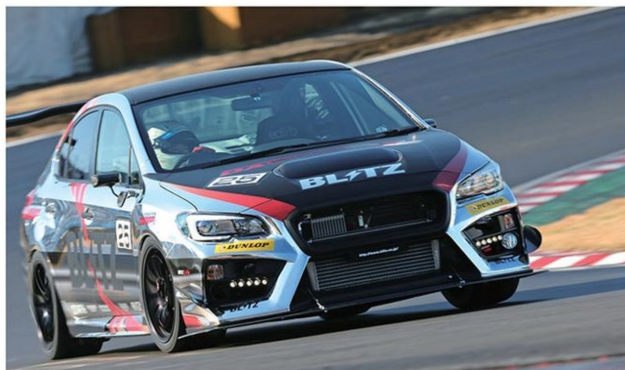
サスペンションは伸縮それぞれ独立した減衰力調整機構を持つZZ-RダンパースペックCを装着するなど、現在のパーツラインアップの多くはこのマシンによって得たノウハウが活かされているのだ。
