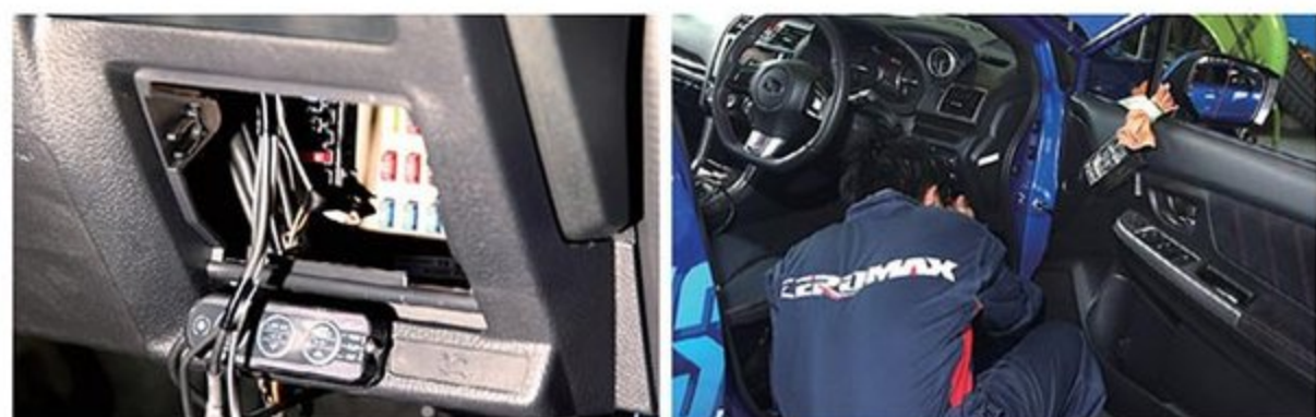
ステアリングコラム下にあるインテリアヒューズボックス内の指定ヒューズも交換。スターターキットはエンジン、インテリアと合わせて17個のヒューズを交換するというメニューだ。
