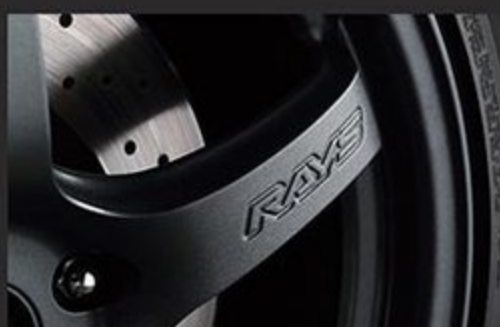
スポーツホイールにとって伝統的なデザインのひとつである5本スポークを採用している57CRだが、最新マシンへ対応するために各部はしっかりと剛性確保がなされている。また、そのスポークはWRX STIの大型キャリパーにも余裕で対応できるものとなっているのだ。
