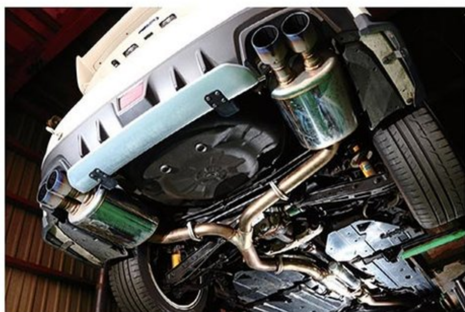
HKSスポーツキャタライザーにスーパーターボマフラーを組み合わせた定番仕様。吸気はノーマル。これにECU書き換えが、もっとも費用対効果が高いチューニングで、オススメだという。
