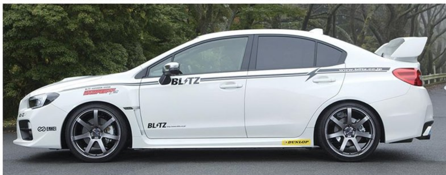
取材車両のWRX S4は19インチ(235/35R19)のディレッツァDZ102を装着。基準の車高ダウン量はフロントが25mm、リヤが20mmとなっている。アイサイトの動作確認も行い、問題なく作動したそうだが、作動に関してはユーザーの自己責任となる。
