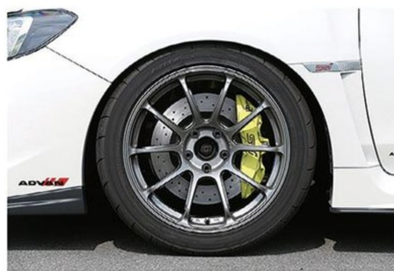
細身のスポークデザインがVABにマッチするホイールはアドバンRZ-F2で、前後とも9.5J×18 +44を装着。タイヤは前後とも255/40サイズのアドバンネオバだ。
