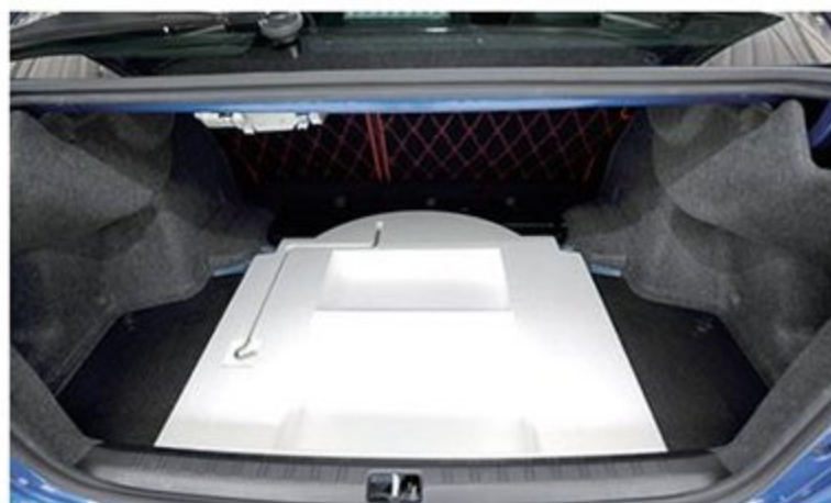
VABのラゲージアンダートレイには収納スペースがほとんどないため、収納スペースを確保した発泡ポリエチレン製のアンダートレイを製作。ノーマル同様、ジャッキハンドル収納スペースも用意されている。
