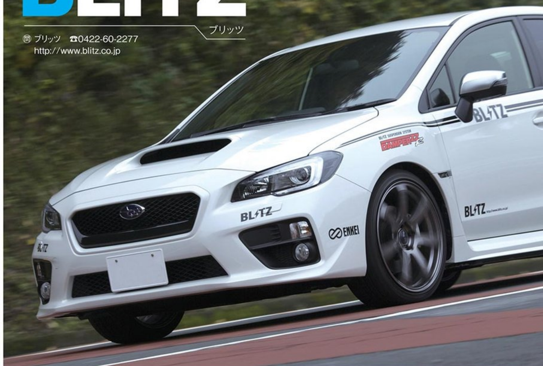
取材車両のWRX S4は19インチ(235/35R19)のディレッツァDZ102を装着。基準の車高ダウン量はフロントが25mm、リヤが20mmとなっている。アイサイトの動作確認も行い、問題なく作動したそうだが、作動に関してはユーザーの自己責任となる。
