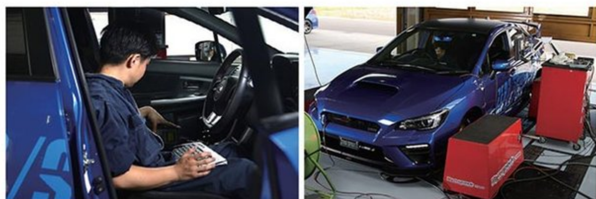
17個のヒューズを交換したらパワーチェックをはじめ、実走行によるフィーリングチェックを行う。デモカーのパワーは公表されていないため、その差は明らかにされていないが、パワー／レスポンスともにその効果は確認できたというのがゼロマックスの評価だ。
