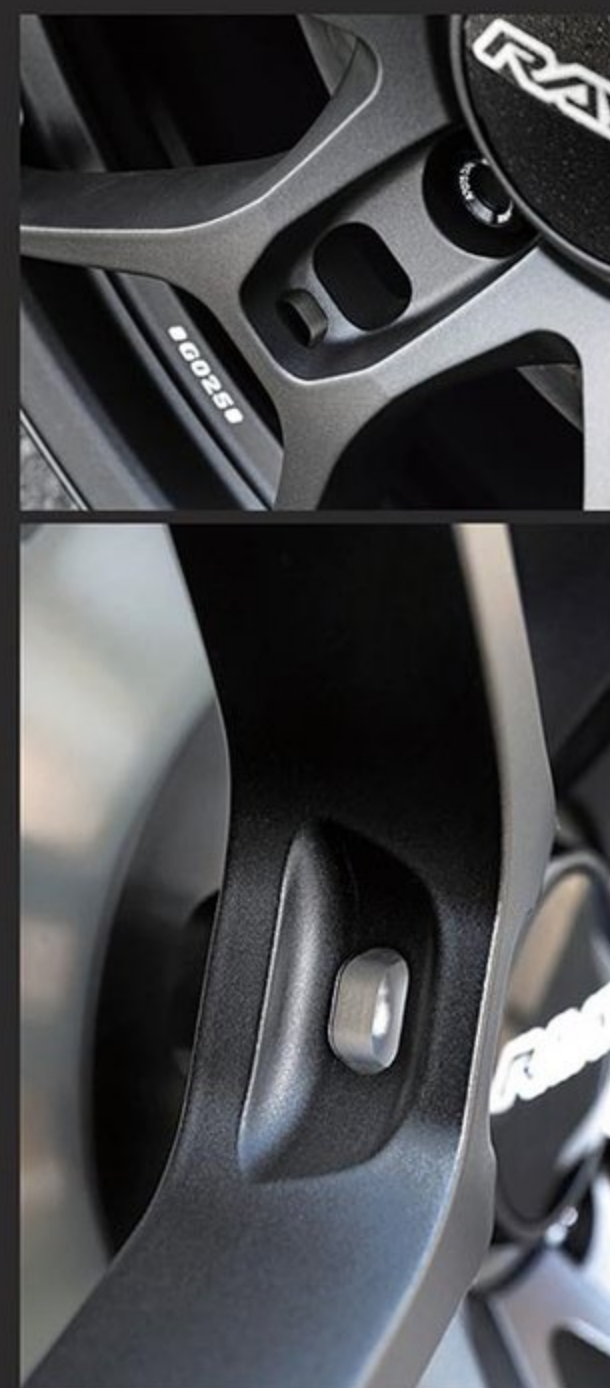
G025はナットホールへスポークを配置。センターへと鋭角に落とし込んで立体感を演出。加工が難しいスポーク分岐部に最新加工技術による駄肉処理をプラス。その形状も剛性確保のカギとなっている。
