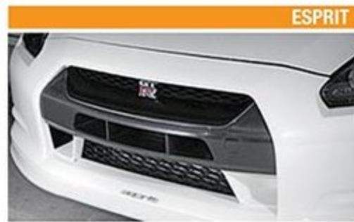
ESPRIT I/C用パネルダクト
