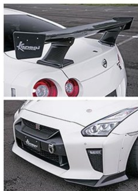
ストリートでの使い勝手を損ねずに空力性能を向上させられるカーボンリップスポイラーや、手軽にレーシーさをアピールできるカーボングリルをセット。専用設計のカーボンGTウイングもオリジナル。強力なダウンフォースを発揮する。
