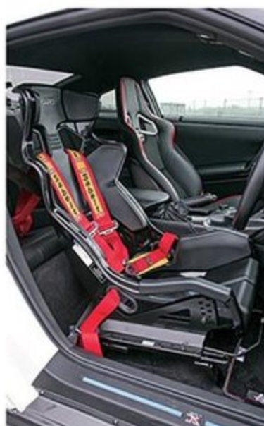
シートはレカロで、運転席は新作フルバケのRMS、助手席はSP-Xをセットする。身体をしっかりとサポートするのでドライビングに集中できるし、長距離ドライブでも疲れにくい。
