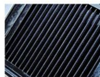
R35の優れたエアダクト&クリーナーボックスを利用する純正交換タイプ。交換作業は左右のエアクリーナーボックスのロックレバーを外して中身を入れ替えるだけなので、装着に際して加工などは一切必要ない。
