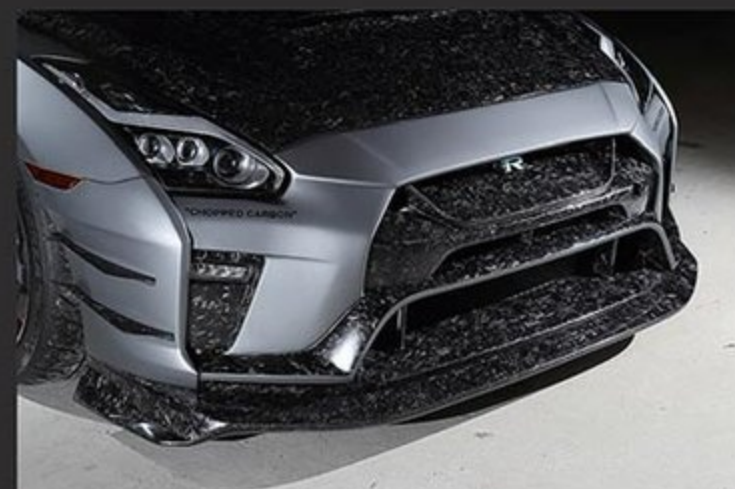
MY17純正バンパーのベースラインを生かしつつ、ボトム部のポリウムアップで迫力を獲得したフロントバンパー。クーリングパネルも装着して機能性も両立。前期、中期型にも装着可能だ。
