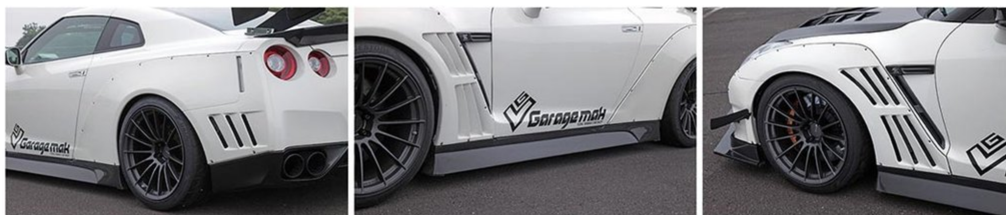
張り付けタイプフェンダーがスバルタンなワイドボディキット(60万円)は、フロント片側35mm、リヤ片側45mmワイドの設定。サイドステップ(カーボン16万円)はローダウン感を強調するスカート形状を採用している。
