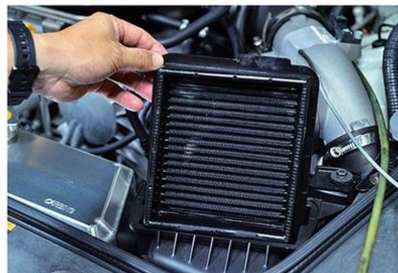
R35の優れたエアダクト&クリーナーボックスを利用する純正交換タイプ。交換作業は左右のエアクリーナーボックスのロックレバーを外して中身を入れ替えるだけなので、装着に際して加工などは一切必要ない。
