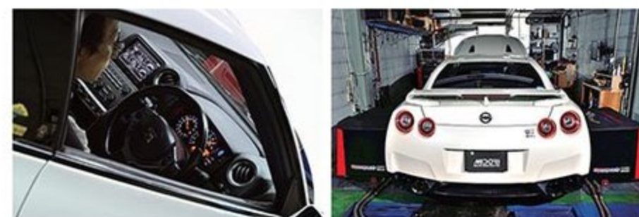
緑整備センターのご協力により精密なデータ採りが可能なダイノバックを使ってテスト。複数回テストした結果ノーマルに比べて大幅に吸入空気量が増大し、それに反応して燃料が多く噴射されていることが確認できた。
