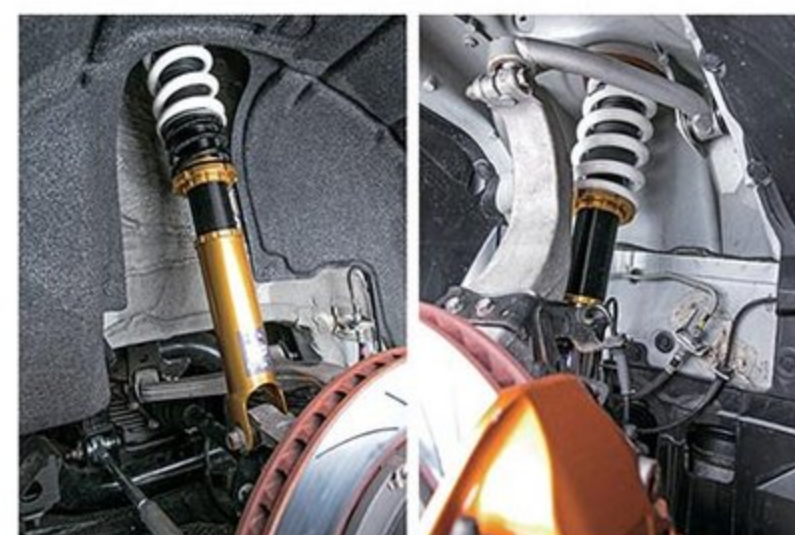
HKSハイパーマックスIVSP車高調にF22kg/mm、R16kg/mmのスプリングをセット。調整式のショートアッパーリンク&リヤサーキットリンクを組み込み、キャンバーはF4度20分、R2度40分ほどに設定。
