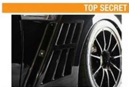
フェンダーダクト
