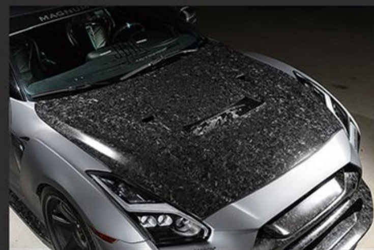
大理石のようなチョップドカーボンの特徴が際立つクーリングボンネット。ダクト類は完全車種別設定で、VR38エンジンと補器類の位置に合わせて最大の効果が得られるデザインとなっている。
