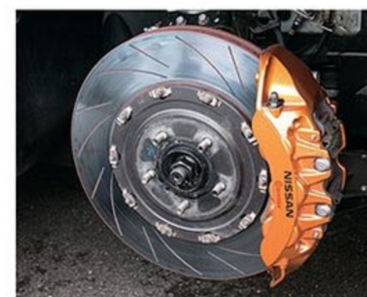
スリット入りのブレーキローターは純正サイズ。パッドはプロジェクトμのレーシングN+。クーリングエアガイドにより走行風を当てること、ブレーキ温度の上昇を抑制。安定した制動性能を発揮する。
