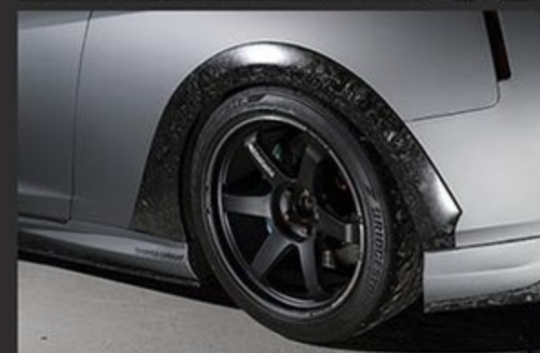
フロントフェンダーは片側25mmのワイド設定。リアフェンダーはトリムを追加。撮影車装着のホイールはレイズTE37ウルトラトラックエディションII(FR11J×20)で、タイヤは前後285サイズのRE-71Rだ。
