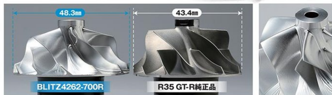
コンプレッサーブレード・サイズ比較
