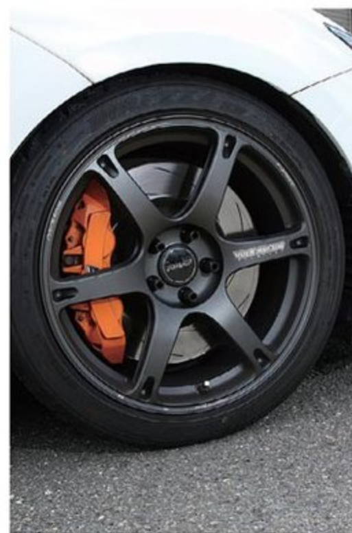
ホイールは19インチのレイズTE037(フロント9.5J+45、リヤ10.5J+35)で、タイヤはダンロップディレッツァZⅢ(フロント245/40、リヤ275/35)の組み合わせ。
