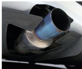
排気系にはKテックのエキマニにTOD Aのダンパーマフラーを組み合わせて鉄板、高回転まで気持ちよく回すために排気環境を整えること、重量の軽減を考えたコーディネートだ。
