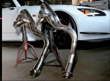
エキマニはチタンとステンダの2タイプを用意。どちらも4.2-1レイアウトの高効率タイプだが重量はチタンモデルが2.0kg、ステンモデルが4.70kgと大きく異なる。また、サウンドもチタンのほうが甲高い音色を奏でる。
