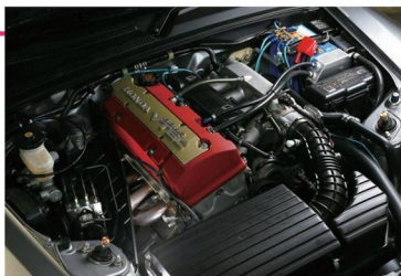
エンジン本体はノーマルのままながら、吸排気チューンとオートガレージMオリジナルのコンピュータセッティングで260psまでパワーアップされているという。セッティングのノウハウやデータも豊富だ。
