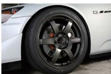
走りのポテンシャルを引き出すワイドキャリパーは標準だが、S2000の2020mmホイールと取り換えたためにローローターとキャリパー、フェンダーを削りすまして、9.5J×18+63のボルクレーシングTE37サーガ+265サイズのA052をマシニングした。
