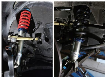
風波サーキットを走っているサーキットマシンには、オリジナルダンパーを元にしたエナペタルダンパーをセッティング。もちろん減衰力固定でシリコン減衰液を充填し、リアは別タンクを組み合わせることで目一杯ストロークが使えるようにセッティングされている。
