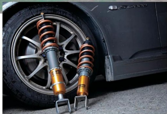
S2000チューニングを長年行ってきたイーグルショップ浦和のノウハウが詰まったオーリンズベースのオリジナルサスペンション「オーリンズ ES-URAWA ROADTRACK KIT」。価格は1台分で22万8800円(税別)、新品純正アッパーマウント付きキットは25万6800円となる。
