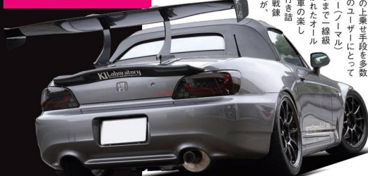
風洞実験のデータをもとに、リアのダウンフォースを高め、十分なフロントリブとサイドウイング、GTウイング、ジョメトリ最適化やソフトワークと併せて、S2000のポテンシャルを余すことなくトラクションへと変えていく注目の空力チューンだ。
