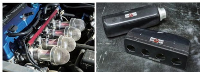
シャープなレスポンスが存分に体感できる、オリジナルのスポーツインジェクションシステム。制振は専用のフルコンで行われ、イモビライザーやエアコンなど実用面への影響も皆無。車検にも対応している。撮影車両はネット付きのファンネル仕様となっているが、貨物の混入を防ぐための専用のインテークボックスも設定されている(別売)。
