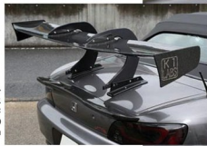
風洞実験のデータをもとに、リアのダウンフォースを高め、十分なフロントリブとサイドウイング、GTウイング、ジョメトリ最適化やソフトワークと併せて、S2000のポテンシャルを余すことなくトラクションへと変えていく注目の空力チューンだ。
