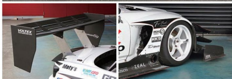
強力なダウンフォースを発生させるエアロパーツはポルテックス製のスペシャル。タイヤの接地圧や前後バランス、各ファクターのチューニングまで考慮し設計された、究極の高機能チューニングパーツだ。
