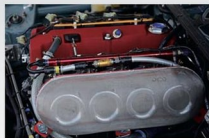
ASMのパワーユニットは一貫して戸田レーシングの手に なるコンプリート。排気量だけをとっても2.2L仕様から2.4L 仕様へ、こまかな制御系なども常に進化を続けてきた。「強 力なパワーユニットは我々の活動の中で絶対に欠かすこと ができない。大切な武器のひとつ」と金山さんは語る。
