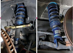
サスペンションはオリジナルスプリングで作ったエナメルベースのダンパーに、ハイコクのスプリングを組み合わせた。現状では前後18kg/mmだが、ステージによってスプリングは変更している。
