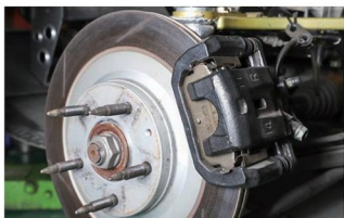
オリジナルパーツとして販売しているRX-8リヤキャリパー移植ブラケット、リヤブレーキからの熱によってリヤハブベアリングのライフが短くなってしまふことを防ぐ。
