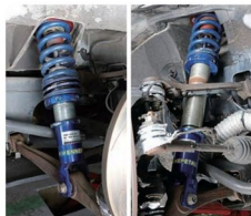
デモカーにはWAKIオリジナルのエアベラムアブソーバーを装着。テグナルサービス・ワキが足まわりのセッティングを進める場合、ある程度まずは実際にクルマの動きをみなぎらめしていくのだから、またハンドリングに大きく影響するLSDはATSカーボンがチョイス。
