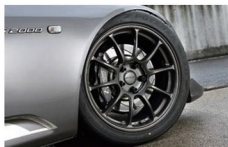
サーキットへウエイトを置くならフロントタイヤのキャパが高まる前後265サイズでもいいが、オールラウンドを掲げるためにストリートでの扱いやすさへとこだわ、フロント245サイズとリア265サイズをチョイスした。
