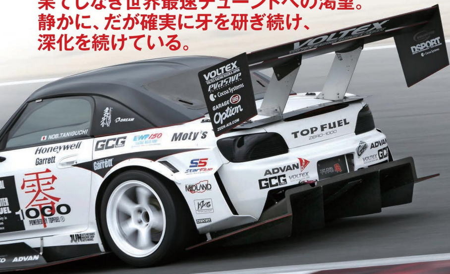
強力なダウンフォースを発生させるエアロパーツはポルテックス製のスペシャル。タイヤの接地圧や前後バランス、各ファクターのチューニングまで考慮し設計された、究極の高機能チューニングパーツだ。
