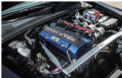
24の排気量はそのままに、前通ハイコンプレッションや重量バランス取りなど、細みまで精度が高められF20エンジン。M&MではAP1の2.2リッター化やAP2の2.4リッター化など、豊富なアップグレードメニューを揃えている。
