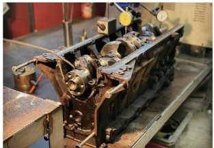
RB30ベースのチューニングエンジンも製作。ただ組み込んでだけでなく、ブロック内壁などの精密加工にも長年のノウハウが活かされる。
