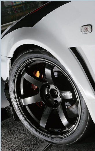
力点分岐に集める伝統の6本スポークはそのままだ。スポーツホイールへ要求される要素をすべて向上させたTE37SAGA。軽装を始めたTE37のイメージカラーといえるブラックアルミ、質感の高い機能美が楽しめるタイヤモッドダークガンメタのほか、オリジナルティを引き出すサポートするオプションカラーも全13色を用意する。
