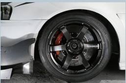
エンジンのポテンシャルやグリッドレベルの高まりとともに、ブレーキシステムも進化している。撮影したBNR34はR35キャリパーと380φローターをマッチングしていたが、390φまで許容する別体系形状としたTE37 SAGAをグリッドアンチ不安は一切ない。
