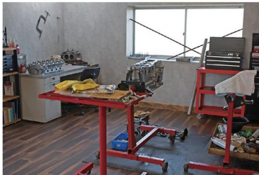
整理整頓が行き届いたクリーンなエンジン組立室は、18℃～22℃に保たれている。ここで meticulous に組んだエンジンは500馬力以上にも及ぶ。
