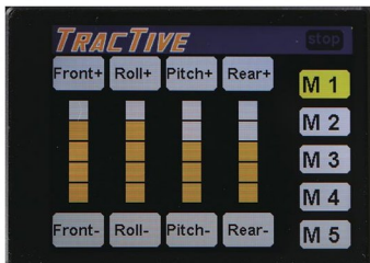
ACEのセッティングは基本として前後減衰力に対し、ピッチ（前後方向）とロール（左右方向）の入力に対する補正を加えるというものが、ピッチとロールの細かな組み合わせにより、より制御も可能になるというわけだ。
