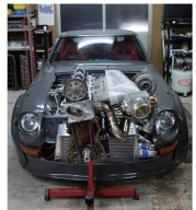
RBエンジンだけでなくL型も越前さんが好きなエンジンだと言う。こちらのS30Z12B改3.187K 267インターボ仕様。最大フットペダル24kg/odの設定で700psオーバーだ。
