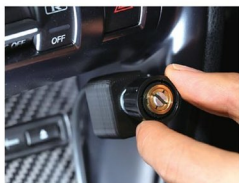
走行中のタッチパネル操作は危険なので、リモートコントロールボタンも標準で付属。コントローラのノブ回転とタッチ操作の組み合わせで、セッティングやメモリーデータの取り替えと各操作が可能。
