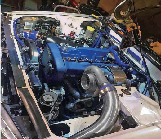
海外からのオーダーの場合、状況次第では現地まで赴付に行くことも、これは米国サウスカロライナまで遠征し輸入してきたRB26、HK5の86.5 ccのストリートファイター2.65は仕立て、実名「ワウ」のコンロッドとニートンパワースタエンジニアリングのフルカウタークラングをチョイス。タービはT88-340Kで、ブース圧2.2kg/cm 2 で900psと154馬力だ。
