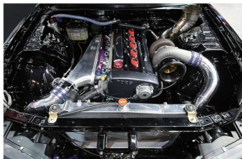
かつてOPT誌が企画した0-300km/hチャレンジで、17秒64を記録したBCNR33デモカー「T-002」。これを現代へと継いだ新生バージョンにも2.8Lのコンプリートエンジンが搭載された。組み合わせているタービンはHKSのGT10-50で、1000psiオーバーを駆込んだスプレッドとなる。
