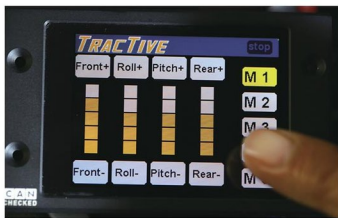
コントローラディスプレイは名刺くらいのサイズ。視認性に優れたタッチパネル式のカラー液晶採用で操作性に優れた。メモリー機能も装備で、シチュエーションや走行コースに合わせた5タイプのセッティングが可能。
