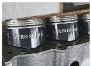
RB30ベースのチューニングエンジンも製作。ただ組み込んでだけでなく、ブロック内壁などの精密加工にも長年のノウハウが活かされる。
