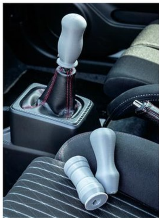
SWKではこの春、新たに3Dプリンターを導入。写真はテスト用に制作したシフトレバー（装着車両はHA36Sアルトワークス）。今後はこのような小物アイテムの充実化も進みそうだ。
