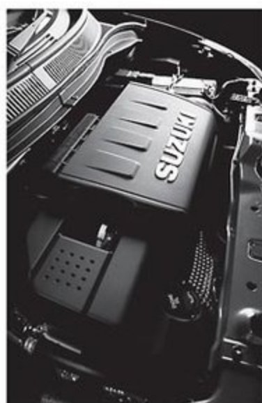
高強度の鍛造ピストンやアルミ製インテークマニホールドなどを採用した1.6直4エンジンを搭載。ピストンリングジェットの採用や水冷式オイルクーラーを装備。
