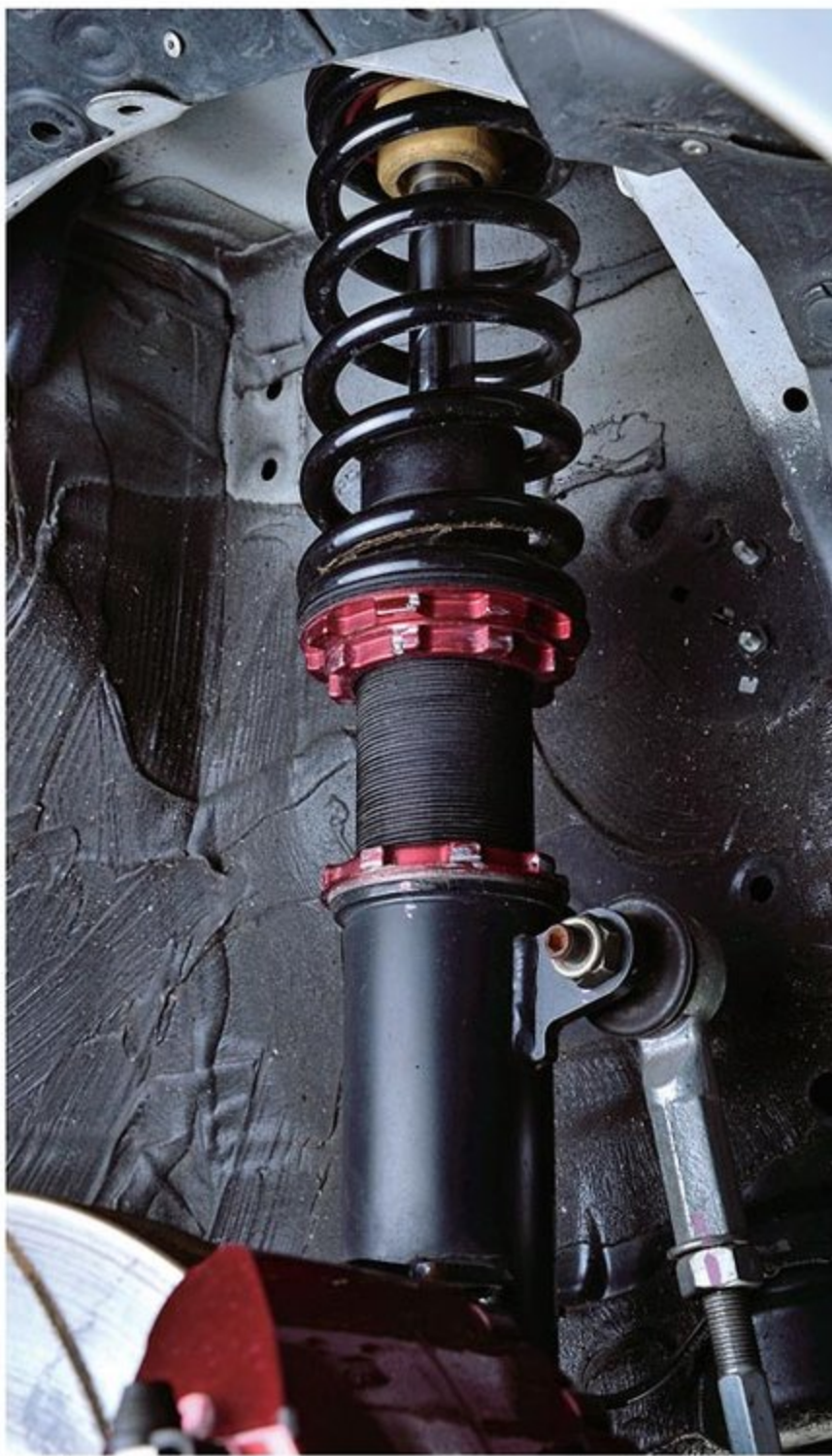
全長調整式サスペンションと電子制御式の減衰力機能を組み合わせた新世代の車高調キット「ダンパーZZ-RスペックDSC PLUS」。バネレートはF：5kg/mm、R：3kg/mmと柔らかめの設定。コントローラーやステッピングモーターなど取り付けに必要なモノはすべて同梱する。価格は21万円。
