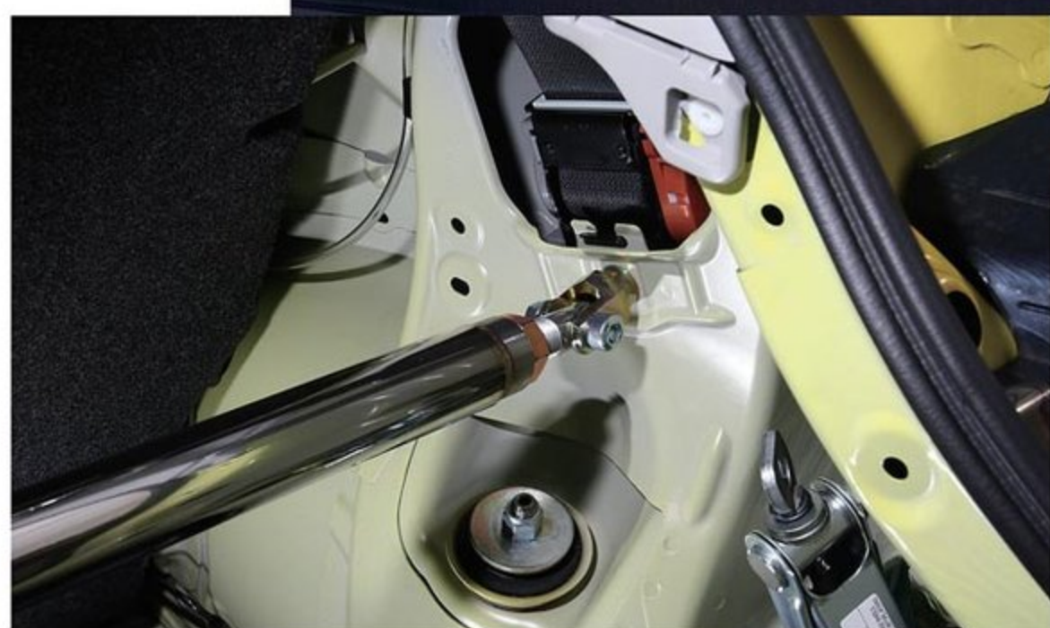
クロスバー取り付け部は車体にあらかじめ備わるアンカーポイントなどを利用するため、新たに穴あけ加工などは一切必要ない。
