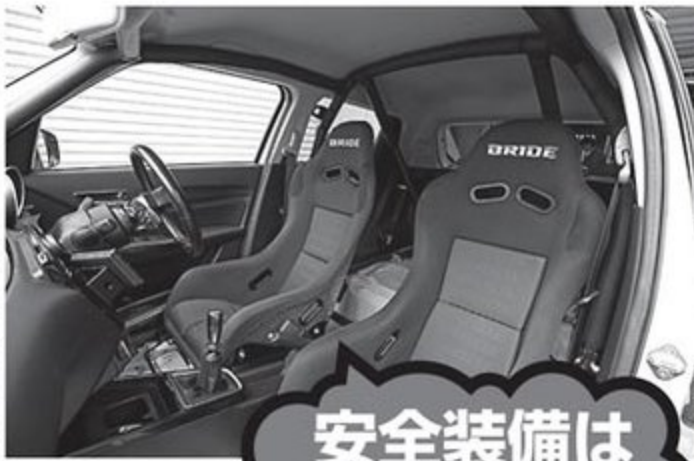
未舗装路では横転のリスクもある。車内にはロールバーを組み込むほか、開口部にはスポット増しも実施される。また荒れた路面で走るには身体をしっかりホールドしてくれるフルバケも必須。ブリッドのシートをセットする。
