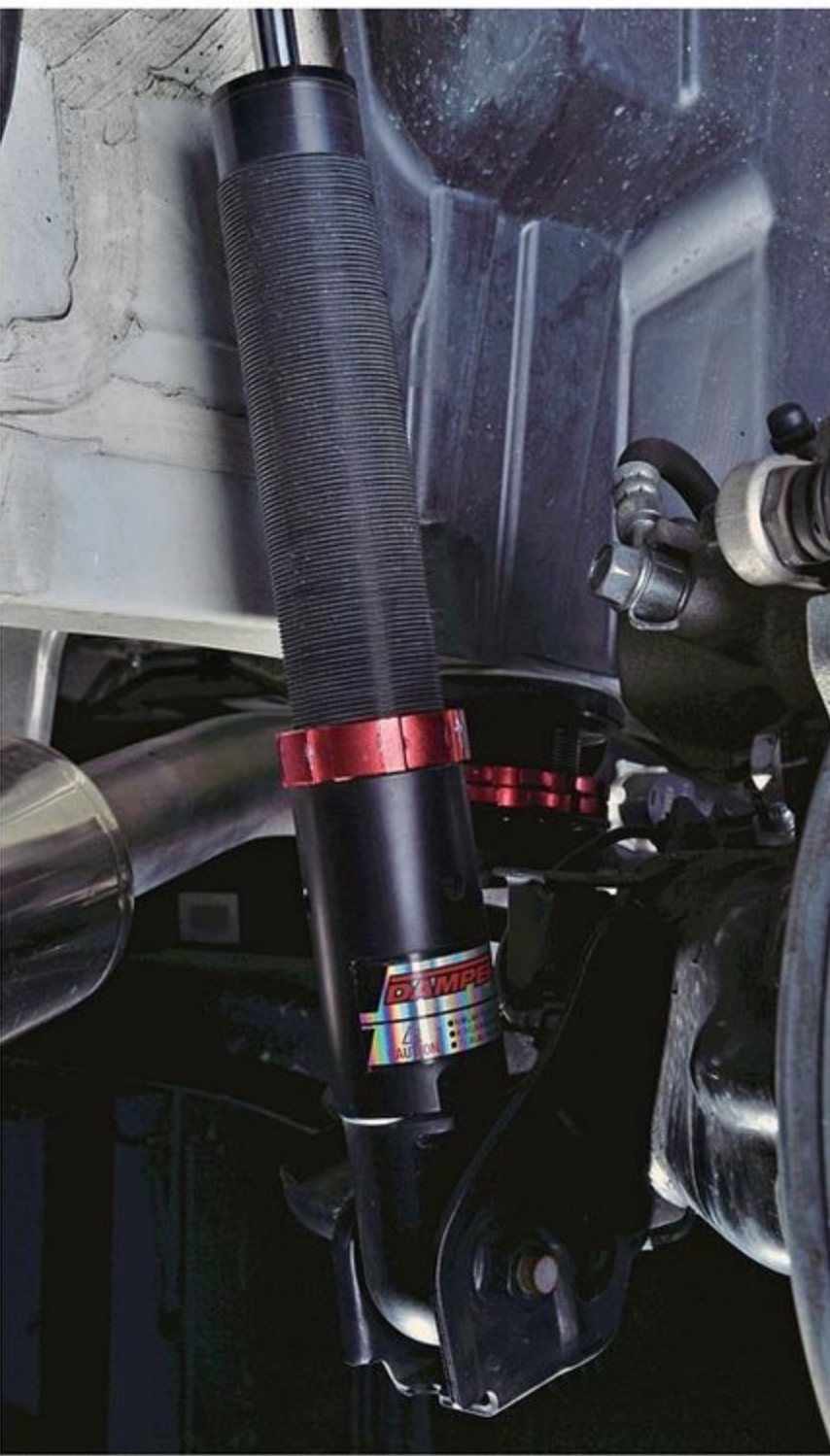
全長調整式サスペンションと電子制御式の減衰力機能を組み合わせた新世代の車高調キット「ダンパーZZ-RスペックDSC PLUS」。バネレートはF：5kg/mm、R：3kg/mmと柔らかめの設定。コントローラーやステッピングモーターなど取り付けに必要なモノはすべて同梱する。価格は21万円。
