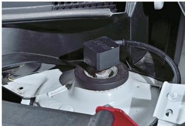
減衰力は最大96段と細かく調整することが可能。その制御を担うステッピングモーターも正常進化。小型化することで取り付けやすくなったほか、モーターのスピードも向上している。
