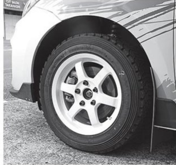
ブロックが大きいダートトライアル専用タイヤ、アドバンA053を装着。サイズは185/65-15だ。まっすぐ走るのもラクではない路面状況だけに、いかにトラクションを掛けられるかが肝心なんだとか。
