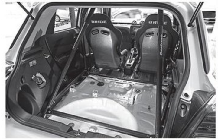
未舗装路では横転のリスクもある。車内にはロールバーを組み込むほか、開口部にはスポット増しも実施される。また荒れた路面で走るには身体をしっかりホールドしてくれるフルバケも必須。ブリッドのシートをセットする。
