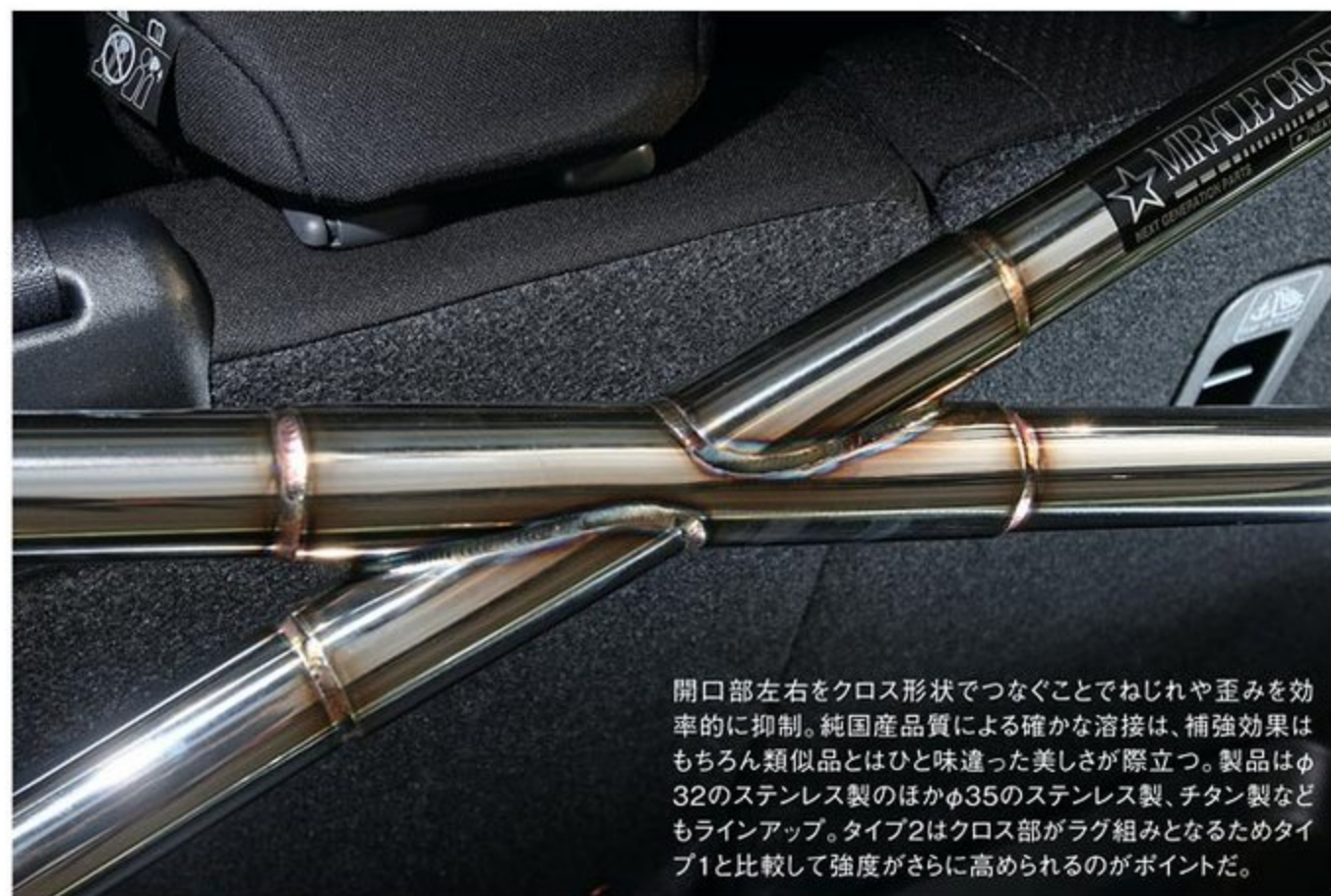
クロスバー取り付け部は車体にあらかじめ備わるアンカーポイントなどを利用するため、新たに穴あけ加工などは一切必要ない。
