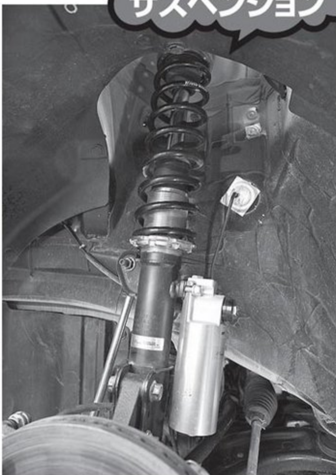
KYBリアルスポーツダンパースペックGRをセット。別タンク式を採用するこのダンパーは、細かく減衰力を調整できる3ウェイタイプ。ストローク量はかなり長い。しっかりアシを動かすためバネレートは前後3kg/mmという柔らかさだ。
