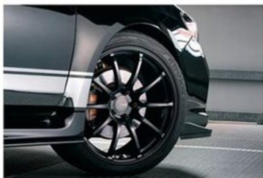
足元はアドバンレーシングのRSIIの19インチをセットアップ。タイヤはアドバンスポーツV105の235/40R19。
