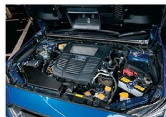
フェンダー部のダクト付きカバーに注目。エンジンルーム内の熱気抜きも期待できる。
