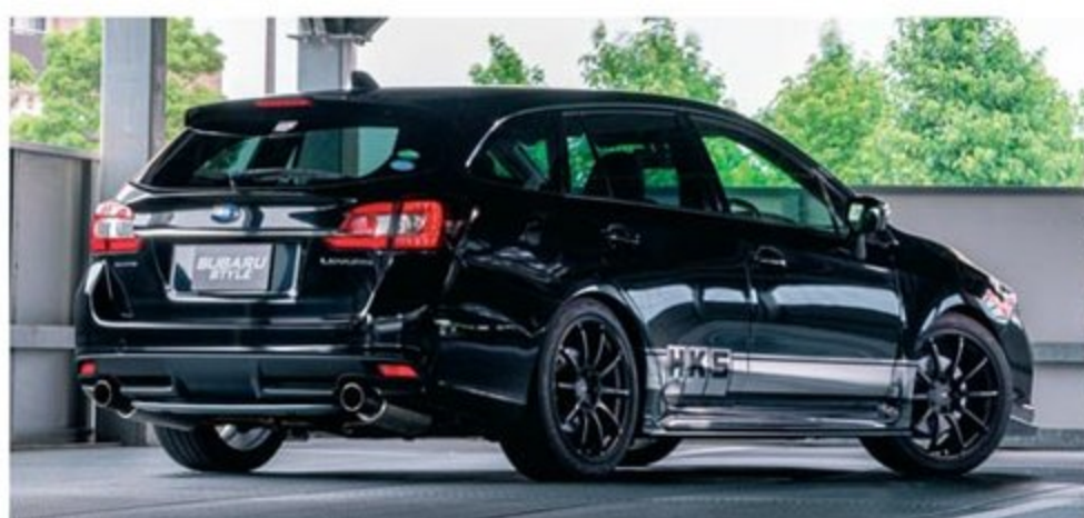
20SPECでフロント約23mm、リア約30mmのローダウン。ボトム回りは定番のSTISポイラーでスタイルアップ。
