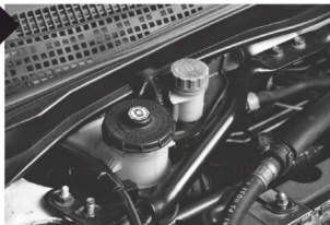
クラッチマスタからの液漏れ
