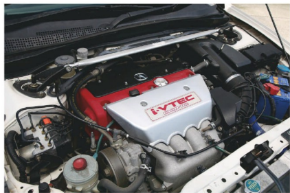
タイミングベルト式だった旧型に対し、タイミングチェーンによって耐久性も向上したK20Aエンジン。好調を保つにはプラグやコイルの点検が重要。10万kmを越えたら、オーバーホールも検討したいところだ。
