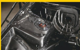
サスペンションの支点となるストラットノックポイント増しを行うだけでなく、室内から貫通したロールオーバーをつなぐことで強度と剛性をアップしている。
