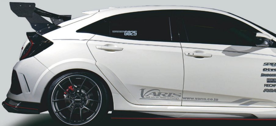
純正ではダミーとなっている左右のダクトから導入したフレッシュエアはサイドから排出するデザイン。左右ブレーキダクトは純正と同様に機能する。
