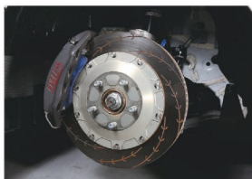
ブレーキはフロントにエンドレスのモノブロック、リアはZONEのパッドで強化。サスペンションの挙動はもうひとつ、重量の多い車体に合わせてブレーキバランスを合わせることも、速くするためのポイントなのだ。
