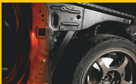
フロントのフレームとキャンベンのつなぎ目も補強を加えることで、フロントエンドの剛性はアップする。特にFF車両の場合はハンドリングだけでなくトラクションの上がりにも効果はテキメン。
