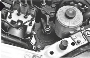
エンジン&amp;MTマウントの劣化
