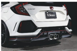
純正リアバンバーに追加するタイプのリアディフューザー。ボディ下面からのエアをスムーズに排出してダウンフォース獲得に貢献する。
