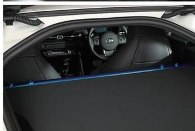
エンジンルーム内のタワーバーやシートレールの付け根に取り付けるブレースバーなどのボディ補強パーツはクスコ製。スーブラはもとよりボディ剛性が高いけど、装着すればさらにボディ剛性アップを体感できるお薦め商品だという。
