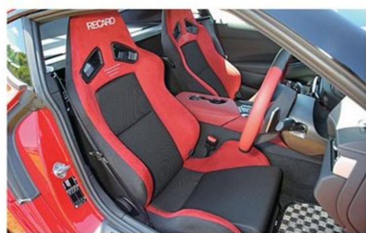
シートは運転席、助手席ともレカロSR7に変更。レッド×ブラックのカラーは純正インテリアと親和性も抜群。ホールド性や快適性の向上のほか、パワーシート機構の廃止による軽量化にも有効だ。
