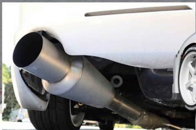
アーティスト代表の宮坂さんがこだわったのが甲高いエキゾーストノート。そのためには板厚が薄いチタンマフラーが必要不可欠。ヴェイルサイドの砲弾型ストレートタイプを採用することで、美しい排気音を実現している。
