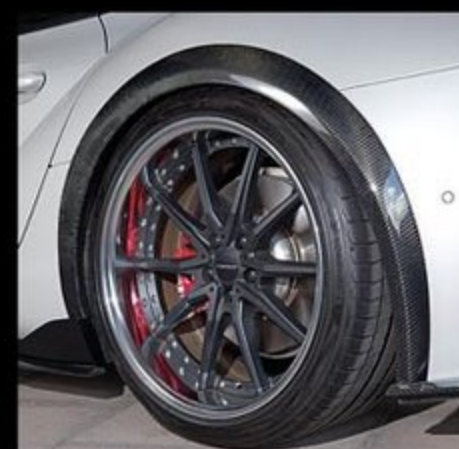
車検対応となる8mmワイドのフェンダートリムを装着することでオーバーサイズのホイールも装着可能。装着ホイールはアーティシアンスピリッツ・コラートA5の20インチ。さらにフロントフェンダー後ろに装着するダクトパネルも新設定。
