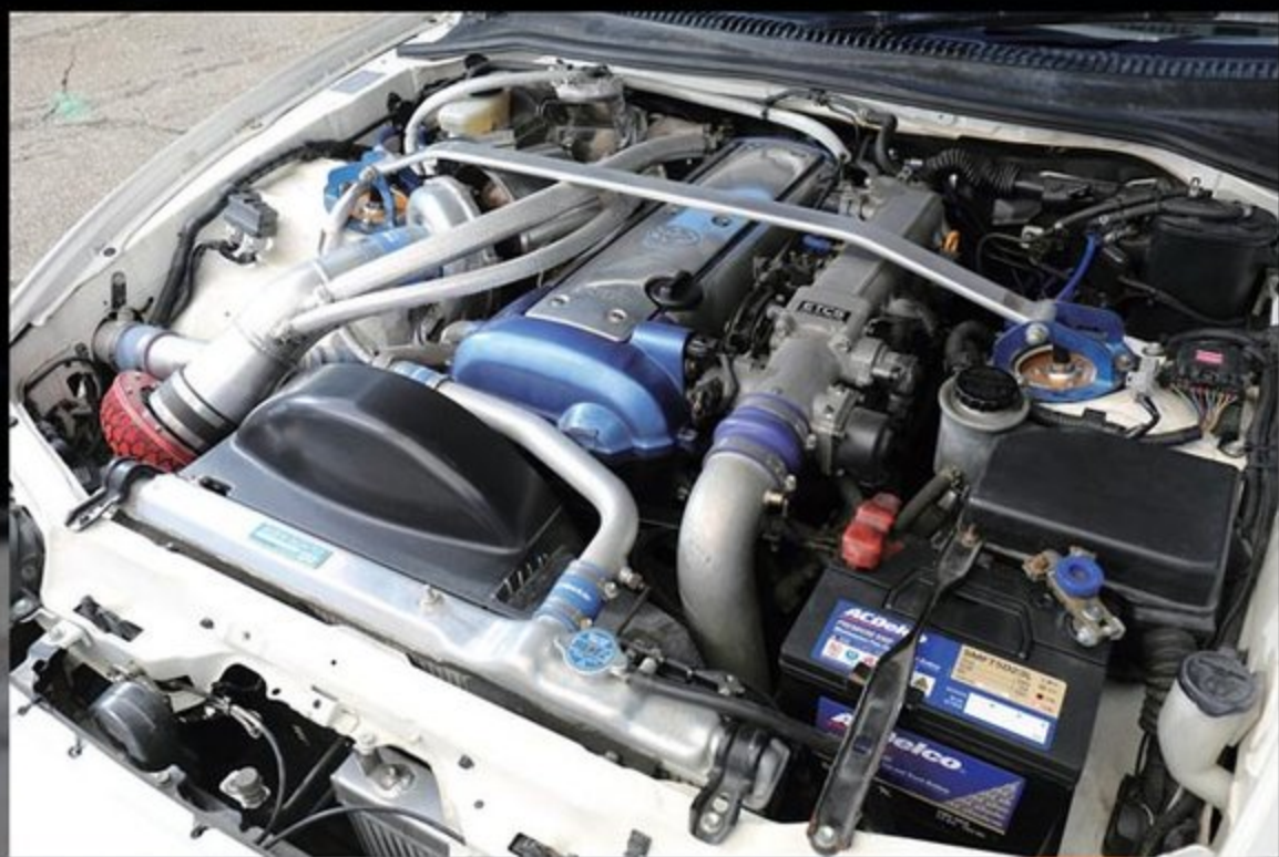
1JZ-GTEが違和感なく収まったエンジンルーム。腰下はノーマルだが、排気側のみハイカムを組み込んだ。タービン周辺の配線、配管類には遮熱処理を施すなど、きっちりと仕上げられる。ちなみにエンジンハーネスは、長さに余裕のある30ソアラ用をベースに取り回しを変更。一部を繋ぎ変えて接続している。
