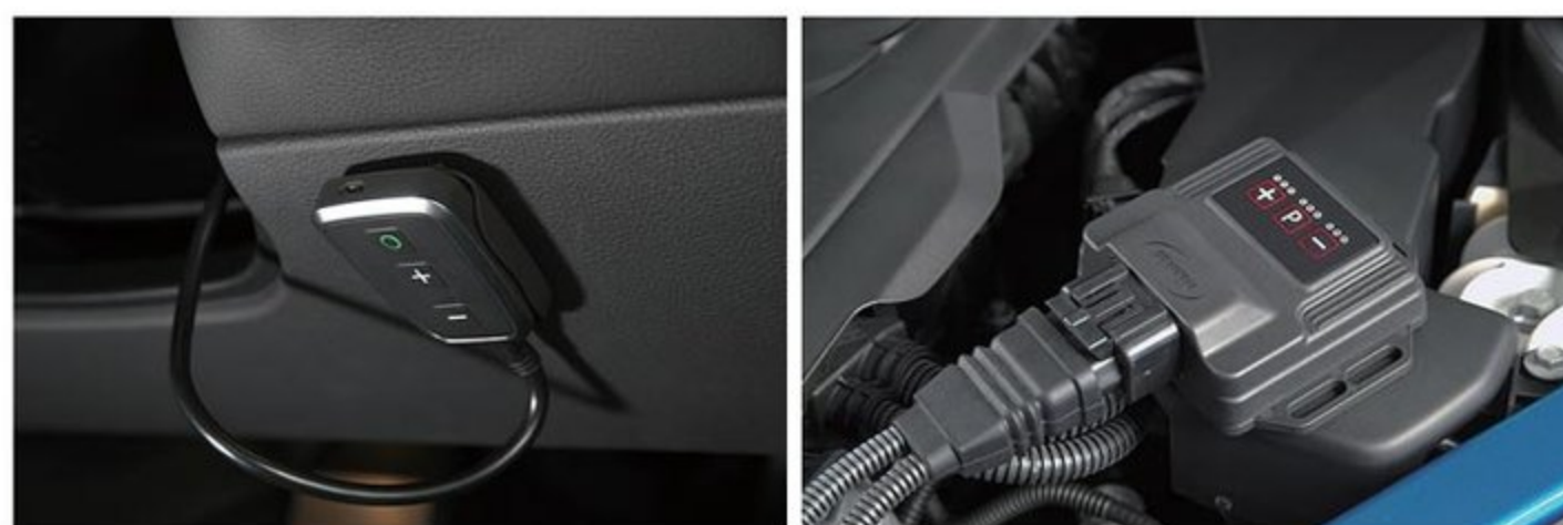
純正のコンピューターにカプラーオンで取り付けるタイプのサブコンとスロットルのレスポンスを変えるスロコンは、ドイツのDTE製。サブコンでエンジンパワーが高め、スロコンでアクセルレスポンスがスポーティな状態に調整される。
