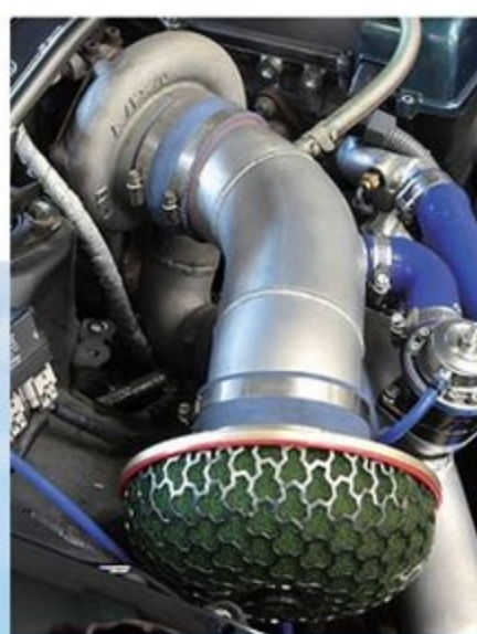
後期のVVTi付きターボエンジンにT04 Rタービンを組み合わせる。大きすぎず小さすぎずのタービンサイズとすることでターボラグを感じさせず、全域でパワー&レスポンスを味わえる。
