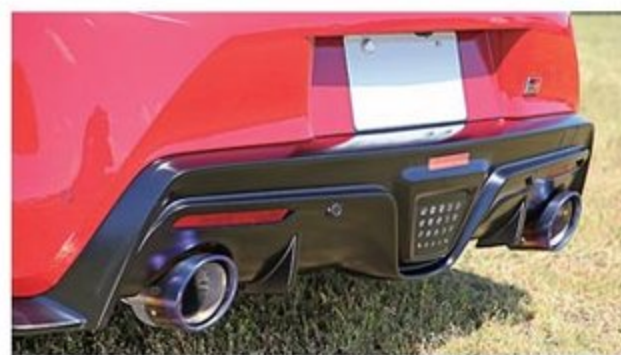
チタンテールのマフラーは、アベックスの海外仕様。程よい音量のスポーツサウンドとなっていた。イングス製のリヤバンパーには、エアアウトレットが設けられている。
