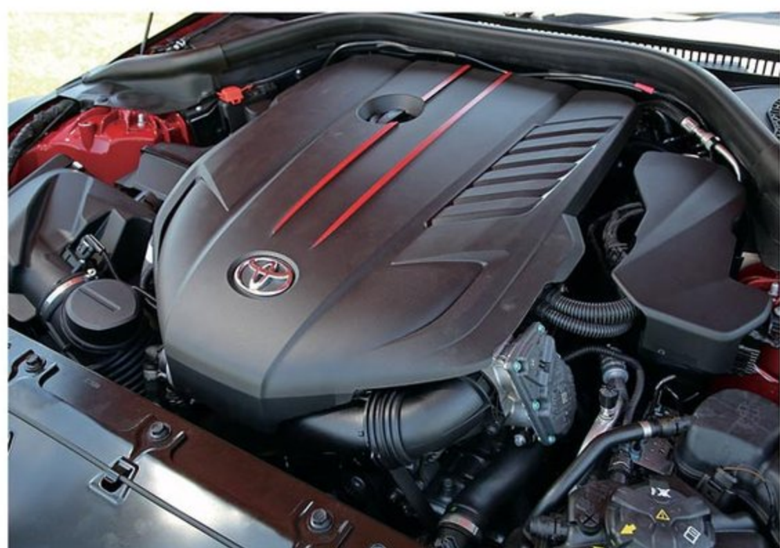
3.0ストレート6のB58はエアクリナーなども含めて完全なノーマル状態ながら、オリジナルECUセッティングによるパワーアップが図られる。今回は高速域での伸びを狙って燃料薄めで進角抑えめとしてきた。
