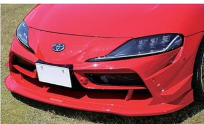
イングス製のエアロパーツNスペックは、圧倒的な存在感とサーキットでの機能性を両立させたもの。前後バンパーとサイドステップのほか、フロントエアロフェンダーも装着。アタック時にはリヤウイングを取り外した。
