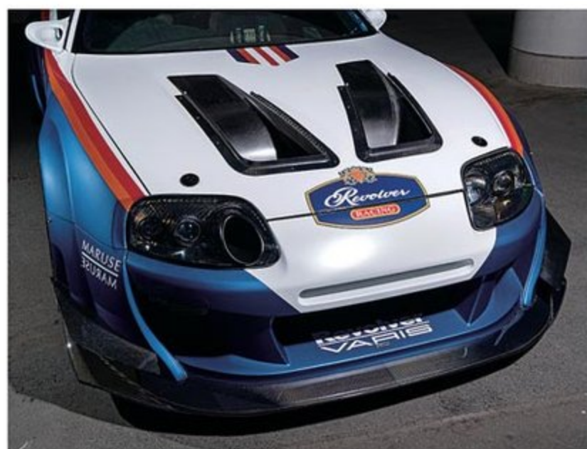
Vマウント化されたインタークーラー&ラジエーターの熱気をスムーズに排出するために設けられたボンネットダクトから本気度が伺い知れる。張り出しの大きいリップやカナードもレーシングカーさながらの姿相。
