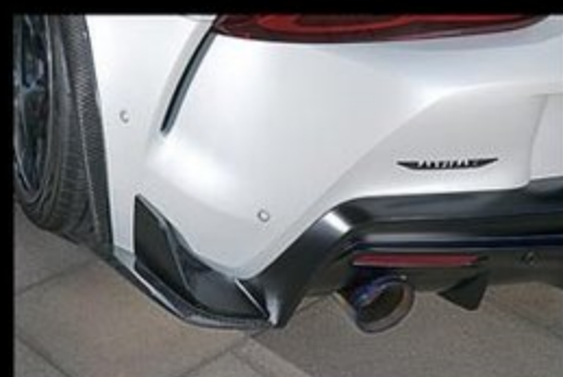
リアバンパーは純正ながらサイドにカーボン製ディフューザーを追加し、さらに新作のフルチタン製エキゾーストシステムを装着する。マフラーは車検非対応の競技用となるが、美しいチタンカラーがリヤビューに彩りを添える。
