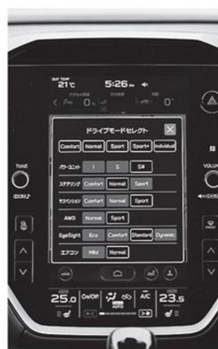
11.6インチセンターインフォメーションディスプレイ&インフォテインメントシステムはSTI Sport EXに標準装備(STI Sportにはオプション設定)。5つのドライブモードはステアリングスイッチで操作可能だが、デザインはもとより視認性や操作性にも優れた装備として選択しておきたい。
