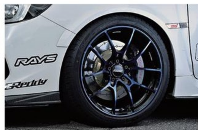
今回セッティングしていたホイール&タイヤは、レイズG025(FR9.5Jx19+45)にダンロップSPスポーツマックスGT(FR255/35)の組み合わせ。ブレーキはエンドレスのキャリパー&ローターで強化している。
