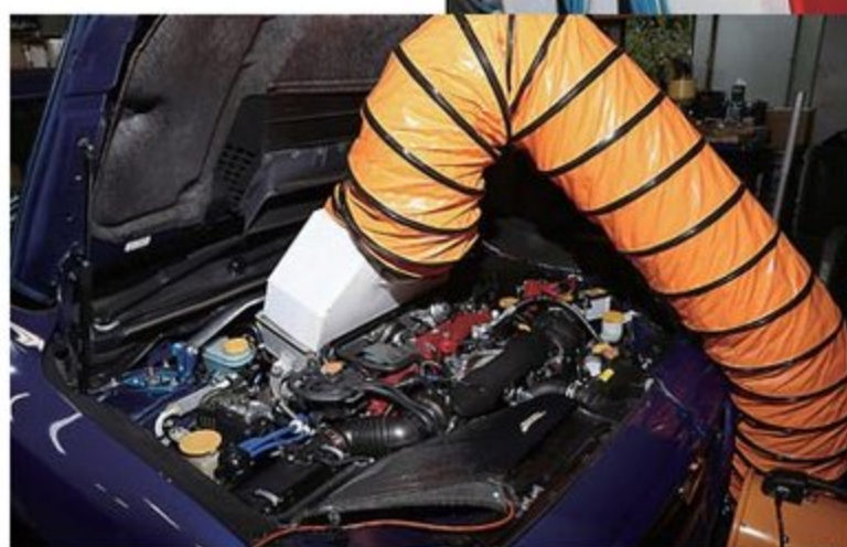
好評のECUセッティングは、TPSデザインによるいわゆるツルシデータの書き込みが9万8000円。それをベースにした現車セッティングが20万円からとなる。実際の走行状況に近づけるためファンの風をインタークーラーにも導くなど、スバル車のためのノウハウが詰まっている。
