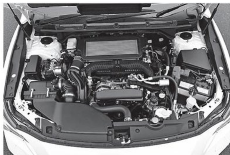
新開発の1.8ℓ直噴ターボが全車に搭載される。スバリストも納得の新世代のボクサーエンジンCB18型の幕開けだ。
