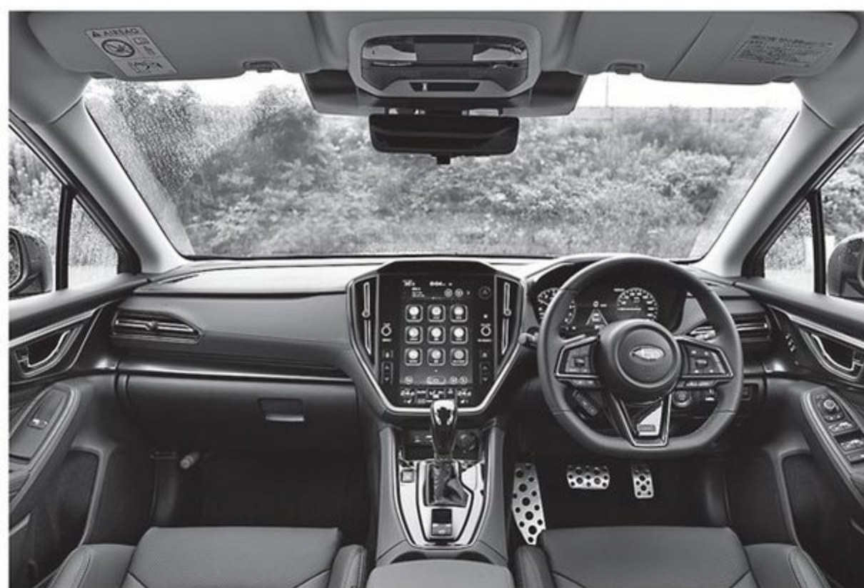
運転支援システムの作動状況などをグラフィカルに表示する12.3インチフル液晶メーターや、大型かつ高精細の11.6インチセンターインフォメーションディスプレイで構成されるデジタルコックピットが先進性を強調する。
