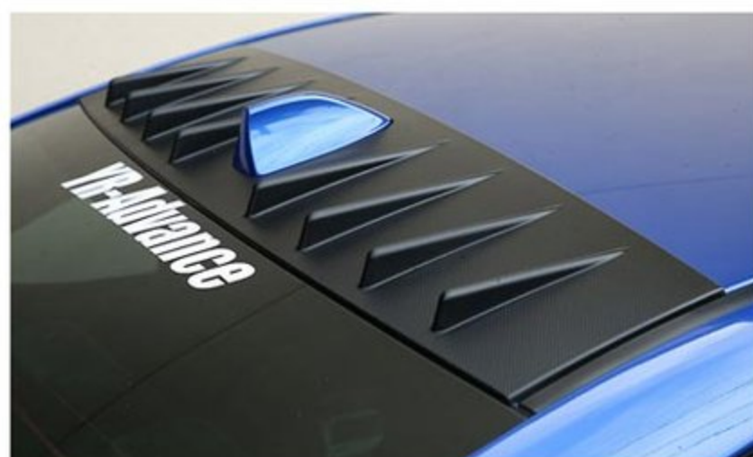
ルーフアンテナと違和感のないデザイン&サイズにこだわったルーフフィン。初回リリース分に限りフィン形状と表面処理の異なる4タイプを用意。ABS製で両面テープ固定。価格は2万4000円で近日発売予定だ。
