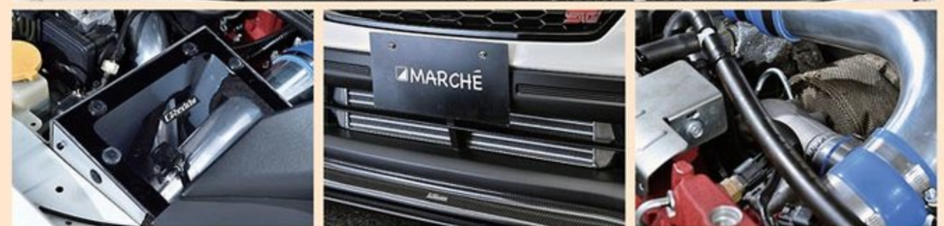
HKS製キットにより2.2ℓへ排気量アップしたエンジンに、トラスが2020年末にリリースを予定しているTD06H・20RXタービンキット(予価49万5000円)を組み合わせた。別売りの前置きインタークーラーキットとエアインクスキットの追加で高出力に対応する。
