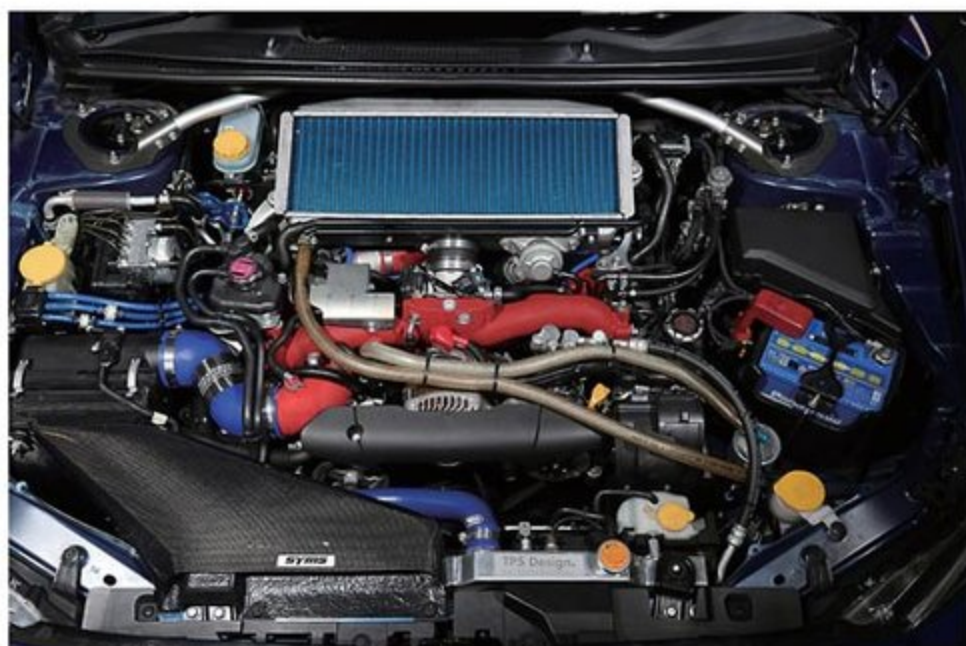
TPSデザインのラジエターやシムスのエアインタークーラー、ゼロスポーツのインタークーラーパイプなど厳選パーツの組み合わせで美しく仕上げられたデモ車のエンジンルーム。ブーストアップからフルチューンまで対応してくれる。
