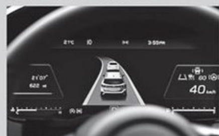
作動条件が揃うとメーターにアイコンが表示される。快適なロングドライブをサポートしてくれる。
