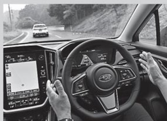
自動車専用道路上での渋滞停止時(0km/h~約50km/h)、一定の条件を満たすと、ステアリングから手を放すことが可能。
