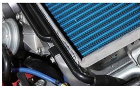
コアとタンクの接合がカシメタイプのノーマルインタークーラーは、ハイブーストでエア漏れが発生する。そこでゼロマックス南関東店では接合部を溶接して対策。放熱フィンの加工とセットで5万円となっている。
