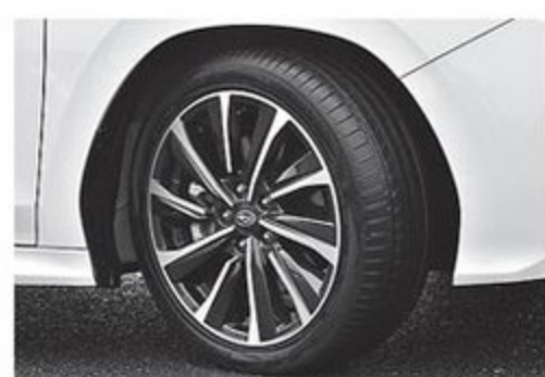
STI Sport用の18インチアルミホイールや、ZF製電子制御ダンパーなど、STI Sport専用の装備が随所に見られる。
