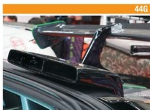
GT1 エンジンルームダクト
