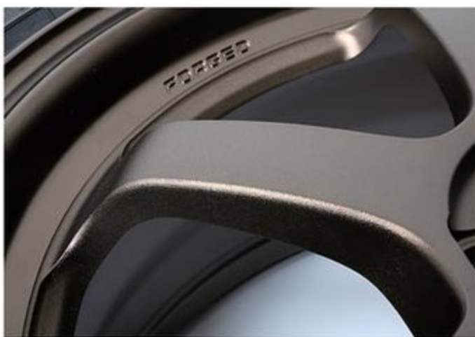
限られたスペース環境の中で立体感と剛性を両立するために採用されたステップドリム。繊細なKカー用だからこそ、徹底的にこだわった設計がなされているのだ。
