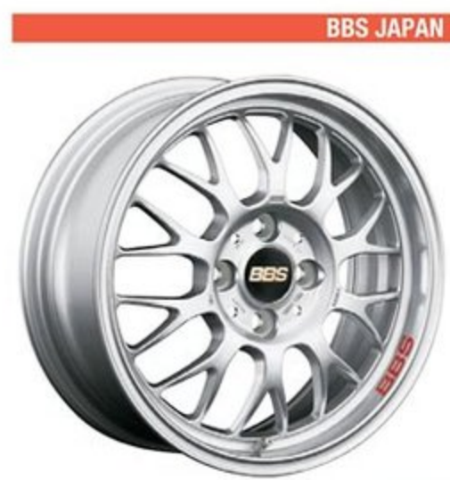
BBS JAPAN RG-F 鍛造 1P SIZE F 15×6.0 40/45・R 16×6.5 42/48 COLOR シルバー・ブルーブラックダイヤカット・ダイヤモンドブラック・ゴールド ■4万9000円(15×6.0) 5万9000円(16×6.5) ■BBSジャパン ☎03-6402-3957
