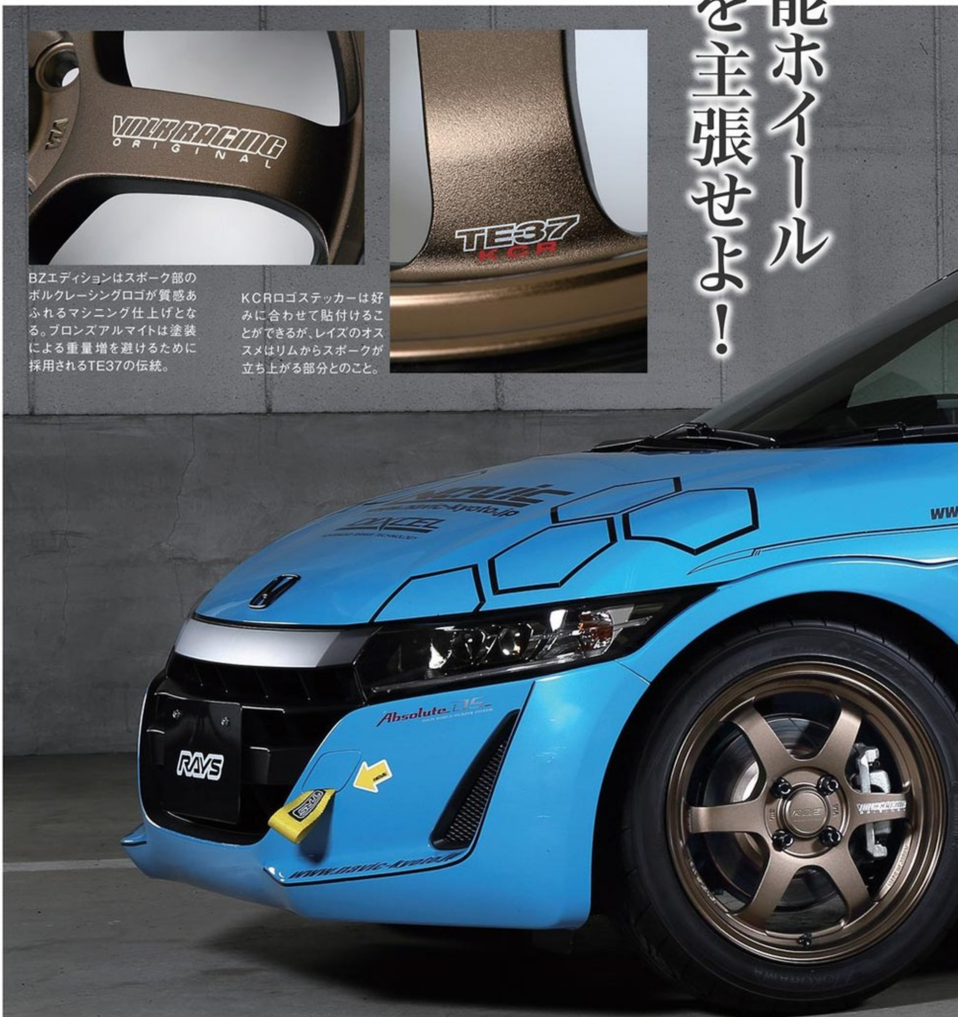
限られたスペース環境の中で立体感と剛性を両立するために採用されたステップドリム。繊細なKカー用だからこそ、徹底的にこだわった設計がなされているのだ。
