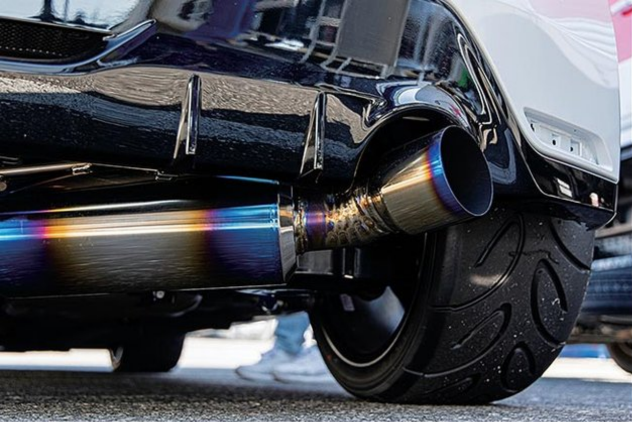
エキゾーストマフラーは、Gフォースオリジナルのフルチタンモデルで武装。軽量化&排気効率向上を狙った砲弾タイプで、サーキット用に高回転域の抜けを重視したスペシャルだ。
