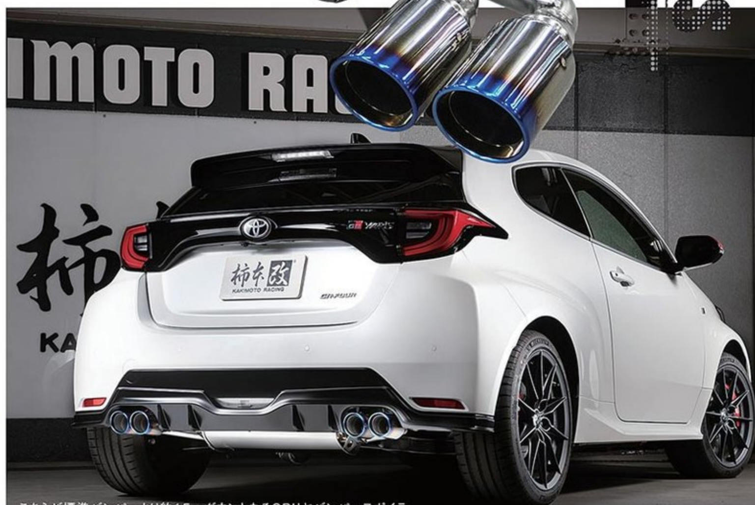
こちらが標準バンパーより約15mmダウンとなるGRリヤバンパーボイラーに対応する4本出しタイプ。96φ×4のTi-FACEの迫力がたまらない。
