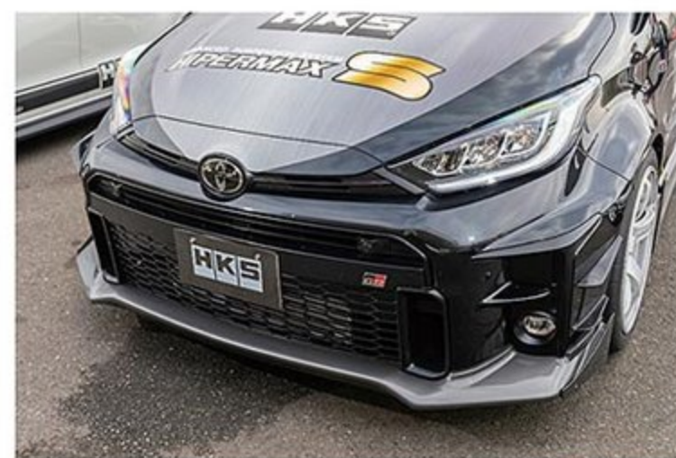
流体解析によって理想的な空力性能を追求したエアロ。車検対応ながら効果的にダウンフォースを発生させ、走行安定性の向上を図る。さらにスタイルアップも実現する。
