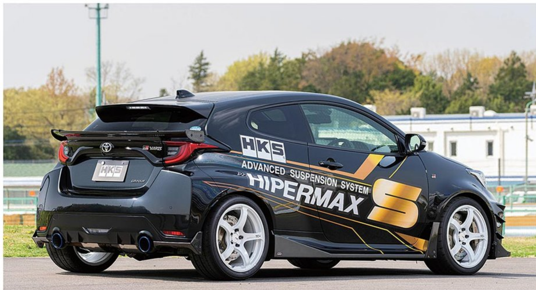
流体解析によって理想的な空力性能を追求したエアロ。車検対応ながら効果的にダウンフォースを発生させ、走行安定性の向上を図る。さらにスタイルアップも実現する。
