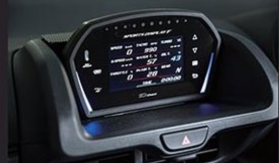
ディスプレイオーディオのRCは視認性高い場所にスペースが生まれているため、走行データ収集&解析のためデフィのスポーツディスプレイFをインストールした。
