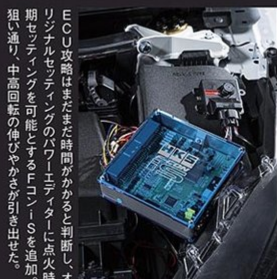
ECU改修はまだまだ時間がかかると判断し、オリジナルセッティングのパワーエディターに点火時期セッティングを可能とするFコンiSを追加。狙い通り、中高回転の伸びやかさが引き出せた。
