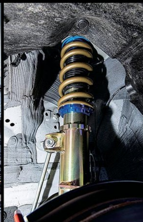
サスペンションはGフォースのオリジナル車高調で、スプリングレートはフロント14kg/mm、リヤ16kg/mmの設 定。そのほか足回りは、スタビライザーもクスコ製の強化品に変更している。
