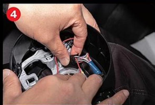
モニター用電源供給結線
