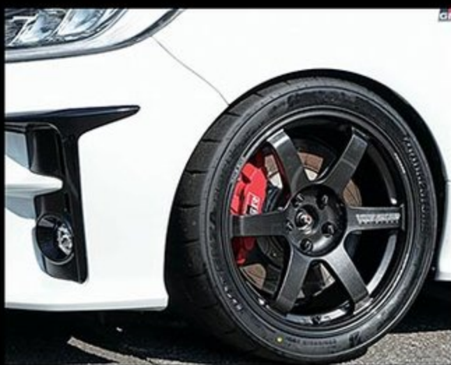
ホイールは前後共に9.5JのボルクレーシングTE37SAG A。アタック本番でのタイヤはポテンザのハイグリップラジ アルRE-12D(265/35-18)を組み合わせる。
