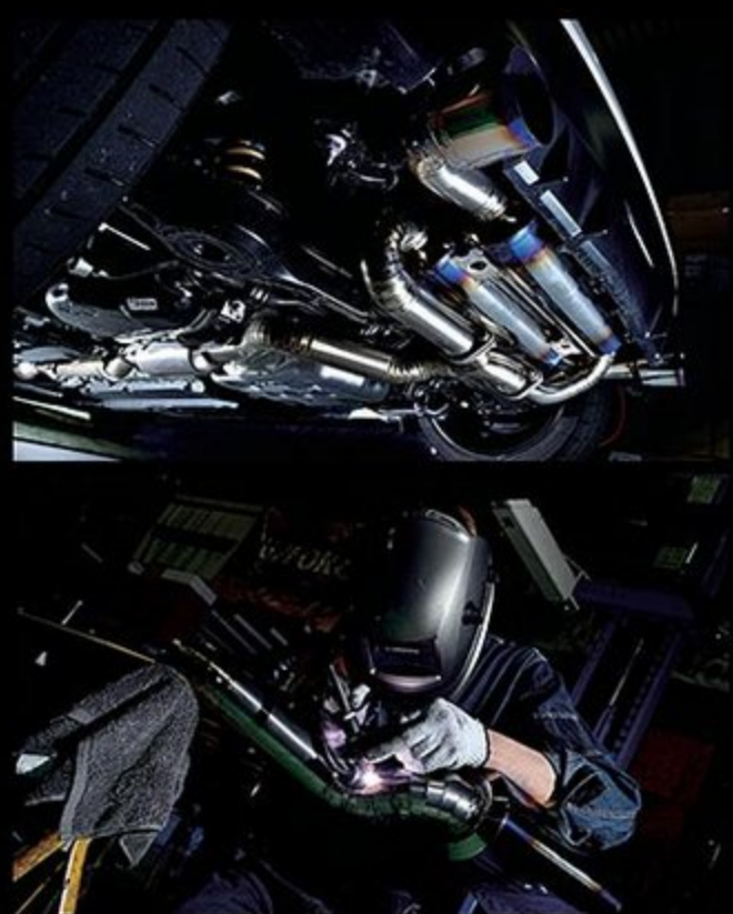
ストリート用に静音性を重視したツインターール仕様のサイレントモデルも製作済み。Gフォースでは、ユーザーの要望に合わせたワンオフチタンエキゾーストもお手のものだ。価格は20万円〜とのこと。
