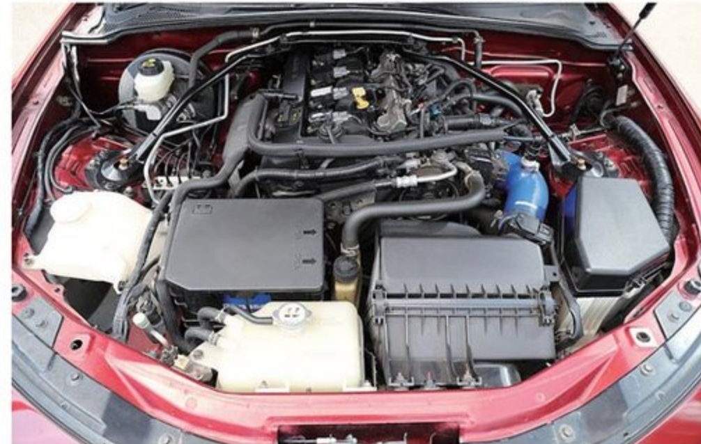
タコ足はNOPROの45φ4-1等長タイプを装着。L3エンジンは排気ポートサイズが小さいので、ポート拡大を組み合わせることで4～6速の高速、高回転域でパワーを発揮できる。
