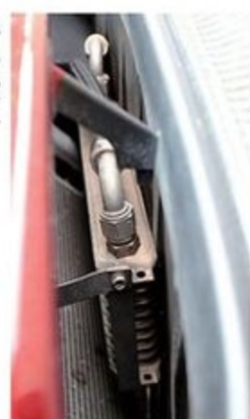
サーキット走行のマストアイテムがオイルクーラー。水平マウントタイプは試作だが、油温を安定させることでノーマルラジエーターでも連続走行が可能になる。
