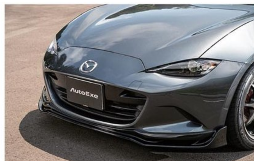
一体感あるデザインのフロントアンダースポイラー(9万200円)。両サイドのダクトからフロントタイヤ前方のストレーキーに向けて空気を送り込み、整流効果を高める。ピアノブラック塗装済みだ。
