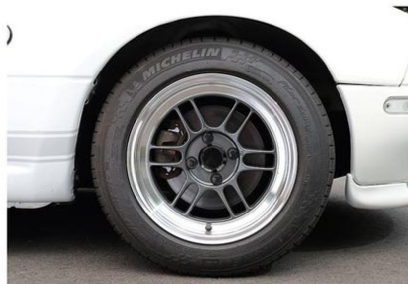
エンケイRPF1ホイールは、ロードスター専用のハブホールサイズとしたオリジナル。サイズは7J×14+28で、3.8kg(1本)の軽さが魅力。タイヤはミシュランのネオクラシック向けエグザルト(185/60)をチョイス。
