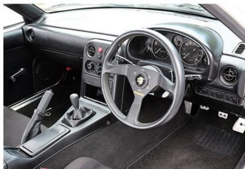
インテリアも30年の月日を感じさせない美しい仕上がりで、軽量化のためにシートをエスケレート製のフルバケットタイプに変更。エアコンレス化や電動パワステかなどと合わせて、車重は約900kgというから驚きだ。
