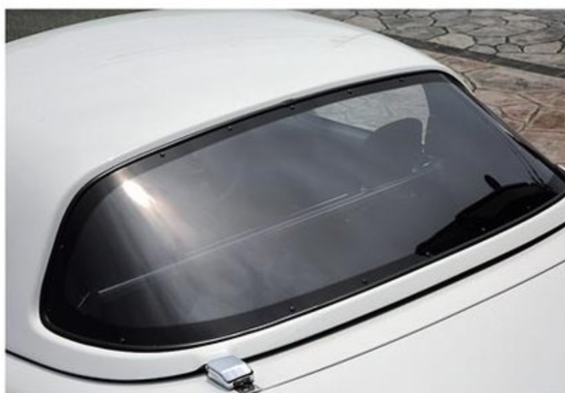
純正ハードトップのリヤウインドは試作のポリカーボネート製に変更。ガラスタイプに比べて大幅な軽量化が可能だ。ほかにも前後バンパーの純正形状リップも、オリジナルパーツとしてリリースを予定している。
