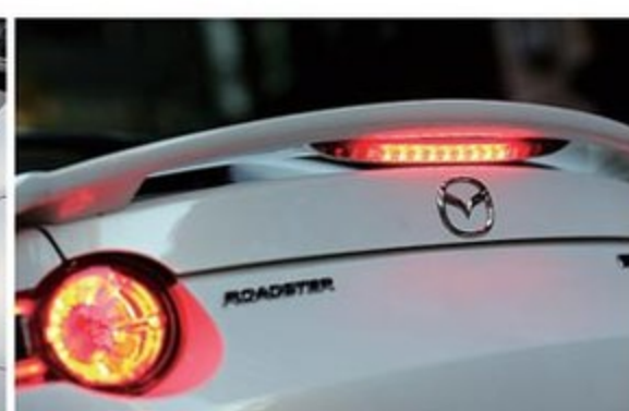
ロードスター純正のハイマウントストップランプを移設することで法規にも対応できる。あえて高さを抑えたりヤウイングがストリートにマッチする。
