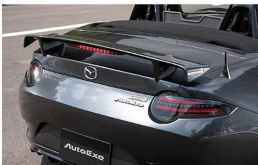
リヤウイング(8万1400円)は、中央部に純正ハイマウントストップランプを移設する設計。翼端板にはオートエクゼのロゴも入る。FRP製だ。LEDリアコンビネーションライト(6万8200円)もセットする。
