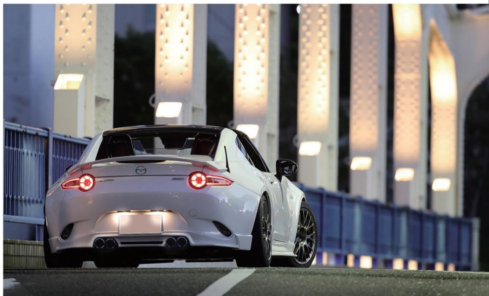
全てのエアロはロードスターとRFの共用となっているが、リヤスポイラーをRFに装着する場合のみロードスターの純正ハイマウントストップランプが必要となる。
