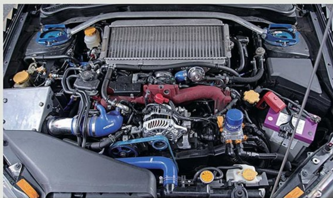
エンジンはHKSのキャパシティアップキットを使って2.2ℓに排気量をアップ。コレに合わせてGTⅢタービンをセットすることで、安全マージンを取りながら446psのパワーを発揮させている。
