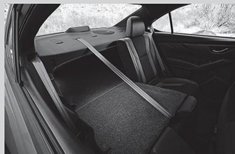
リアシートは6:4の分割可倒式で、トランクスルー機構を備えている。
