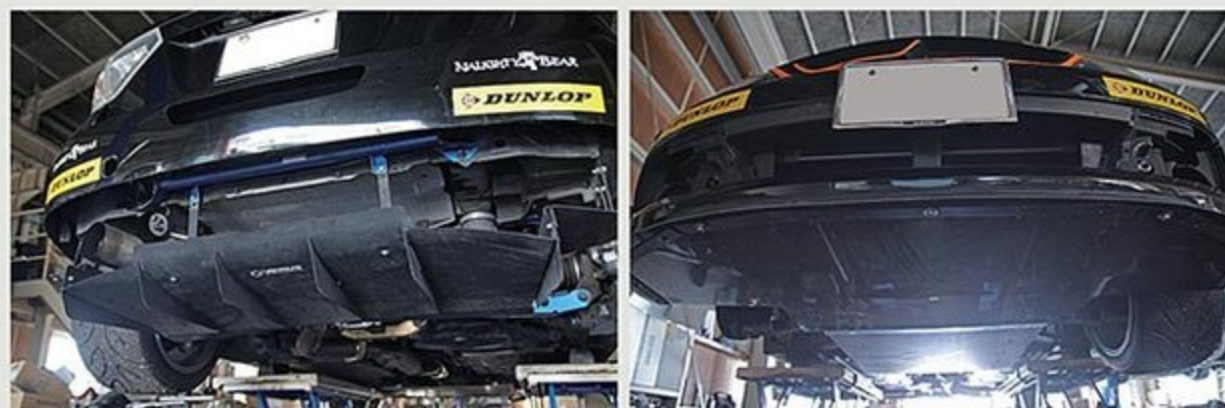
フロアはフロントからリアまでフルフラットな形状でアンダーパネルを造形。リアディフューザーで空気の流れを整流しながら流速を高めることで、ダウンフォースを増大させている。タイムアタック用に大型のフロントアンダーパネルなども取り付けられる。
