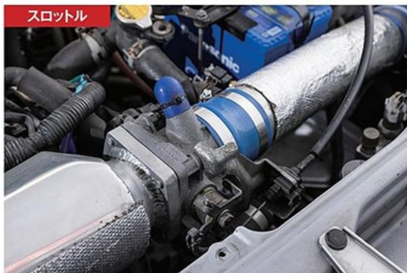
スロットル スロットルはセリカ用（2ZZエンジン）だが、実は以前も1ZZエンジン用を使用していた。現在、純正比で10mm以上大径仕様となっている。
