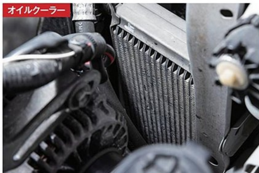
オイルクーラー AE86用のオイルクーラーを追加した。「サーキットを走るなら必須」と熊倉さん。AT車で走るなら、ATFクーラーも検討した方が良さそう。
