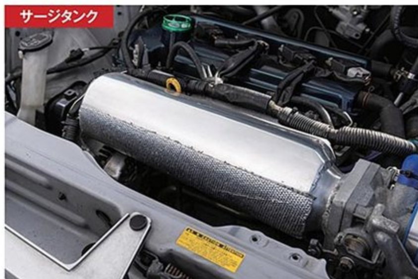
サージタンク ワンオフ製作したサージタンクが存在感抜群！ 中には、4連ファンネル仕様になっている。走行風を積極導入する工夫も盛り込んでいる。
