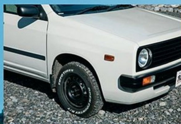
ホイールは14インチのスチールで、タイヤをオープンカントリーに換装。チョイアゲルックにベストマッチ。
