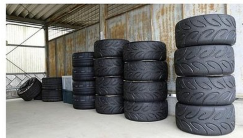
ワイドボディ化で295サイズの装着が可能となったが、パワーとタイヤグリップのベストな組み合わせを模索中。3月の走行時にも265サイズのアドバンA050とポテンザRE-12D、295サイズのA050が持ち込まれていた。
