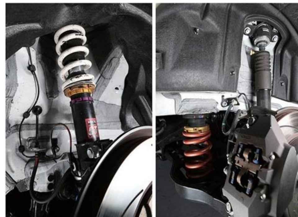
足まわりHKS製のハイパーマックス・マックスIV GTの20スペックをチョイス。タイムアタック車両のバネレートはフロント16kg/mm、リヤ30kg/mmとなっているが、少し跳ねる傾向があるので今後煮詰めていく予定とのこと。
