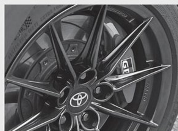
225/40ZRのミシュランPilot Sport 4S+BBS製8J鍛造アルミホイールの組み合わせ。フロントにアルミ対向4ポット、リアにアルミ対向2ポットのカラードキャリパーを装備。ディスクは放熱性に優れたスリット入りとした。
