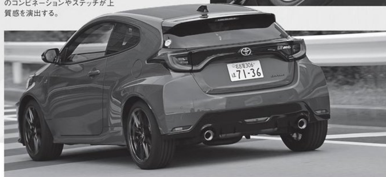
225/40ZRのミシュランPilot Sport 4S+BBS製8J鍛造アルミホイールの組み合わせ。フロントにアルミ対向4ポット、リアにアルミ対向2ポットのカラードキャリパーを装備。ディスクは放熱性に優れたスリット入りとした。
