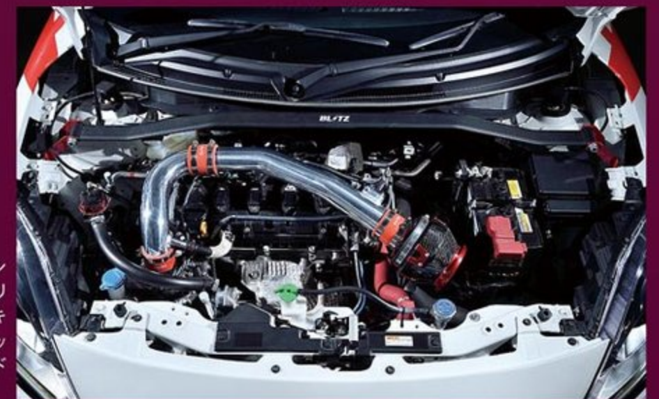
エンジンルームの熱気を遮断するシールド付きのカーボンパワーエアクリナー(5万9180円)やサクシオンキット(1万9800円)は、吸気効率アップに貢献。スポーティな吸気サウンドが楽しめるのもうれしいポイントだ。
