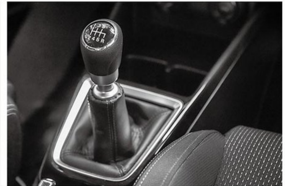
2~5速をクロスレシオ化した先代スイフトスポーツと同じギヤ比の6速MTを採用。1速と2速にはトリプルコーンシンクロ、3速にはダブルコーンシンクロを採用しスムーズでダイレクト感のある操作感を実現。6速ATも設定される。
