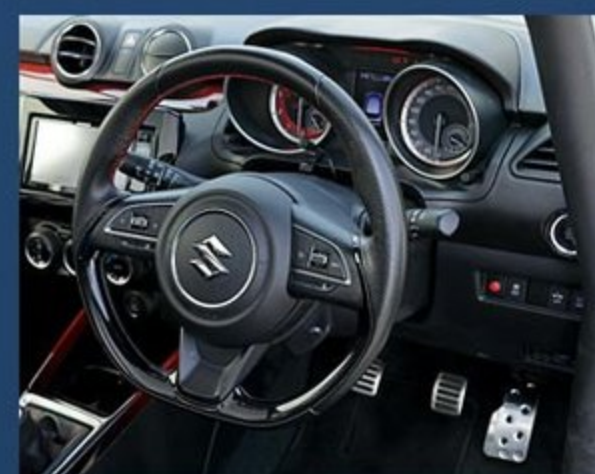
ヒール&トゥの操作性を考慮した形状としたスポーツアクセルペダルは4620円。クスコロゴ入りでステンレス鏡面仕上げとなっており、ボルトオンで装着することができる。
