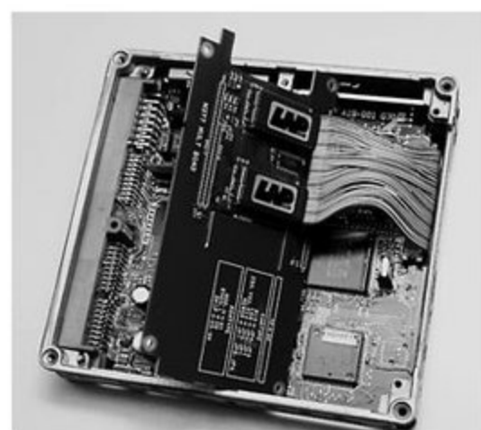
かつての日産車がコンピュータチューニングの始まりといえるだろう。ただし、そのブームの発端となったS13ですらSR20搭載の後期になるとこのような追加基板などを仕込まなければならなかった。チューナー達の努力によってコンピュータチューニングは進化してきたのだ。
