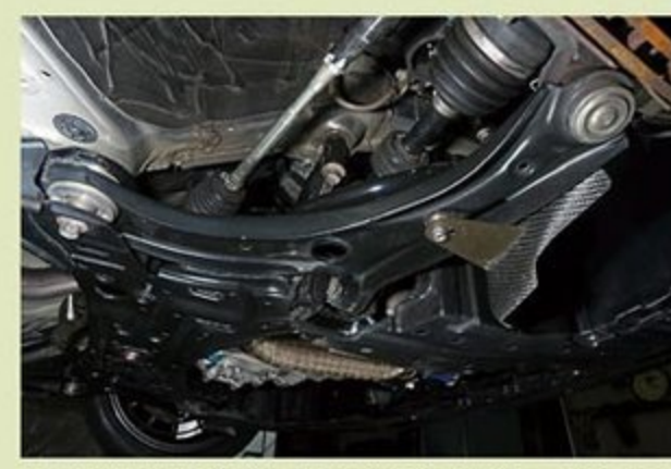
ZC33Sを快速仕様とするために欠かせないのがロアアームブッシュの強化。ノーマルは穴開き形状で剛性が低く、劣化しやすいのだ。デモ車ではロアアーム前後ともピロボールタイプに変更している。
