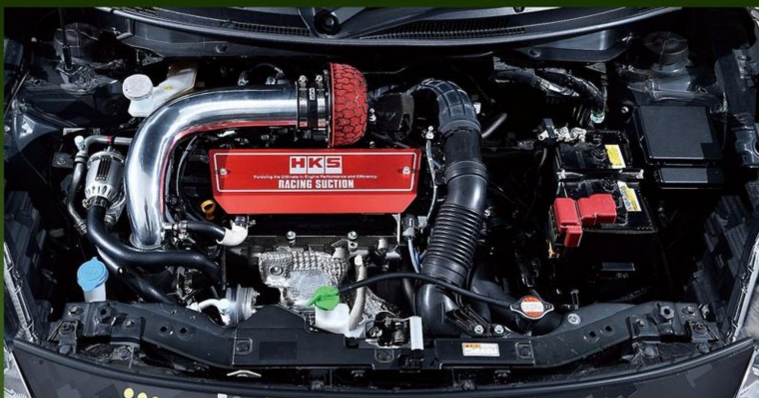
樹脂のバイピングをアルミサクションに置き換えつつクリーナー部を剥き出しとした写真のレーシングサクション(6万3580円)に加え、組み合わせて使用することができるカーボン製のコールドエアインテークキット(9万4600円)を用意。両者がセットとなったフルキット(14万5200円)も用意されている。
