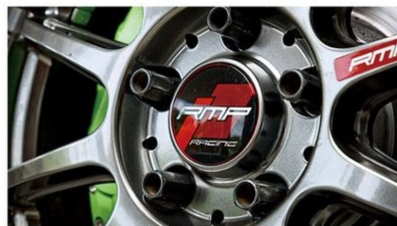
ナットホールギリギリまで追い込んでスポークの足長感を引き出すセンター部分は、リムフランジとともに奥行き感をブーストするディープ仕上げとなっている。
