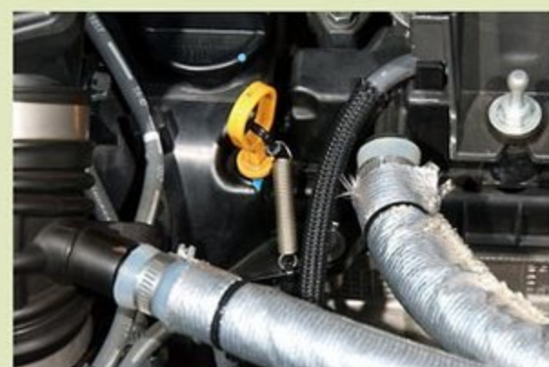
デモ車の仕上げはそのショップの仕事ぶりを映す鏡。オイルレベルゲージの抜け防止やバイブ類の遮熱など、長年のサーキット経験に基づく各種処理にも注目。消耗パーツの徹底管理も好調維持には欠かせないという。
