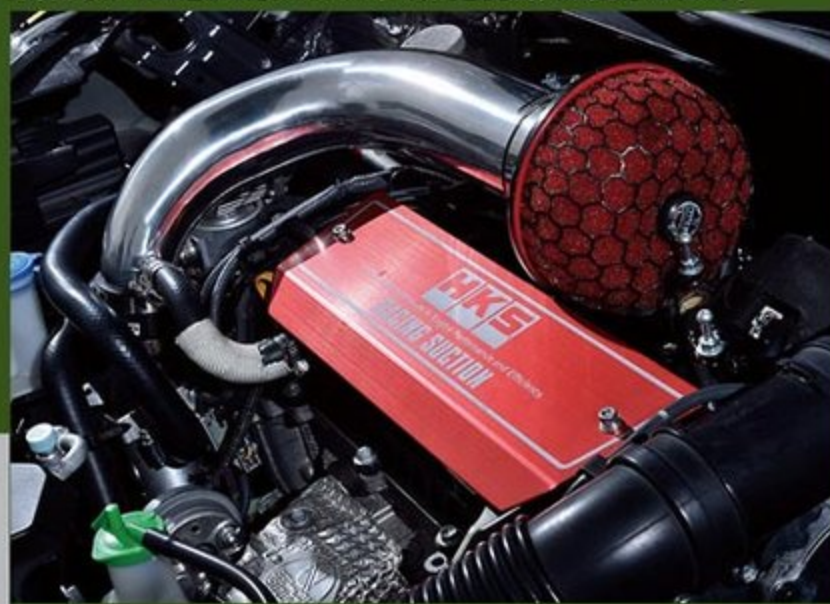
樹脂のバイピングをアルミサクションに置き換えつつクリーナー部を剥き出しとした写真のレーシングサクション(6万3580円)に加え、組み合わせて使用することができるカーボン製のコールドエアインテークキット(9万4600円)を用意。両者がセットとなったフルキット(14万5200円)も用意されている。
