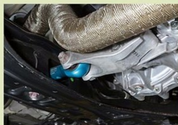
足まわりチューンの効果をフルに生かすために、装着を勧めているのが強化タイプのピッチングストッパー。エンジン&ミッションの前後方向の動きを抑制し、トラクションアップを実現。シフトフィールも向上する。
