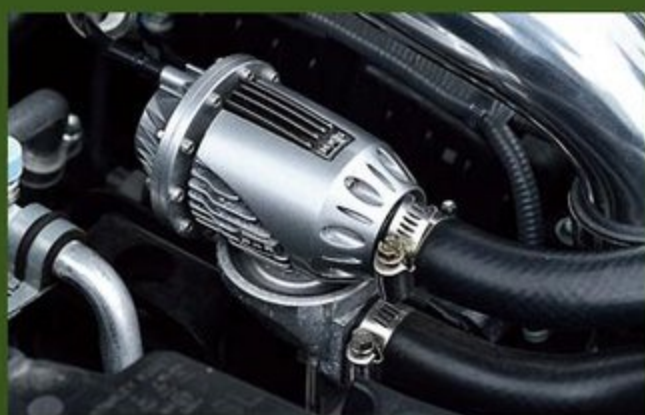
独自のシーケンシャルバルブ構造したスーパー-SQV(3万6080円)。タービン保護に貢献するのはもちろん、キレイのいい大気開放サウンドが味わえるも魅力なのだ。
