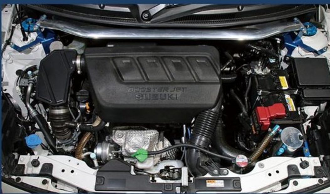
アルミオールシャフトを採用したタワーバー(1万6500円)は、剛性アップに加えてレスアップ効果も高い定番の人気パーツ。オイルキャッチタンク(1万4080円)や、強化エンジンマウント&強化ピッチングストッパーなども用意。
