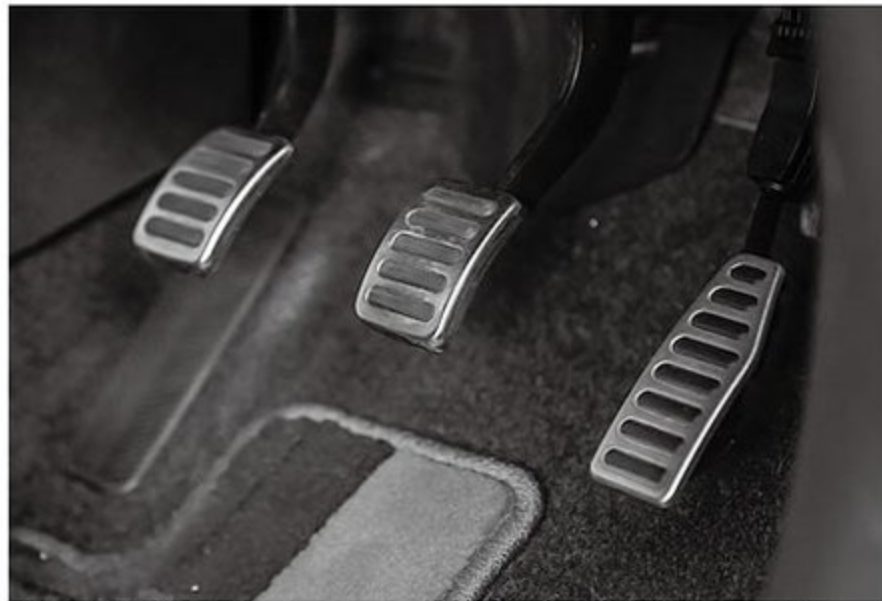
滑りにくく操作性に優れたステンレス製ペダルプレートを採用する。アクセルペダルはホイールハウスとの干渉を避けるため右上がカットされたような形状になっている。操作性に悪影響はない軽快なペダルワークを実現。
