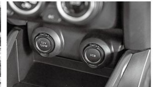
コンソールボックスには12VのアクセサリソケットとUSBソケットが備わる。エンジンスイッチがACCまたはONで使用できる。
