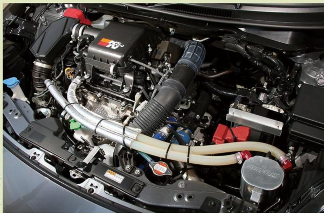
オイルキャッチタンクの配管が美しく処理されて走りの雰囲気は伝わるエンジンルーム。タービンはGCGのハイフローに変更。ケミテッククーラントやローテンブサーモスタットなど、水温安定の対策も万全だ。
