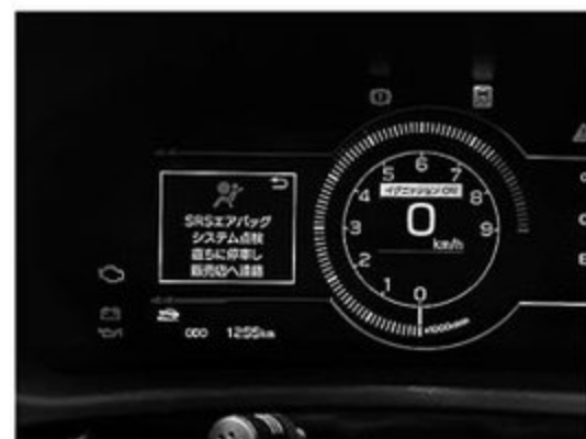
こちらはGR86だが、助手席シートを外すとこんな警告が出る。以前なら配線に簡単な抵抗を入れるだけで対応できたが、現在はそこまで簡単ではない。
