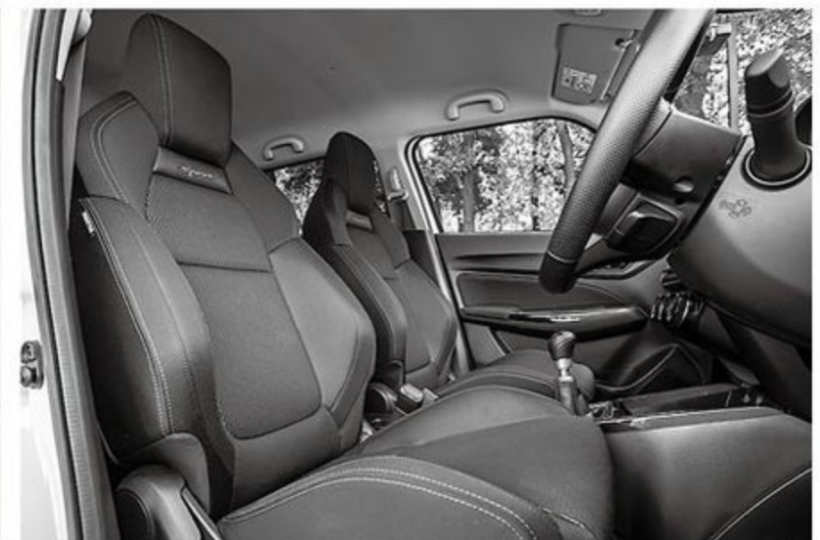
スポーツ走行時にもガッチリとホールドしてくれる形状の専用フロントシートを採用。前後のシートスライド(240mm)、上下のシートリフター(60mm)と調整幅が大きくドライバーの体格や好みに合わせたきめ細かい設定が可能。
