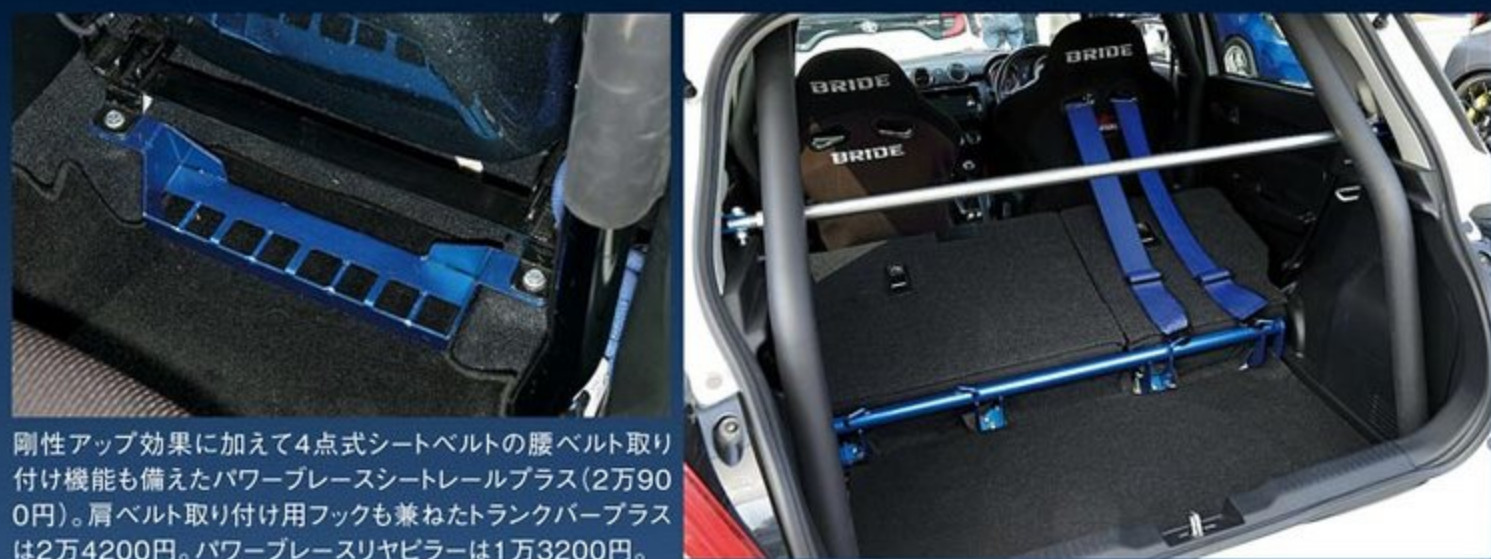
フロア下に装着し、ねじれに対するボディ剛性をアップすることができるパワーブレース。フロントは2万2000円、フロントメンバーは1万8700円、リヤは1万2100円。
