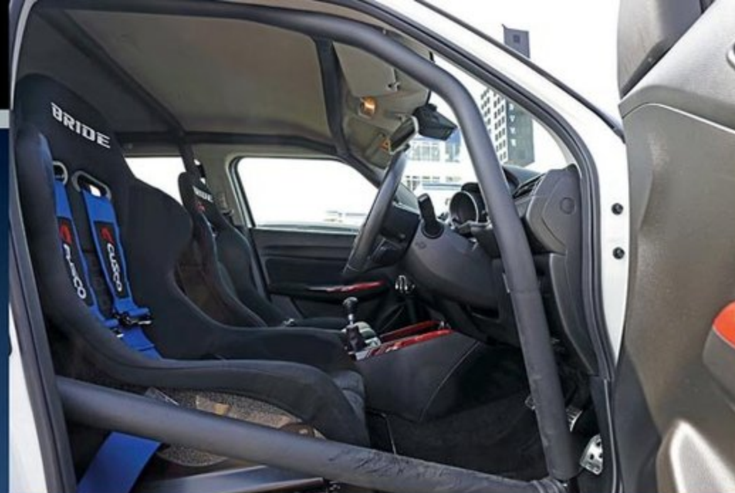
JAF公認競技などにも対応可能なスチール製のロールケージ。写真は5名乗車対応のダッシュ逃げ7点式にオプションのサイドバーを追加。リヤ4点から10点式まで用途に合わせて豊富にラインアップ(5万5000円～)されている。
