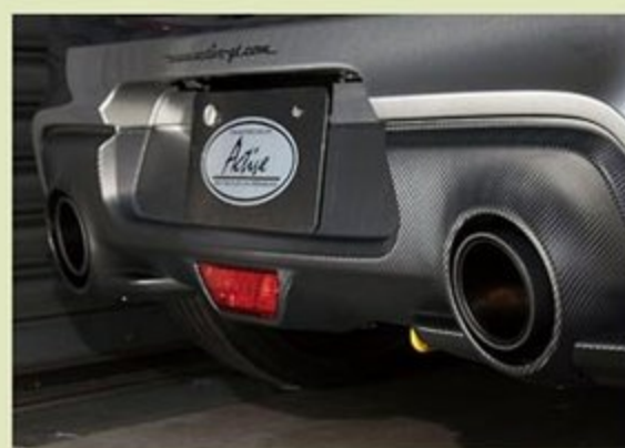
排気系はトラストのスポーツキャタライザーにフジツボのフロントパイプ&マフラーという構成。駆動系はオリジナルセッティングのクスコRS1.5ウェイLSD。剛性アップ系のパーツはリジカラとドアスタビのみだ。
