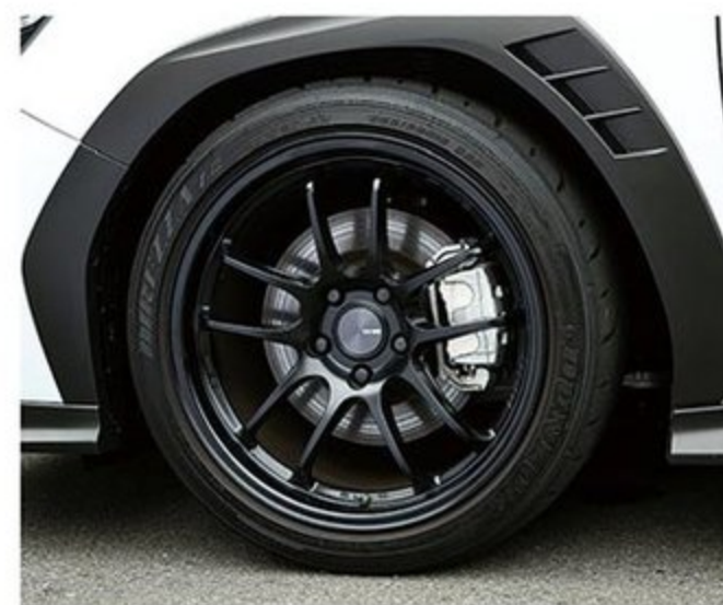
テスト車のホイール&タイヤは、エンケイGTC-02(前後9.5J×18 +45)にダンロップディレッツァZⅢ(前後265/35)の組み合わせ。ブレーキや車高調以外の足回りはノーマル状態となっている。
