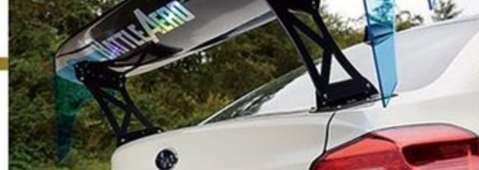
あえてシャシーマウントを避ける ウイングは「バトルエアロ」でアクリルの翼端版は「エアロウルフ」だ。リヤばかり目立ちすぎるのを避けるため、オーソドックスなトランクにマウントをチョイスしたそうだ。
