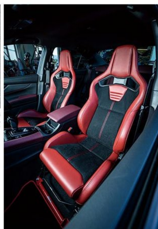
助手席は着座センサー、運転席はシートポジションメモリーが接続されていない場合はチェックランプ点灯となるVBHのシート交換。対策可能なハーネスキットを近日デリバリー予定だ。
