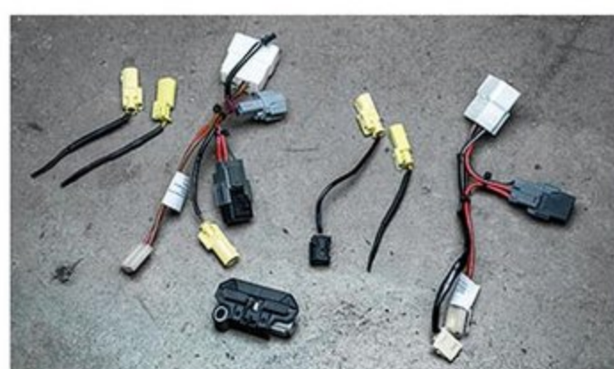
助手席は着座センサー、運転席はシートポジションメモリーが接続されていない場合はチェックランプ点灯となるVBHのシート交換。対策可能なハーネスキットを近日デリバリー予定だ。
