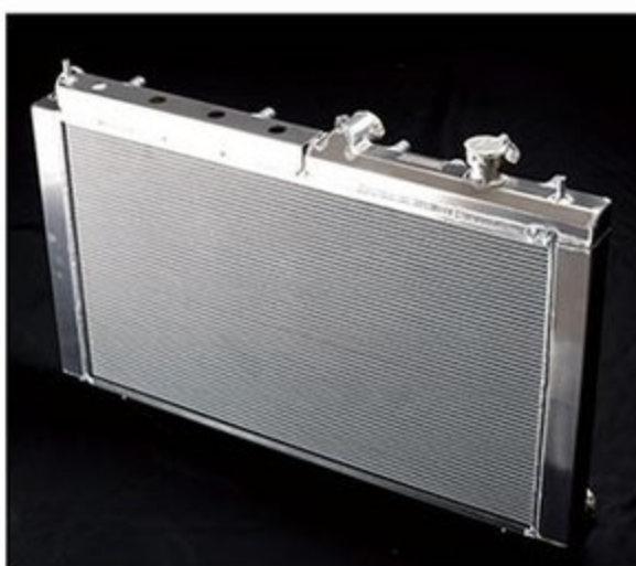
サイドタンク・ターンフロー方式を採用することで高回転での冷却能力を高める極ラジエターは、信頼のDRLにオーダーして作り上げた近藤氏のこだわりが詰め込まれたアイテム。オーバーヒートを抑えながら軽量化にも効果あり。価格：23万6500円
