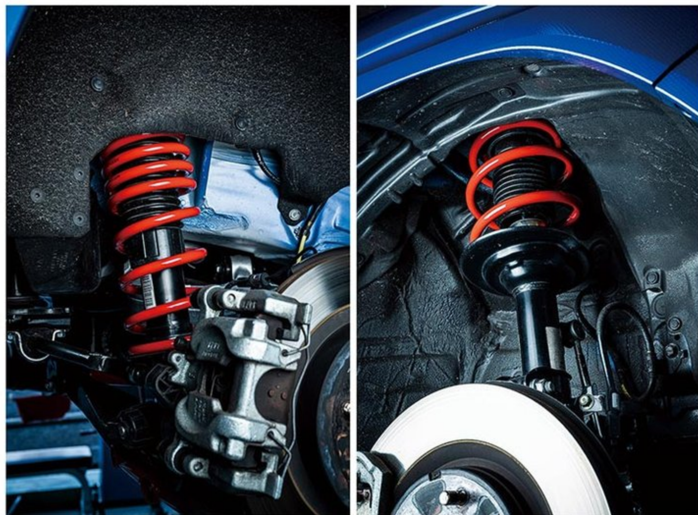
STIスポーツRに採用されている電子制御ダンパーにマッチング可能なスポーツローダウンスプリングを開発。30mmダウンでスタイリングを引き締めることができる。価格は4万8400円。
