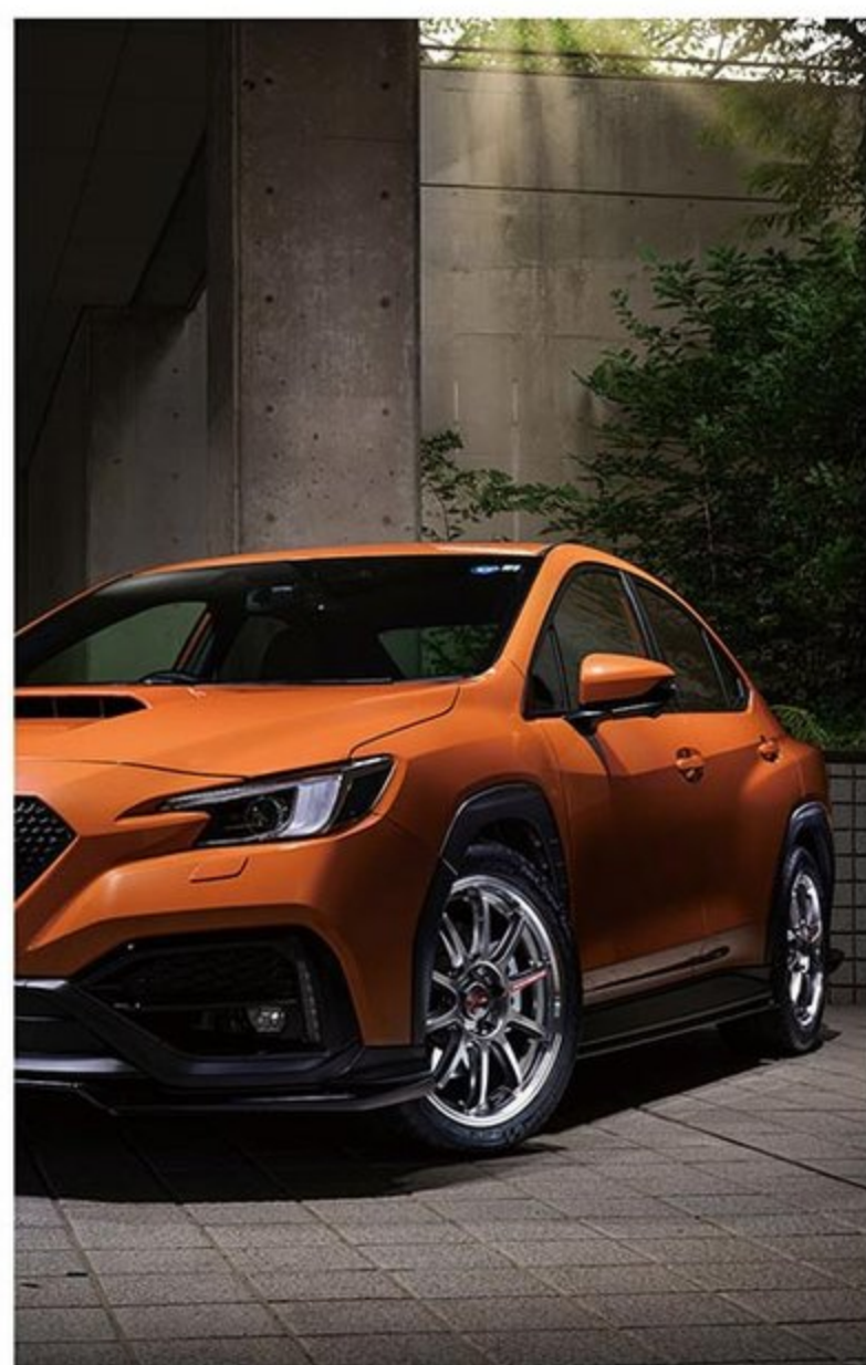
樹脂製のフェンダーモールが標準で備わるWRX S4は、意外とホイールの組み合わせが難しい車両でもあるが、RMPレーシング・R10は自然に溶け込んでしまうのだ。装着サイズは18×8.0J +45にミシュラン・パイロットスポーツを245/40R18で組み合わせていた。
