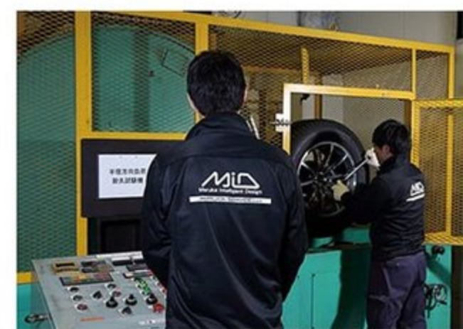
国内設計・海外生産のクロスオーバー体制でコストパフォーマンスに優れたスポーツホイールを生み出しているRMPレーシングシリーズだが、衝撃試験や回転疲労などの各種テストは国内で一元管理。安心して走ることができる頼もしさも自慢だ。
