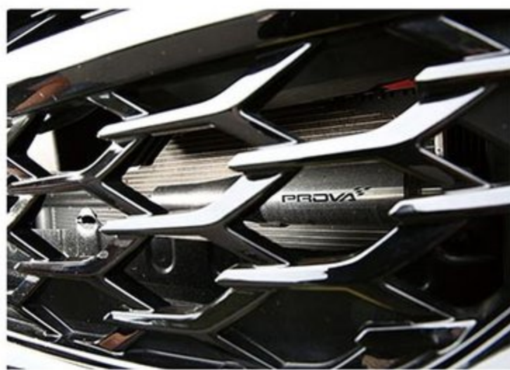
走行中に発生するボディの変形や振動を抑制する、アイシン製のモーションコントロールビーム(4万9500円~)を前後バンパー内に装着。前後のクロスメンバーカラー(各2万2000円)との相乗効果で上質な走りを実現。
