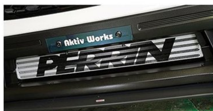
フロントバンパーに前置したインタークーラーを始め、ブローオフバルブなどはアメリカの「ペリンパフォーマンス」で統一する。
