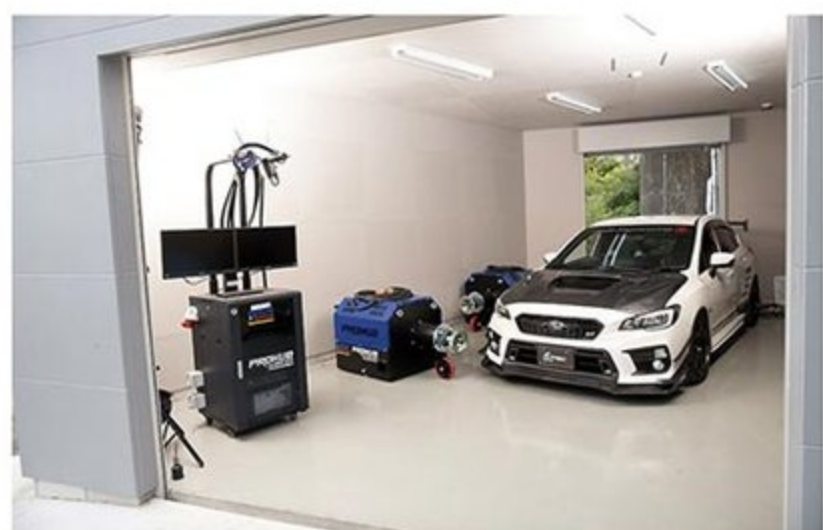
パーツ開発時のツールとして新たにプロハブ製ダイノシステムを導入。2000psまで対応するシステムは、今後パワーチューンが激化しても十分に対応できるキャパシティを備えているのだ。
