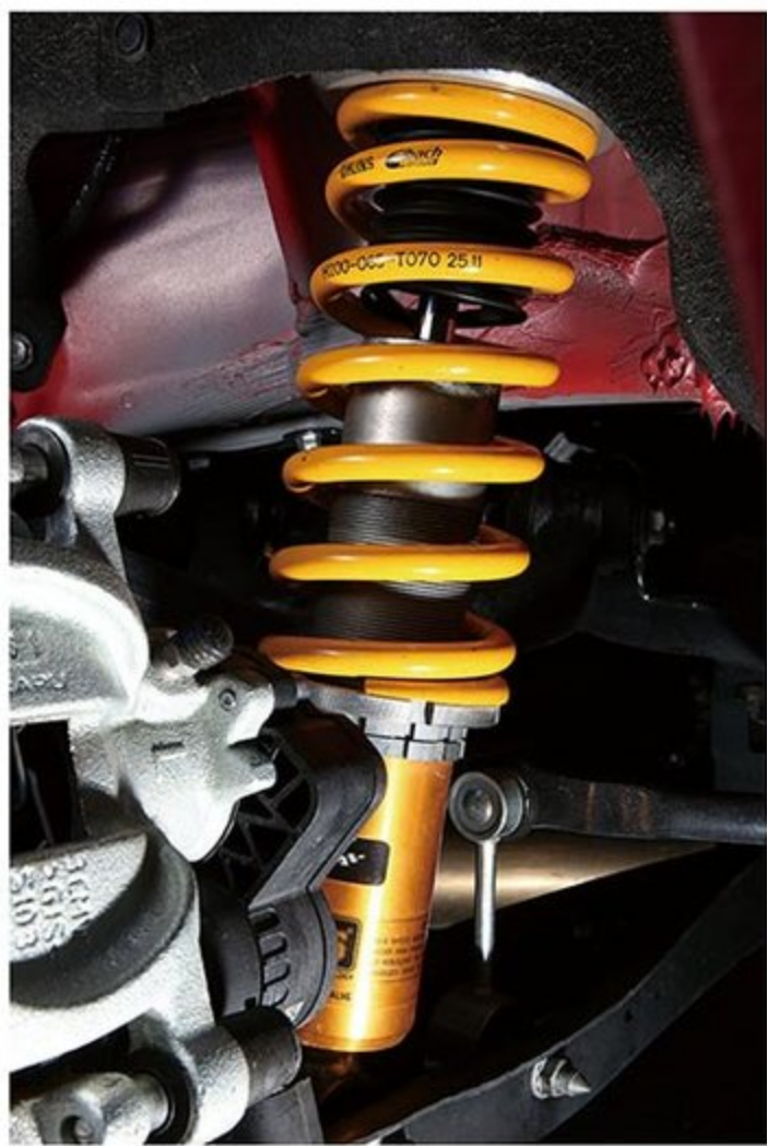
リリースに向けて開発中のオーリンズDFVベースのオリジナルサスペンションキット。ベース車の特性を踏まえ、より快適性も重視しながら幅広い走行ステージに対応を目指し、バネレートはフロント7kg/mm、リヤ6kg/mmでテストが進められている。
