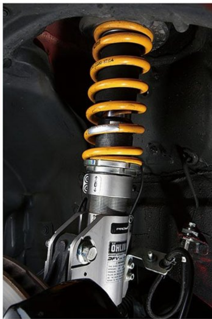
リリースに向けて開発中のオーリンズDFVベースのオリジナルサスペンションキット。ベース車の特性を踏まえ、より快適性も重視しながら幅広い走行ステージに対応を目指し、バネレートはフロント7kg/mm、リヤ6kg/mmでテストが進められている。
