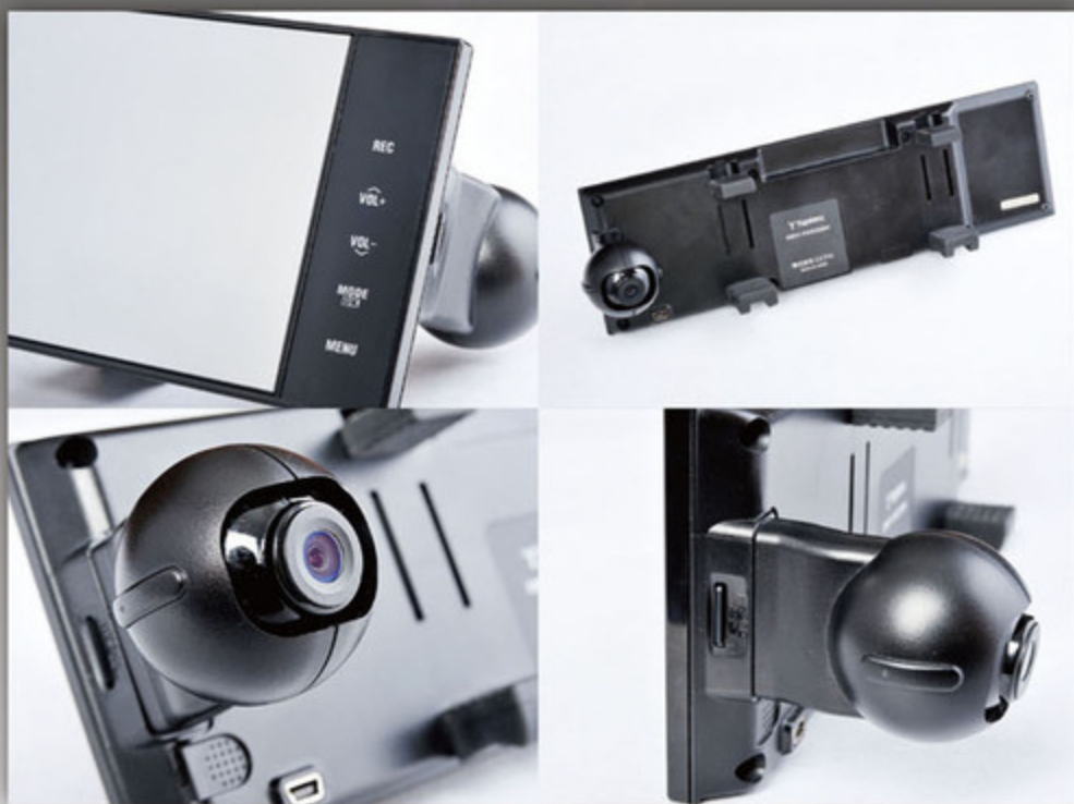
EyeSight ver.2のステレオカメラユニットの間に挟まれるカタチになるだけに、設置できるかどうか、EyeSightのエラーが起きないかの2点がポイントだったが、テスト中はエラーも出ずEyeSightのACCも機能した。
