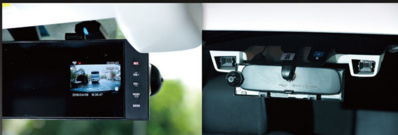
EyeSight ver.2のステレオカメラユニットの間に挟まれるカタチになるだけに、設置できるかどうか、EyeSightのエラーが起きないかの2点がポイントだったが、テスト中はエラーも出ずEyeSightのACCも機能した。
