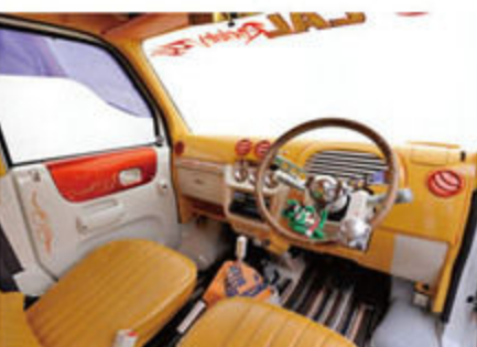
ダッシュまわりはFRPでワンオフ、吹き出し口はラバン用をチョイスした。フロアは自作でカーペットに張り替え。
