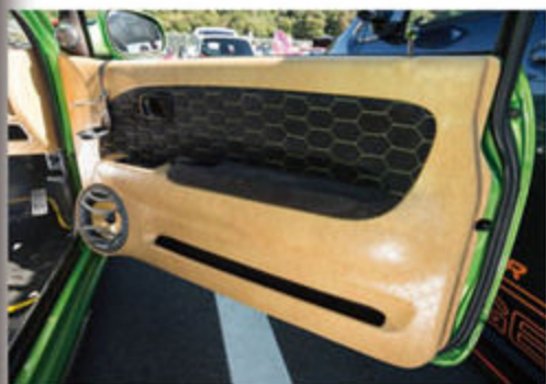
ドアトリムは型押し、内張には黒のアルカンターラにイエローのハニカムステッチを採用。
