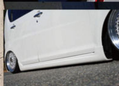
モードパルファムのサイドステップは15ミリ短縮加工。デザインは崩さずに、極低車高仕様へと変えている。
