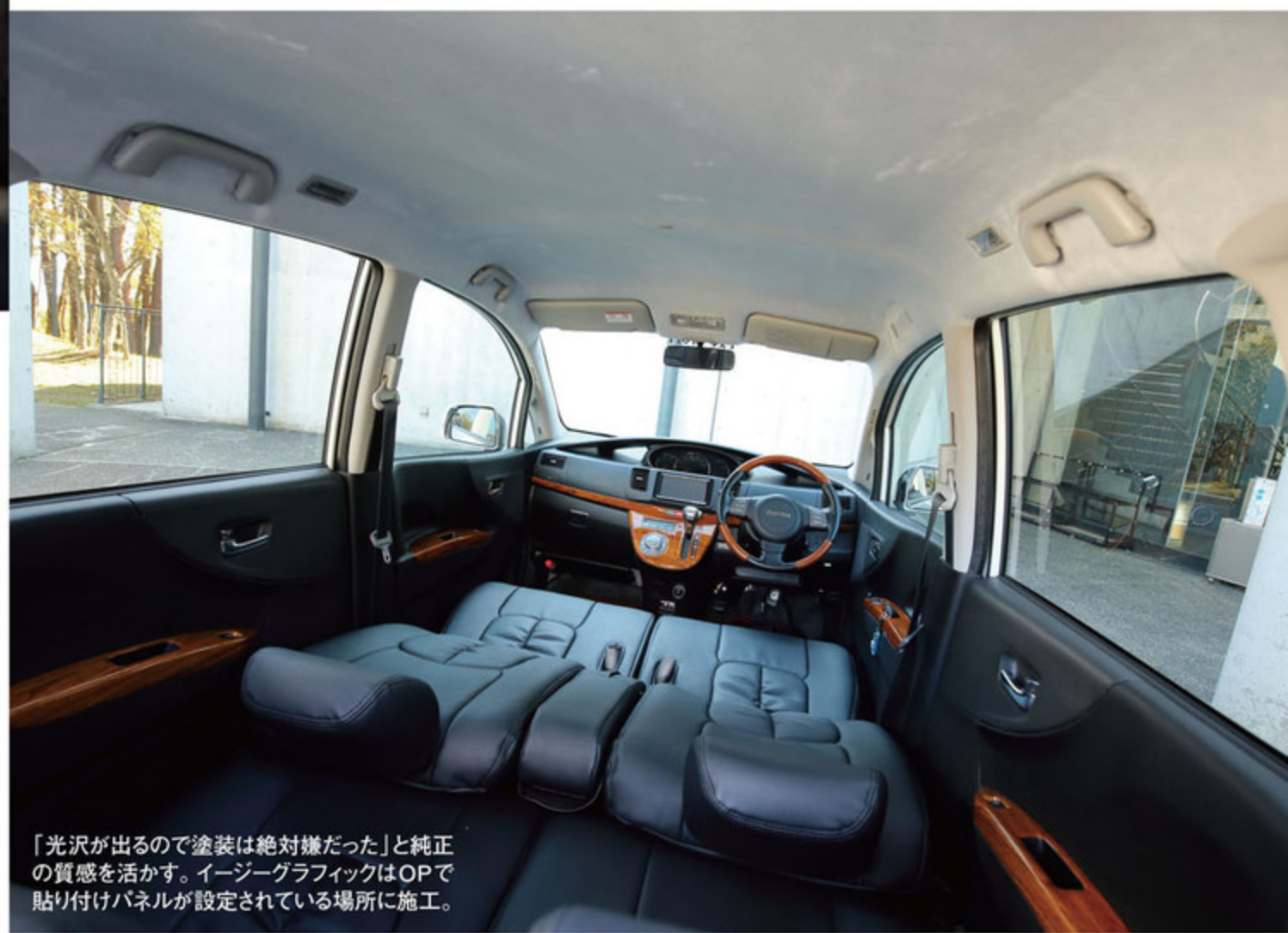
「張り替えるとAピラーにあるスピーカーの穴が消えてしまうのが嫌で」ピラー類は植毛塗装。そこまでこだわる。
