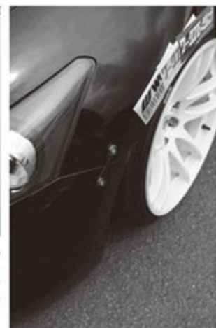
コレがウワサのフェンダーワッシャー。バンパーとフェンダー部分の両側に固定し、水道管などに使われるパッキンなどのゴムを利用して固定させている。
