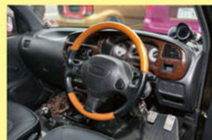
ステアリング、シートなどミラージュ用を移植し、クラシックな雰囲気の内装に演出。
