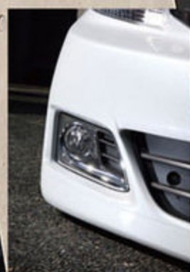
アルファード後期の純正フォグを枠ごと移植。「脱着式だし、開口部も一緒に外したら今風のミツ口になりますね(笑)」。
