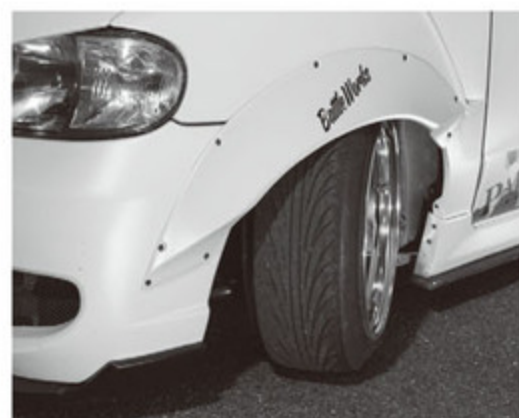
ハンドルを全切りした状態でギリギリに装着すれば、走行時でも接触する心配がない。走行にあわせたセッティングでS☆1攻略も!!
