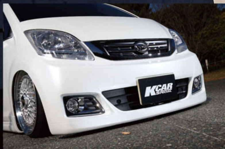
極低車高でも走れるようにフロントバンパーは2〜3センチ丈を詰める。純正感を高めるため、ヘッドライトのHIDも4500Kを選択。
