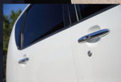
ドアノブは純正を外してメッキ加工。「カバーは多いけど、本物にメッキをかけた人って見たことないの」。
