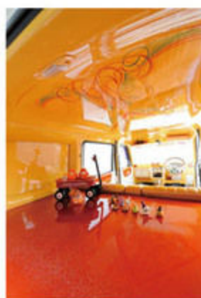
ダッシュまわりはFRPでワンオフ、吹き出し口はラバン用をチョイスした。フロアは自作でカーペットに張り替え。
