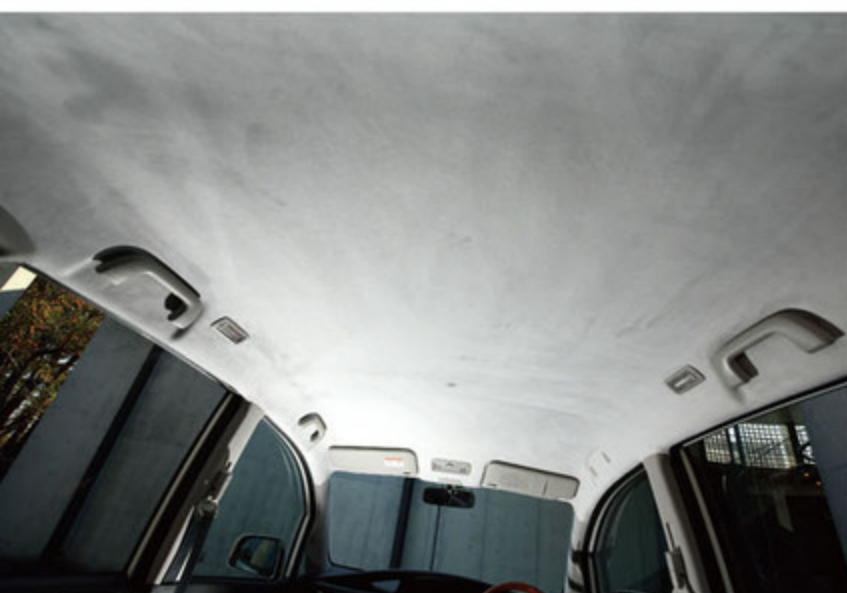
純正とほぼ同じグレーのアルカンターラで張り替えた天井。「パツと見て純正に見えるようにしたいなって」。
