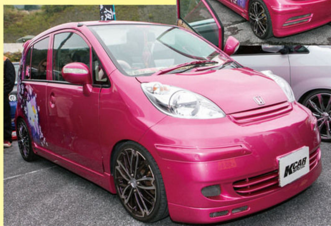
「好きなブランドなので」と3点バンパー、マフラー、ダウンサスをケイブレイクで統一。「少なくなっている」とドアはガルウイング化を施す。
