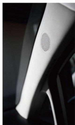
「張り替えるとAピラーにあるスピーカーの穴が消えてしまうのが嫌で」ピラー類は植毛塗装。そこまでこだわる。
