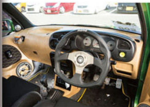
ダッシュやインパネまわりなど、ベージュの型押しレザーで張り替え。明るく個性的に。
