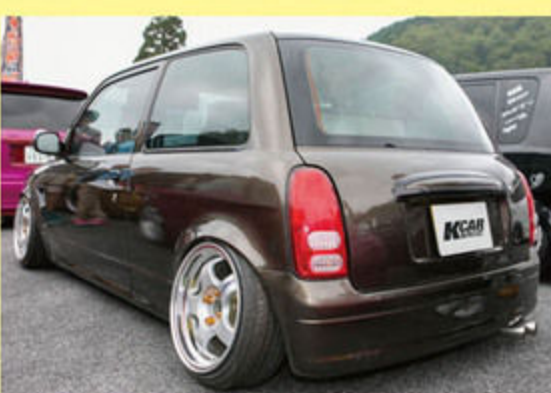
純正バンパーながらフェンダーにダクトを入れるなどアクセントを追加。エンジンメンバー上げ、インナー加工などを施しローフォルムを構築している。
