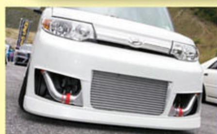
S14シルビア用インタークーラーをセット。「ワンオフパイプで繋げています」。
