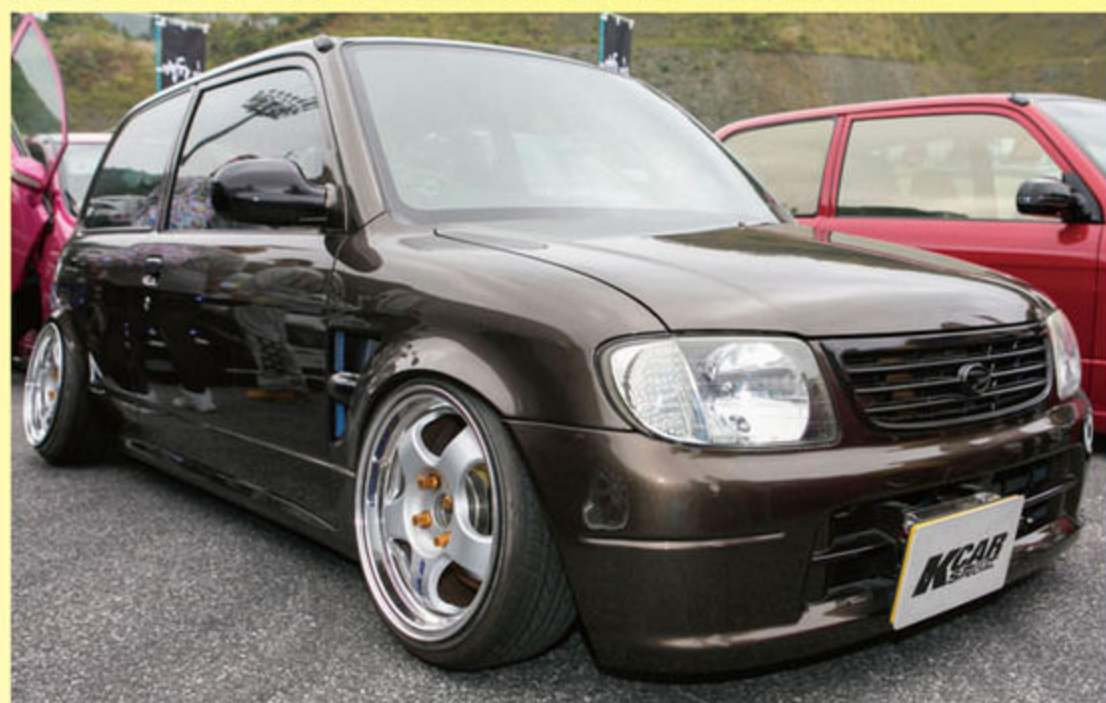
純正バンパーながらフェンダーにダクトを入れるなどアクセントを追加。エンジンメンバー上げ、インナー加工などを施しローフォルムを構築している。
