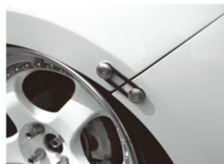
コレがウワサのフェンダーワッシャー。バンパーとフェンダー部分の両側に固定し、水道管などに使われるパッキンなどのゴムを利用して固定させている。
