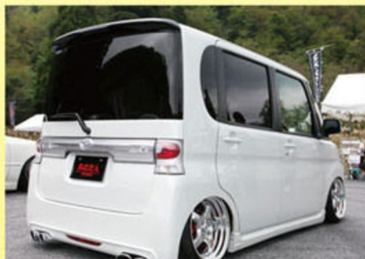
3点バンパーはプレジァティシモを加工。リアにはアウディのバッグフォグを移植した。ワンオフフロアアームで低いままでも走れるように。
