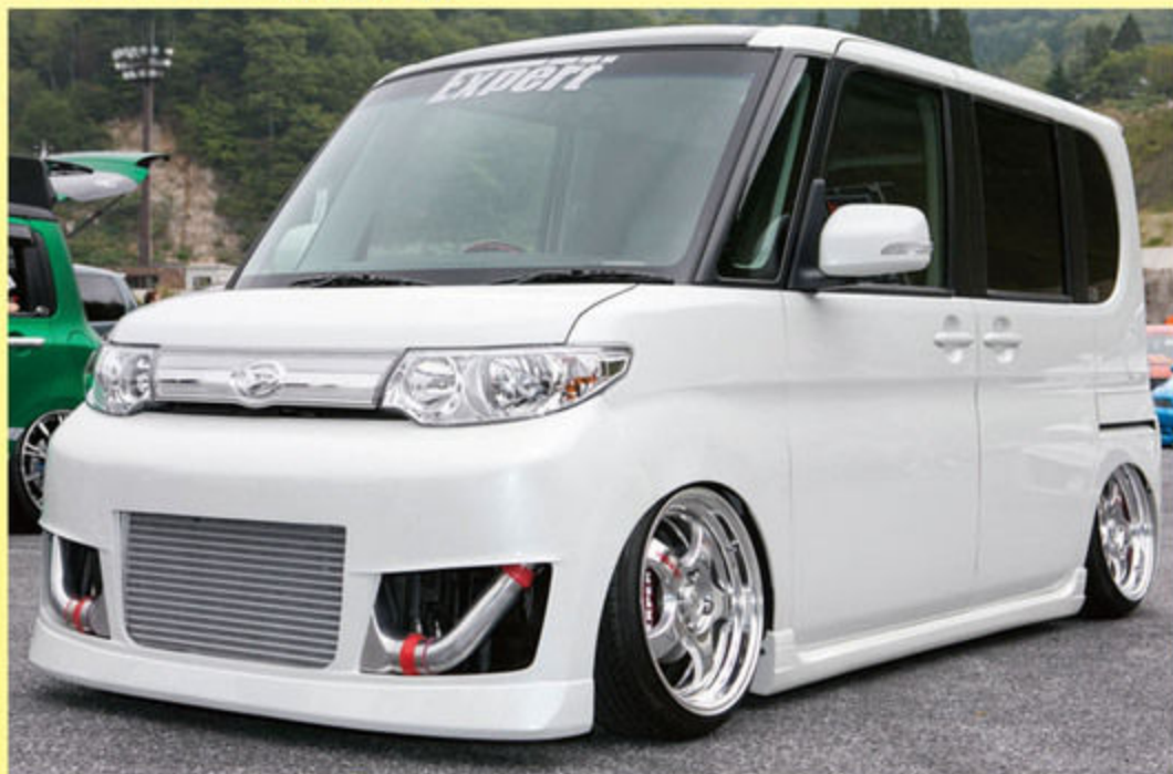
3点バンパーはプレジァティシモを加工。リアにはアウディのバッグフォグを移植した。ワンオフフロアアームで低いままでも走れるように。
