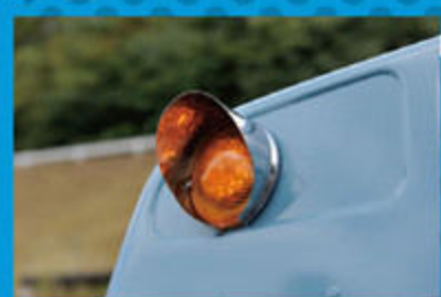
ブローのダミーライトをLED加工してセット。「ダミーより、せつかつなら光らせた方がいいかな」と。
