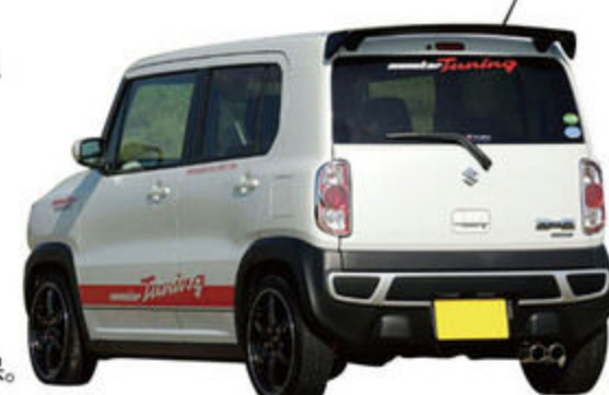
↑3次元曲面を巧みに操ったリアスポイラー。高速走行時の直進安定性を確保。
