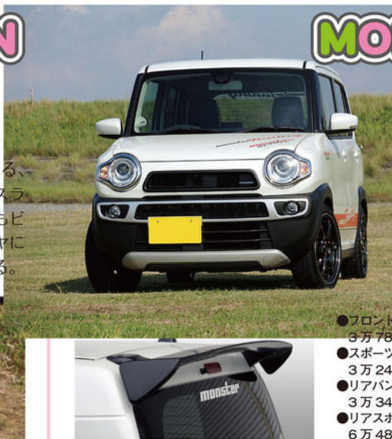
↑3次元曲面を巧みに操ったリアスポイラー。高速走行時の直進安定性を確保。
