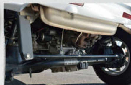
リアの車軸付近にエンジンを持つ。ブロックを噛ませたラテラルの奥に、その姿がパッチリ見えている。マフラーも配管を若干延長してテールエンドを見せる仕様に。
