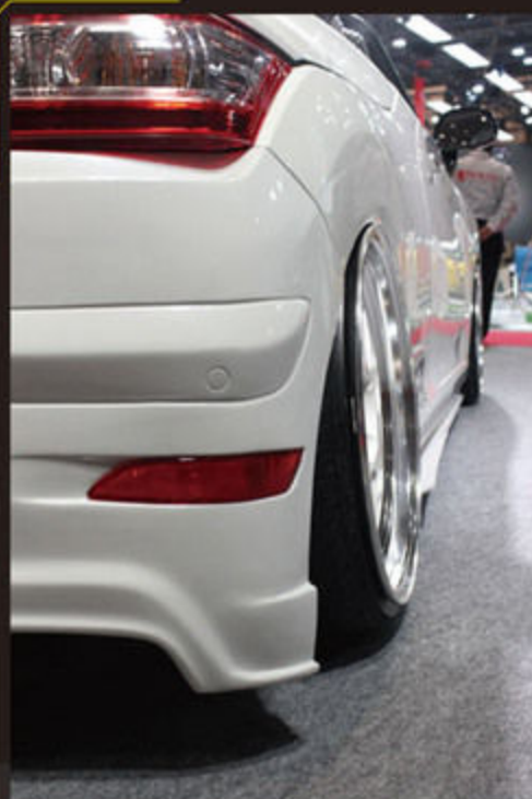
リアアクスルはジェーラインで現物加工。ダウン量は40mm、キャンバー角は5度の仕様。
