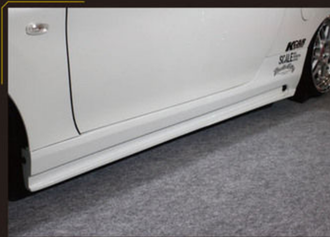
サイドステップは基本的なデザインはそのままにホイールベースの短いコペンに合わせて短縮。
