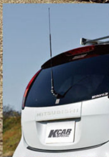
リアゲートには無線機のアンテナ。土台は市販品を分解して製作。リアワイパーを取り付けるボルトを利用して固定している。
