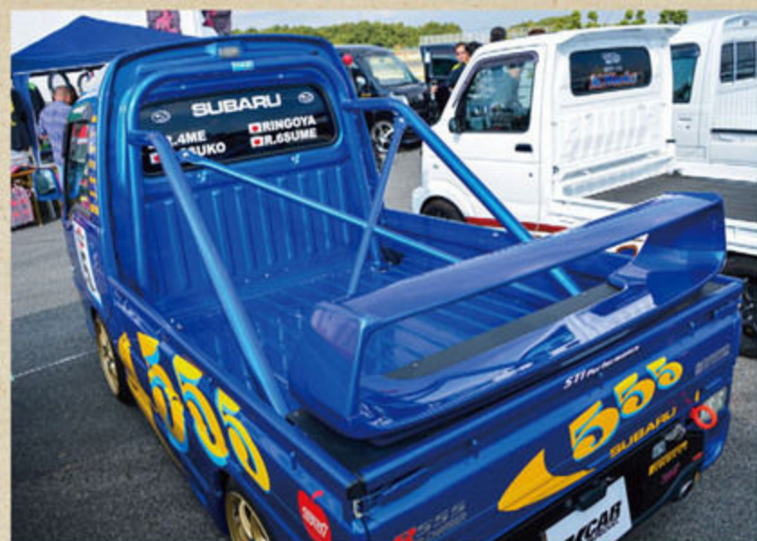
インプレッサの純正ウイングを、加工して取り付けたのもキモ。より走りを想起させるため、ロールゲージをワンオフ。テールは「555」と光るように。
