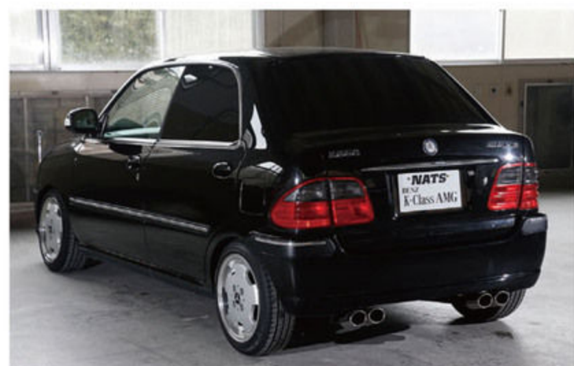
4本出しマフラーは純正のタイコからパイプを左右に分岐させ、オーバル型カッターを溶接。しっかり排気するのがポイント。足まわりはミラ用の車高調。
