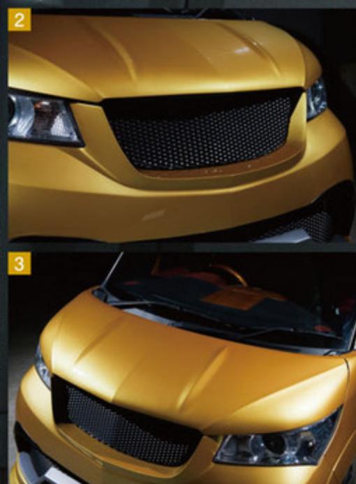
1 エアロのベースはプレジアティシモ。ただし、使ったのは付け根だけ。デザインはすべて発泡ウレタンで起こし、ボリューム感もワイド感もすべてオリジナル。2 大きく前方へ突き出たグリル。「らしさ」と同時にスポーティさも。3 ボンネットは縦に2本、斜めに2本のライン。これも「ベンツ風」を強く意識した作り込み。
