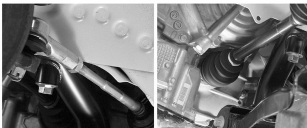
ドライブシャフト(右)とはエンジンが動くことで生まれる回転をタイヤに伝えるための部品。対してタイロッド(左)はハンドル操作に合わせてタイヤを左右に動かすための棒を指す。バンザイ状態を根本から修正するにはエンジンを上げるといふ手もあるが、得られる効果を考えれば現実的ではないかも。
