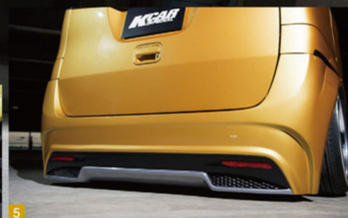
4 サイドステップはバタフライシステム。バンパーのサイズはこれが基準。5 本来はテールレンズ下がもっと垂直に落ちているプレジアティシモのリアバンパー。なだらかなアールを付けているのもこだわり。台形ラインもそれっぽく。
