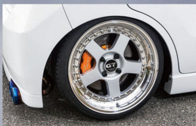
足まわりはディメンタ車高調&シェーライン・リアアクスルで構築。「前に付けていた車高調と比べても、小さい段差をひらなくなりました」。
