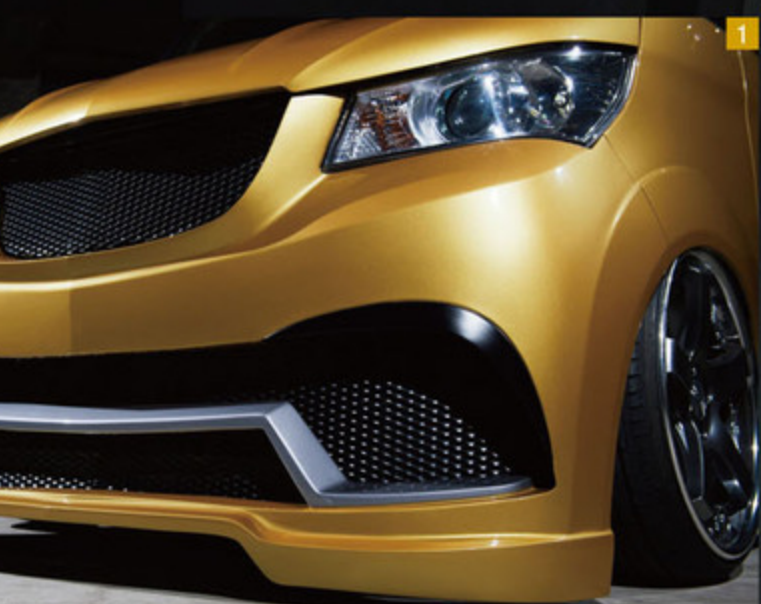
1 エアロのベースはプレジアティシモ。ただし、使ったのは付け根だけ。デザインはすべて発泡ウレタンで起こし、ボリューム感もワイド感もすべてオリジナル。2 大きく前方へ突き出たグリル。「らしさ」と同時にスポーティさも。3 ボンネットは縦に2本、斜めに2本のライン。これも「ベンツ風」を強く意識した作り込み。
