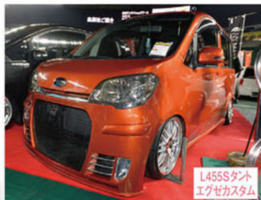
フロントにクライス(L175S用)、リアにはCLSアニバーサリー(MH23S用)をニコイチ。違和感のない作り込みは、技術の高さを物語っている。
