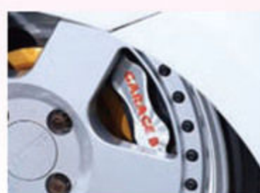
オリジナルアックスルでリアもディスクブレーキ化。前後ともウィルウッドキャリバー&ウェーブローター。
