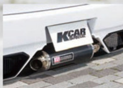
友人から譲り受けたヨシムラの2輪用マフラー。サイレンサーを見せるようリアバンパーを造形している。
