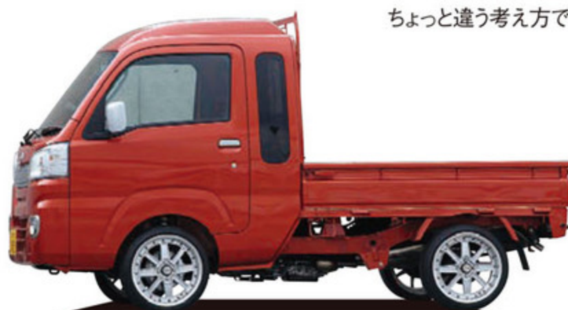
写真は16インチのSSRホイールを履いたS500Pハイゼット。純正サイズは12インチだから、その印象はかなり変わる。
