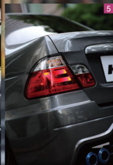
4「サイズと形状を一番考えて」辿り着いたのがBMWのテールレンズ。「トランク側まで食い込んでるのも絶対でした」。5トランクの延長は約15センチ。そのおかげでセダンのように前後の均整が取れたフォルムに変わった。
