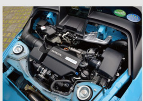
Nシリーズに搭載するエンジンに、S660のためにレスポンスを高めた専用開発のターボを組み合わせた。
