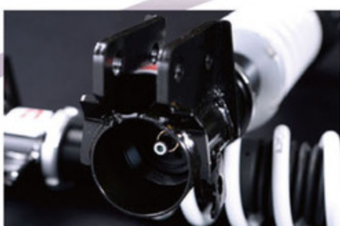
減衰力は20段階調整。リアシートの乗車人数や積荷などさまざまなシーンに対応できる。
