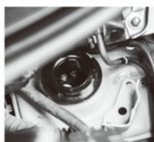
実際に取り付けけた状態は普通の全長調整式車高調。センターロックから見えるキャンバー調整部が見どころ。
