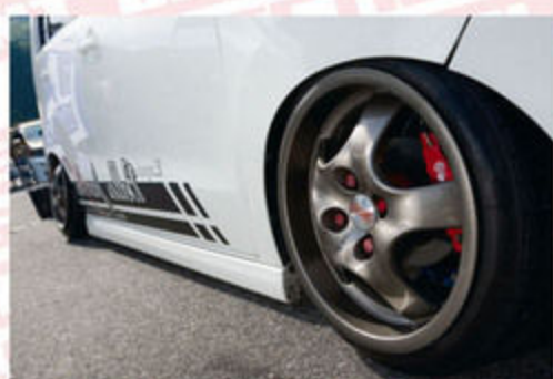
RS-R車高調と純正を加工したロアアーム&アクスルを組み合わせ、限界までツラを攻めた。
