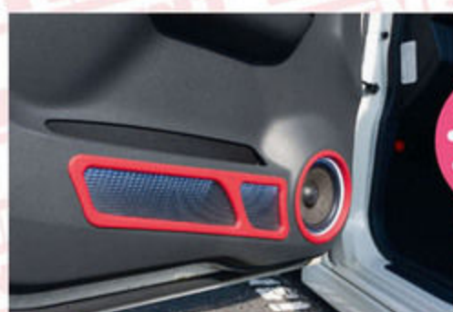
ドア内張りにグラウンドゼロのスピーカーをセット。その横にはブラックホールを製作。
