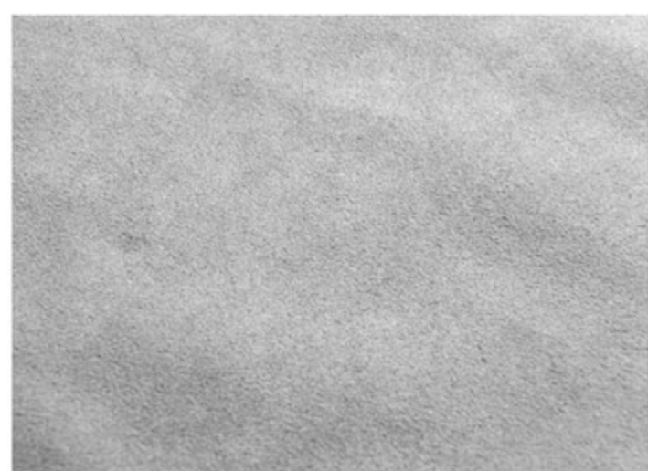
アルカンターラに代表される人工起毛は、毛羽立った表面が特徴。この質感はレザーには出すことができない。ただし、何度も何度も擦れていたりすると、そこだけが劣化するという点も。
