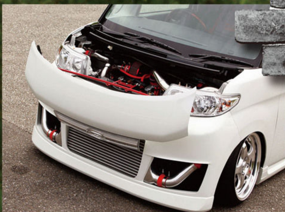
パイピングを作ったからエンジンを見せたい。「でもボンネットを普通に開けるのはつまらない」と、スラムドボンネットを製作。
