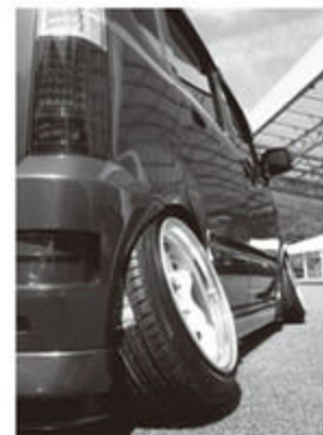
写真のリアキャンバーで約20度。少し見えるフロントキャンバーでも約17度の設定。
