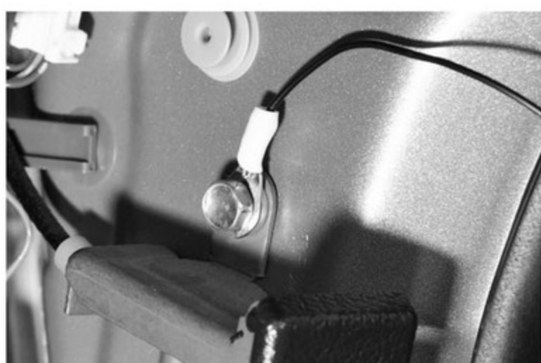
ボルトでアースを取る場合は、クワガタ端子がしっかり噛むように。なお、外装のアースはボディアースでOKだが、内装は直接配線に割り込ませるという手を使う場合も。
