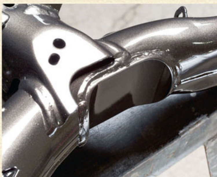
ダイハツ車で6.5J以上のホイールを履く場合、インナーリムとアクスルのアーム部が干渉する。そこを凹ませておくのが逃げ加工だ。
