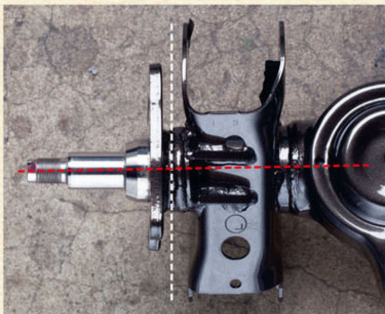
見てもほとんど分からないが、ジェーラインアクスルはローダウンを見越し、ほんの少しだけトーアウト気味に設計されている(写真はロータイプ)。
