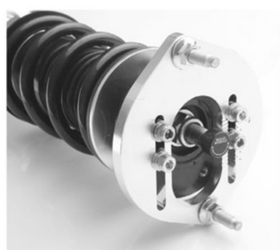
アッパーマウントから突き出たロッドの頂点をまわして減衰力を調整。ただし、調整ダイヤルがどこにあるかはアイテムによって異なる。
