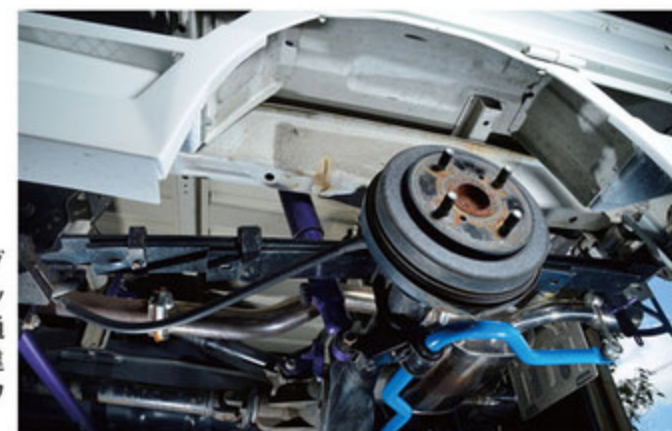
軽トラのリアスプリングはリーフタイプ。ブロックを使用するなど、通常のスプリングとは違った落とし方のノウハウが必要となる。
