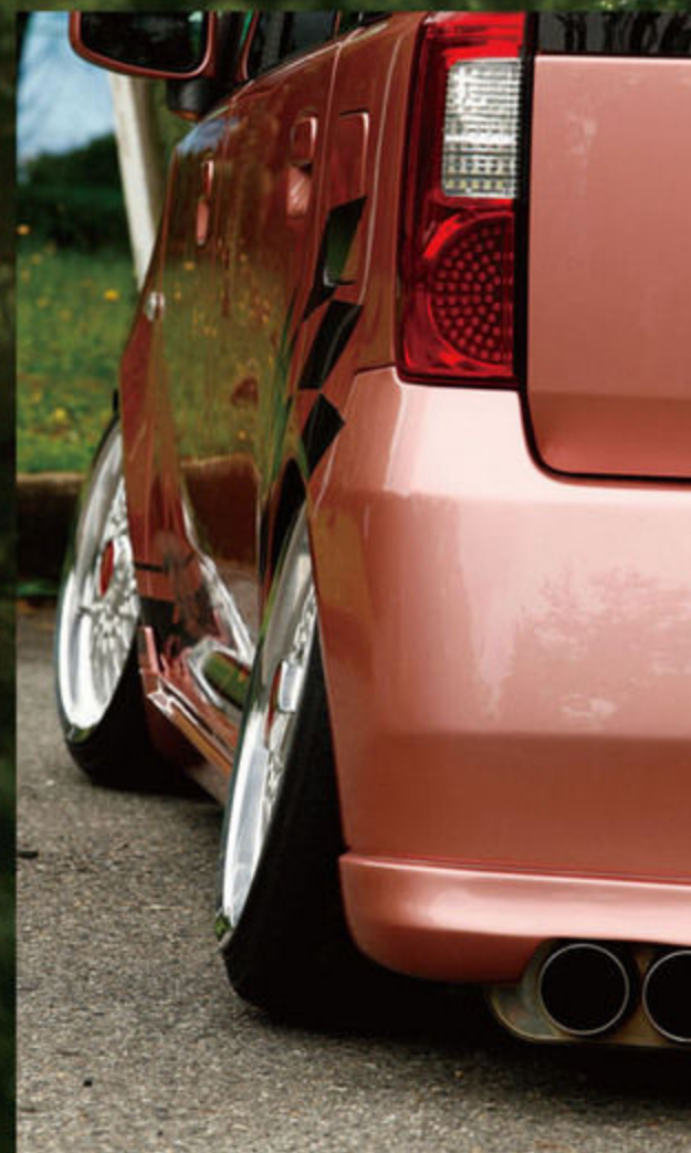
フェンダーは純正のラインを消し、ナチュラルにワイド化。アクスルは純正を鉄工所で加工して角度を付ける。
