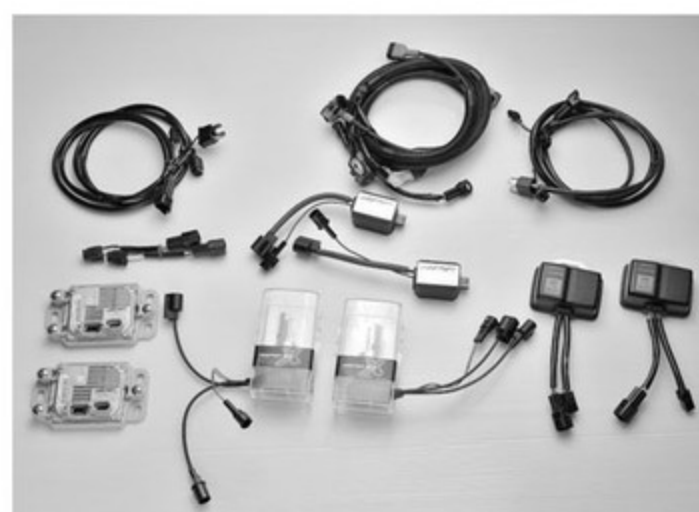
ハロゲン灯をHIDへと変える場合は、バルブだけではダメ。バラストなども取り付ける必要がある。ただし、最近ではすべてカプラーオンで接続できるような「簡単取り付け」のアイテムもあり。
