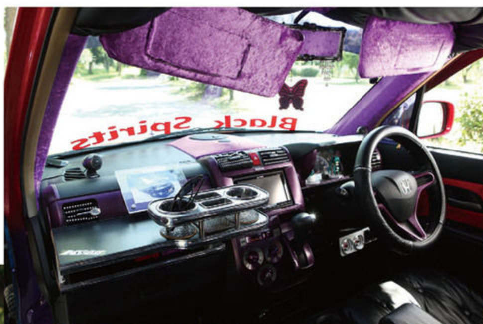
バイザーやビラー、センター部分にレイアウトしたスピーカーなど、外装にあわせて紫の生地で張り替え。インパネやステアリングなどは塗装。
