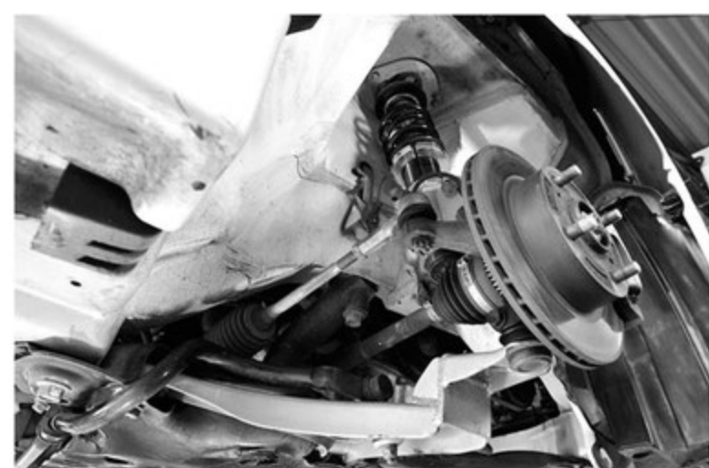
例えばショック周囲の出っ張りや天井の低い部分などを一旦切り取って、上げた状態でキレいに溶接するのが「切り上げ」。対処療法に終始すると、下げるたびに加工が必要になることも。
