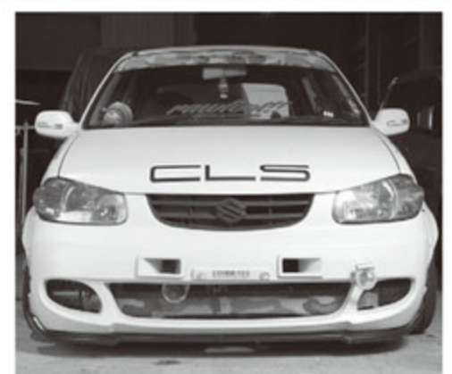
バンパーと別体のアンダーフラップが色分けされているESBデモカー。バンパーは小振りなタイプだが、アンダーフラップを装着することでかなり低さをアピールできる仕様になっている。
