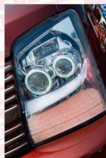
乳白のアクリルを使ったヘッドライト。ウインカー部分にはレーザーでヒョウ柄を入れアクセントに。
