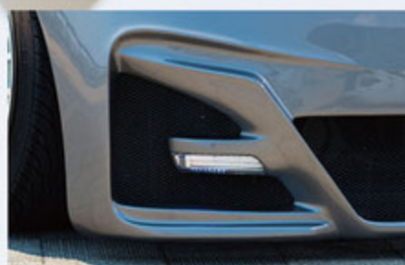
フォグ部分に移植したのは30プリウスのウィンカーミラー。少し浮いたような感じが新鮮。デイルイトとしても使える。
