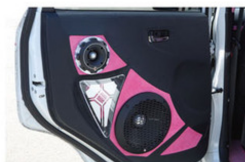
ピンクの生地で張り替えアウターバッフル化したスピーカーアレンジに、アクリルやアルミプレートを使ったドアパネメイク。
