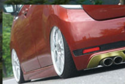
ACCのエアサスは下げ幅を改良した特注仕様。アクスルは2セット目で、今回はジェーラインを選んだ。
