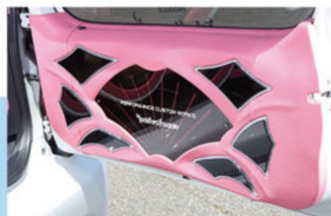
ゲート内側部分にはアクリルやLEDを使い、オーディオのボリュームにあわせてLEDが動くギミックを搭載。まわりはピンクレザーで張り替え。
