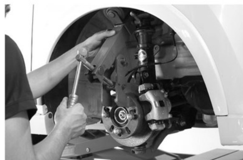
ツメ折り機でフェンダーのツメを折っている最中の様子。車高を落として走るのであれば、フロントのツメ加工は必須とも言える。最初の段階で施工は考えておくのも良いだろう。
