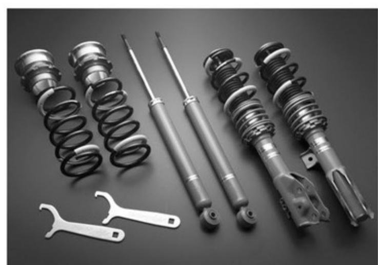
一見すると同じように見える二駆用と四駆用の車高調。しかし、四駆用でない場合、「共用」という表記がなければきちんとした性能を発揮することができないと思っておいた方が良いでしょう。
