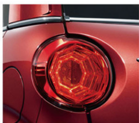
丸型のテールランプはLEDを使うが、スタイルでは前面がレッドになる。クッキリと見えて後方からの視認性も良好だ。
