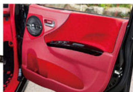
レザーとエクセーヌの張り替え、そして植毛塗装を使い分けて製作している。「張り替えは、自分たちでやりました」。
