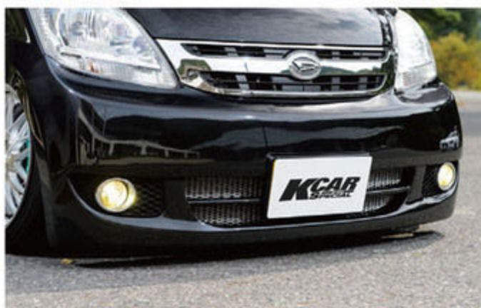
フォグの大きさや位置、ナンバー枠など、エアロのデザインはセダンを意識。バランスを考えて、丈は4cmほど短縮している。
