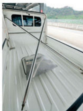
横方向へのねじれを解消するために装着したロールバーは、ステンパイプで自作。
