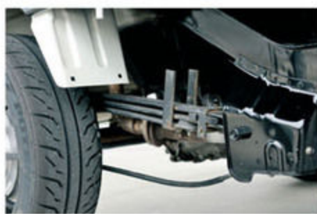
フロントの車高調はシュビーゲル、リアは純正リフを組み替えて固めな乗り味に。
