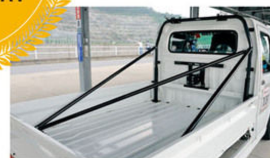
体感できるほどボディの剛性が強化されると同時に、ファッション性までアップするGTカープロデュースの5点式ロールバー。
