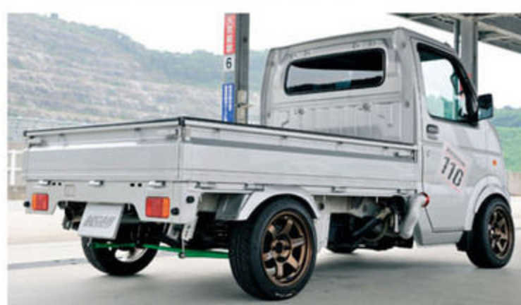
逆アライズを履かせたく、TE37は前後6.5J・インセット14。ブラックスオーバーフェンダーを装着してツライチで合わせた。
