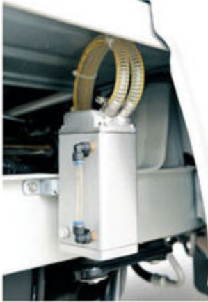
スクエア型のオイルキャッチタンク。スペースがないためフレームに固定。
