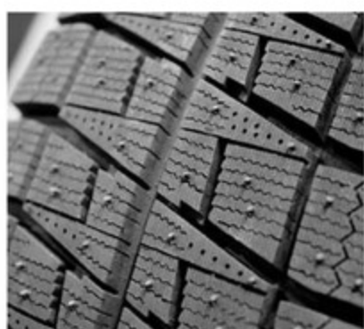
スタッドレスタイヤは表面が固くなってきたら交換のサイン。指で押してみれば全然違うのがわかるはず。
