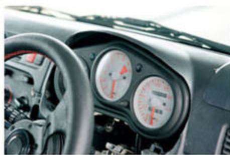
エンジンがビートなので、同時にメーターもビートの3連タイプに付け変えている。
