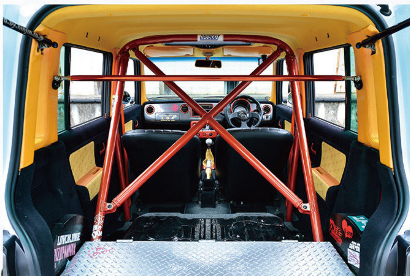
シート裏のロールバーはサイトウロールゲージ製。ただし、インナーを触ったせいで既製品が付かず、結局加工して装着したという。
