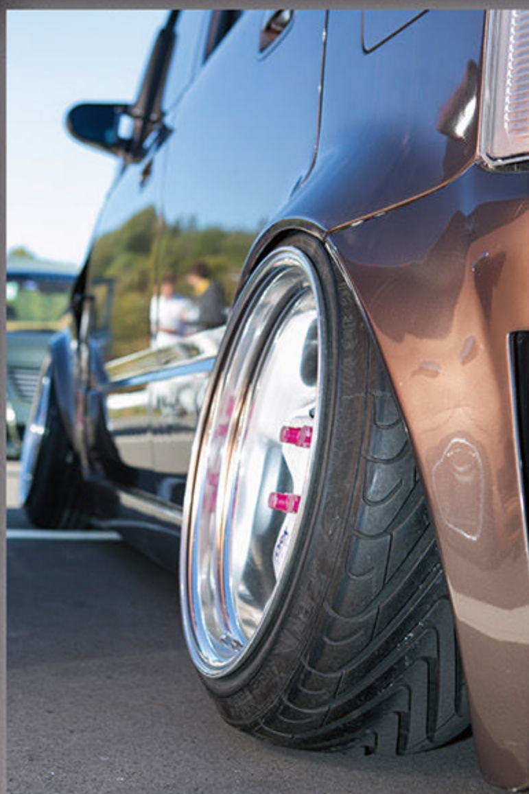
滑らかに膨らませ、なおかつスソを大胆に絞り込んでドッシリ感を強調させるワンオフのオバフェン。ギリギリのツライチも見どころだ。
