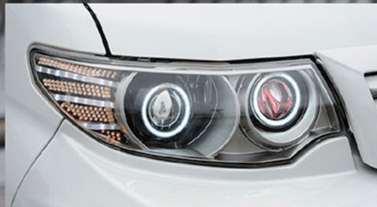
E92のプロジェクトにイカリングを添え、インパットを底上げ。ウインカーはアクリルのフィンを加え、E60後期風にアレンジした。
