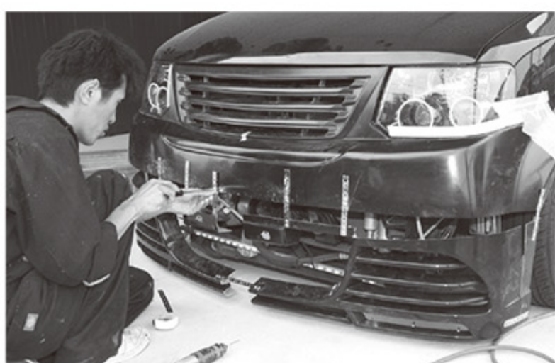
基本は付け根を含む上側と、開口部デザインを残した下側の二つをくつつけるのがニコイチ。しかし、幅やアールの違いによってリップを縦に割って延長したり、ラインを変えるという作業が必要になることもある。
