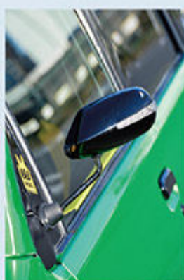
ムーヴ用の取り付け台座の形状が気に入らず、三角窓を埋めてスッキリと装着したBEE FREE製コンベミラー。
