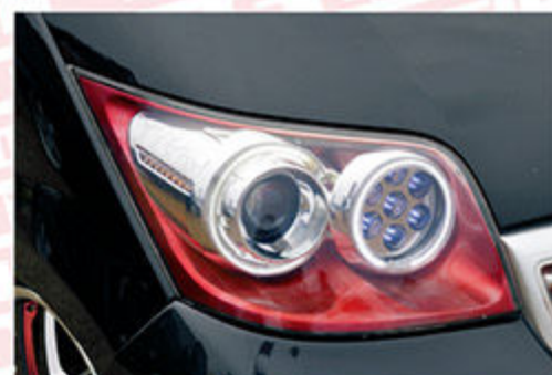
インナーをレッドで塗装したライトは自作。ハイ側にはバルブプロジェクターも仕込む。
