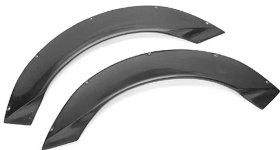
最近流行のビス留めオーバーフェンダー。確かに取り外しはできるかもしれないが、構造変更をせずに走っていると高速道路の料金所止められるなんてことも(Kカーと普通車では金額が異なるため)。リスクに関しては挑戦前に整理しておこう。
