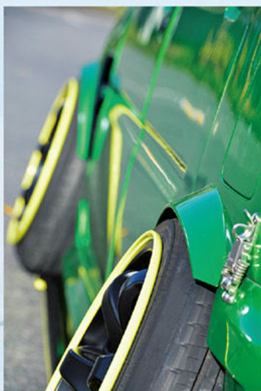
リアは鉄板溶接で造形したオーバーフェンダー。キャンバーはムーヴにいい角度を求めながら調整したら前5度、後11度だった。
