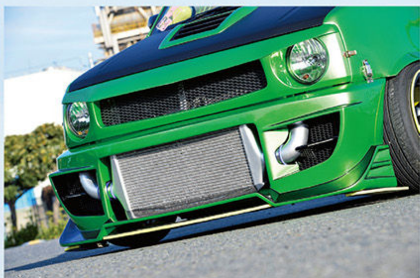
フロントは「ラルゴ」の時代にも付けていたというステージ21製バンパーを加工し、インタークーラーを配置。
