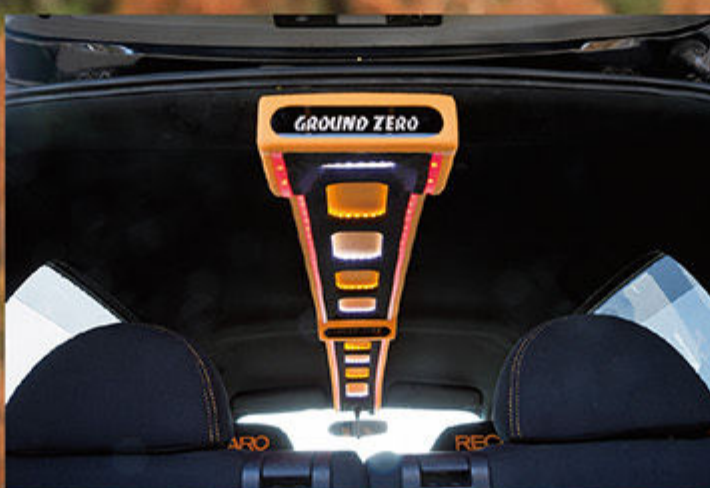
内装はフル張り替え。ルーフセンターにはワンオフ製作によるブリッジ状のLEDバーを装着。両脇からLEDの光りが流れる。
