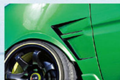
元々装着していたステージ21のFRP製フェンダーダクトをベースにフロントはFRPでオーバーフェンダーを製作。
