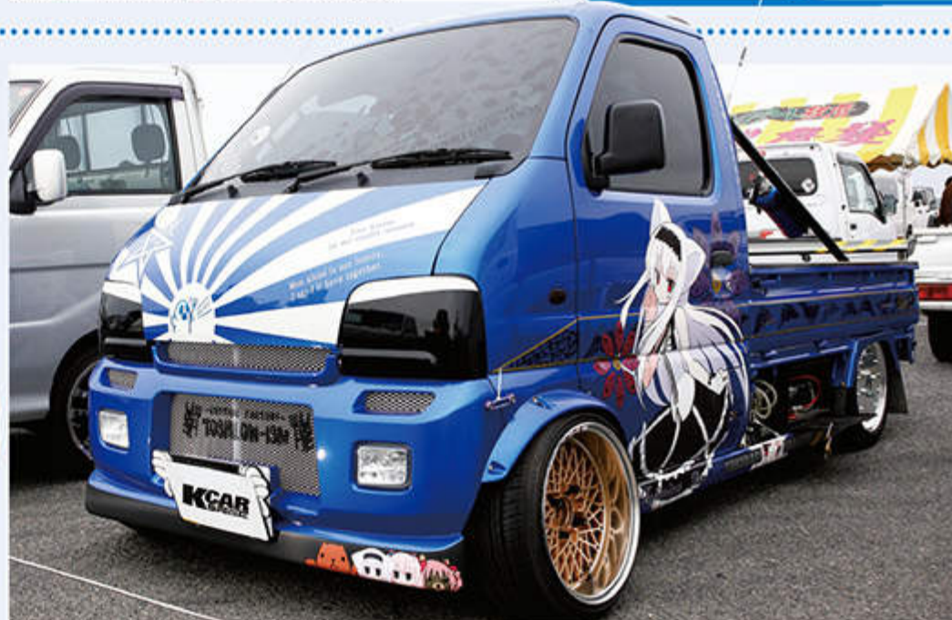
一般にローダウンに向きとされている4WDモデルをベースに、地上高2cmを実現させている。
