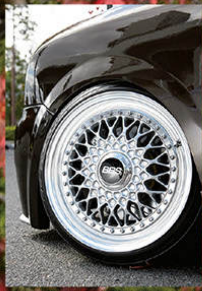
高級ホイールの代名詞、BBS RS。全バラして組み換え、ディープなリムを実現。磨きを入れてピカピカに。
