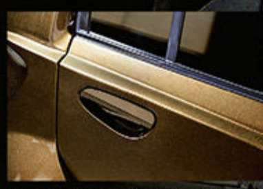
ドアノブはフェンダーとツラにして自然に。その上のクッキリとしたプリスターラインが、迫力を底上げ。
