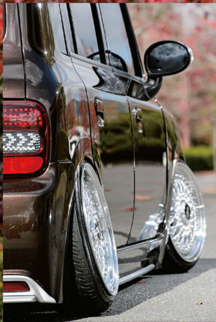
フロントは日正タイヤ、リアはバルファムの車高調でダウン。グロスラインオリジナルアクスルは、キャンバーと上げの調整が可能。
