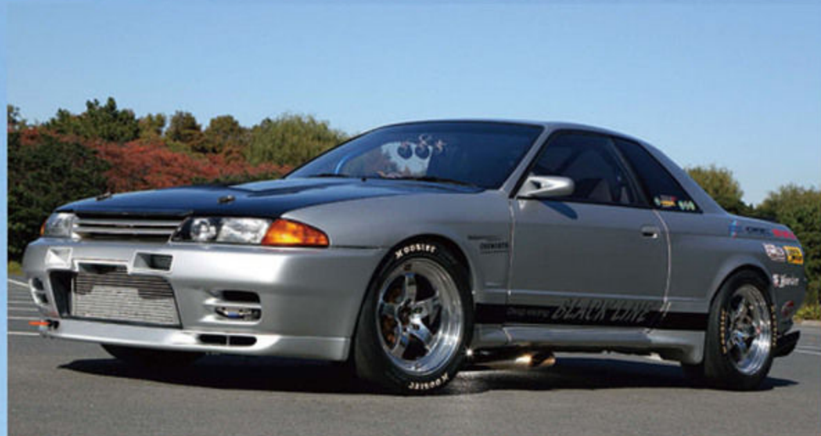
機関系はブラックラインにおまかせだけれど、カーボンボンネットやリヤスポイラーの交換、ステッカー施工などは自分で行うなど、オーナーもクルママイジリを楽しんでいる。ちなみにこのフージャーDOTドラッグラジアルはレース用で、普段履きはBBS-LMの10J-18インチにポテンザRE11。
