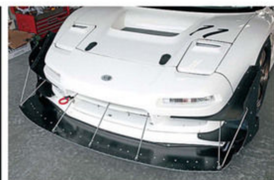
リップの延長、リヤディフューザーのリメイク、アンダーフロアのフラット化などエアロ性能向上も目指してきた。リヤディフューザーの効きを安定させるには、縦方向のフラップが欠かせないが、まだセッティングが定まっていなかったため、高さ調整をスライドできるようにしてきている。
