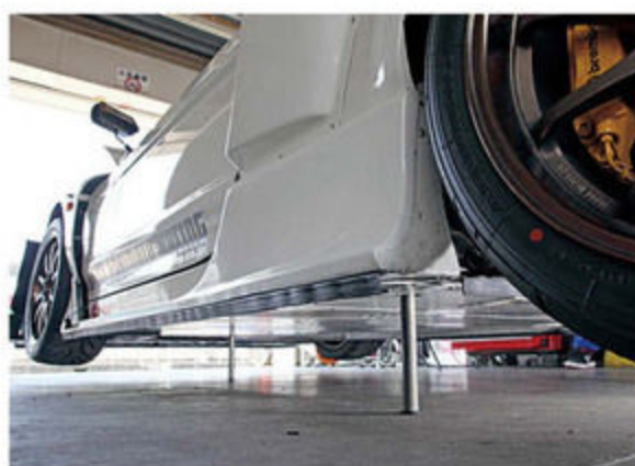
チェックを繰り返したことにより、計らずも活躍したのが、追加装備したエアジャッキ。メンテナンス性は大幅に向上した。
