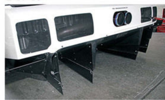
リップの延長、リヤディフューザーのリメイク、アンダーフロアのフラット化などエアロ性能向上も目指してきた。リヤディフューザーの効きを安定させるには、縦方向のフラップが欠かせないが、まだセッティングが定まっていなかったため、高さ調整をスライドできるようにしてきている。
