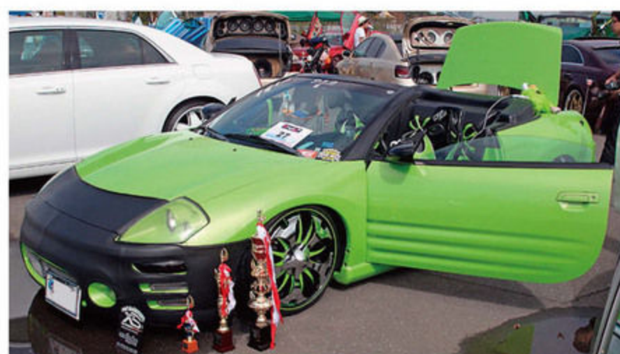
サイドシルとドア内装を加工してスピーカーを増設。シートはフルバケから表皮を除いてFRPで表面処理をしている。
