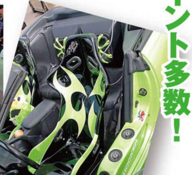
サイドシルとドア内装を加工してスピーカーを増設。シートはフルバケから表皮を除いてFRPで表面処理をしている。
