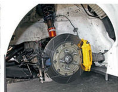
今回タイヤ、ホイールの入れ替えもあったためまず疑ったのがホイールなどのアンバランス。その後、アーム類やシャフト類、各部の緩みなどでチェックを繰り返した。
