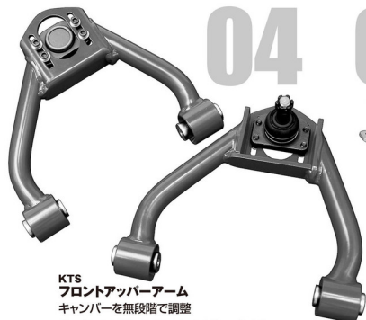
KTS 調整式強化アーム 調整式アームで自由度拡大
