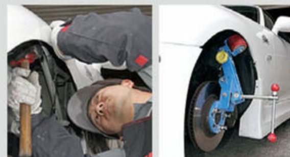
ハンマーワークによるペタ折り ベンディングツールによるツメ折り
