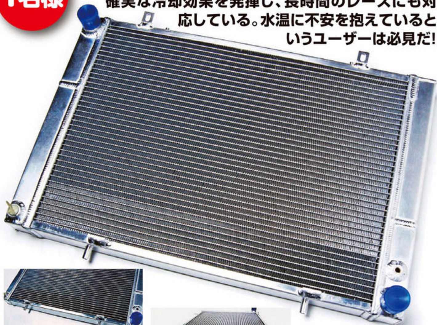
フルアルミ製のサイドフロー式コアを採用して冷却水の熱交換効率をアップ。厚みは40mmと薄くオーバーハングの軽量化にも効果を発揮する。シルビア用はダブルターン水流方式となる。
