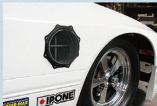
エンジンから直接、右フェンダーをぶち抜く形で出されたマフラー。127φのワンオフで、ブリッジポードのロータリー特有ともいえるエキゾーストノートを奏でる。
