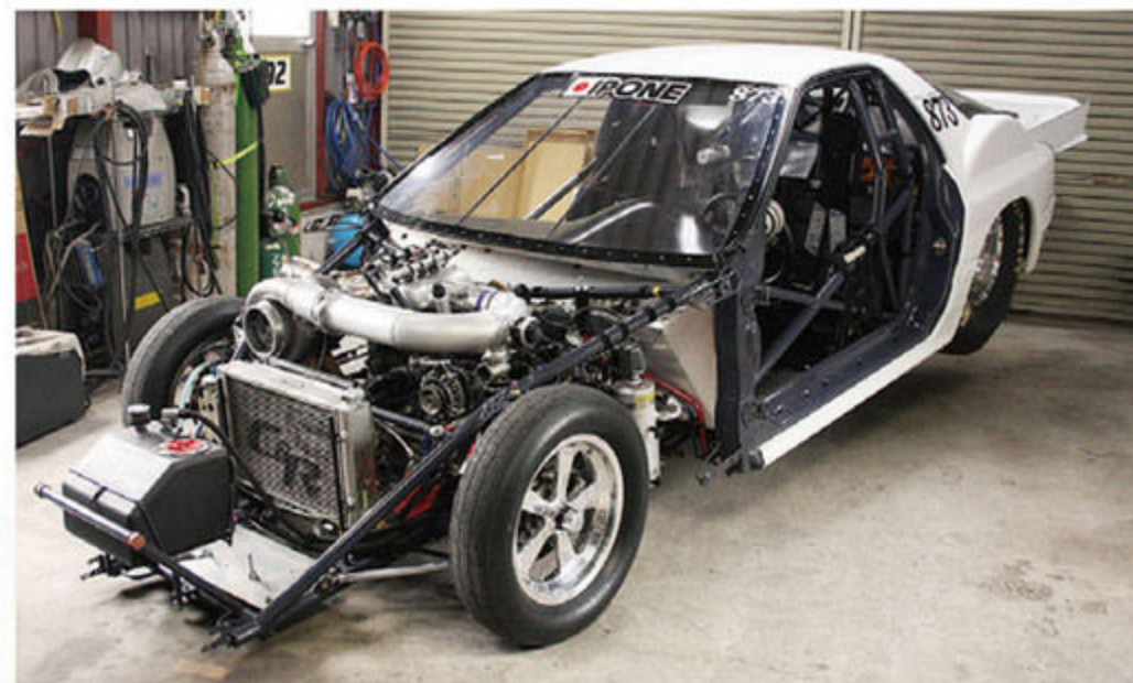
フレームは、プロストックカーでも使用されたキャバリエのクロモリ製パイプフレームキットがベース。高いボディ剛性と軽さを誇る。
