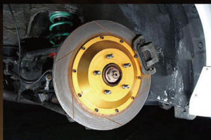
フロントはブレンボのキャリパーで強化し、リヤはローター系のみ大型化している。サーキット走行を前提としているため、可動部はフルピロ化されている。
