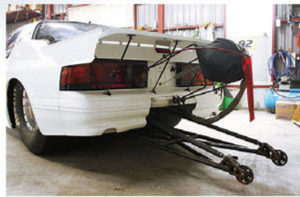
ウィリーバーとパラシュートが装備され、これぞドラッグマシン! というリヤビュー。タイヤは、フージャーのドラッグスリック。超大径タイヤを納めるためのフェンダーの造形にも注目。
