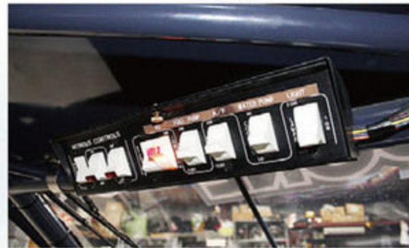
運転席の頭上には、コントロールスイッチを配置。イグニッションやポンプ系の起動スイッチなどがここに集約されている。
