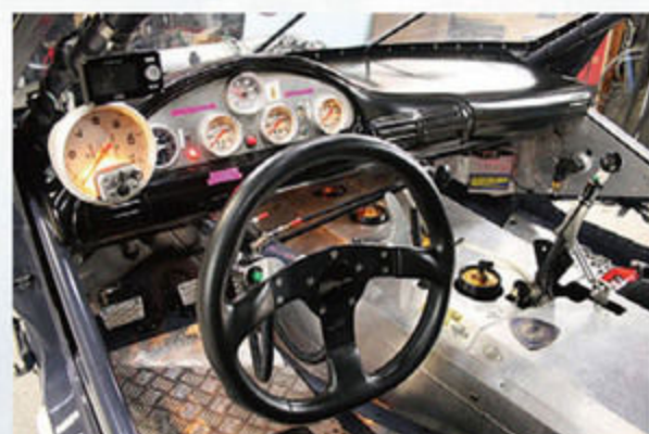
レース用FRP製ダッシュパネルを装着した左ハンドルのコクピット。ペダルはブレーキとクラッチがオルガン式に変更されている。メーターは、オートメーター製品が整然と並べられナイトイベント用にライトも点灯可能。
