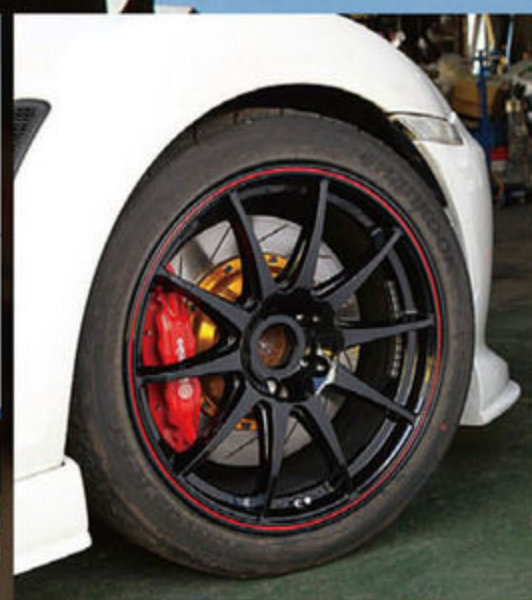
フロントはブレンボのキャリパーで強化し、リヤはローター系のみ大型化している。サーキット走行を前提としているため、可動部はフルピロ化されている。
