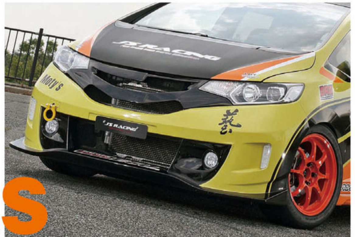
フロントGTバンパースポイラーTYPE-Sは冷却性能・空力性能のアップを目指して開発され、スーパー耐久公認エアロパーツとしてレースでも使用されている新製品。ストリートでの使い勝手にも配慮されており、ロードダウンを前提に純正バンパーと同等の最低地上高が確保されている。価格は8万4240円。
