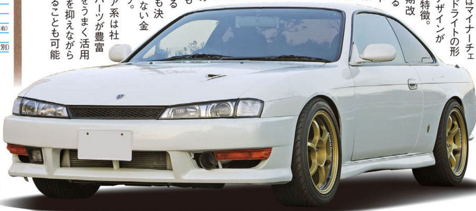
フロントはコアサポートの溶接が必要となるものの、リアまわりは基本的にはボルトオンで交換が可能。テールライトのデザイン変更や大型化したリヤウイングでスポーティなイメージに変身する。
