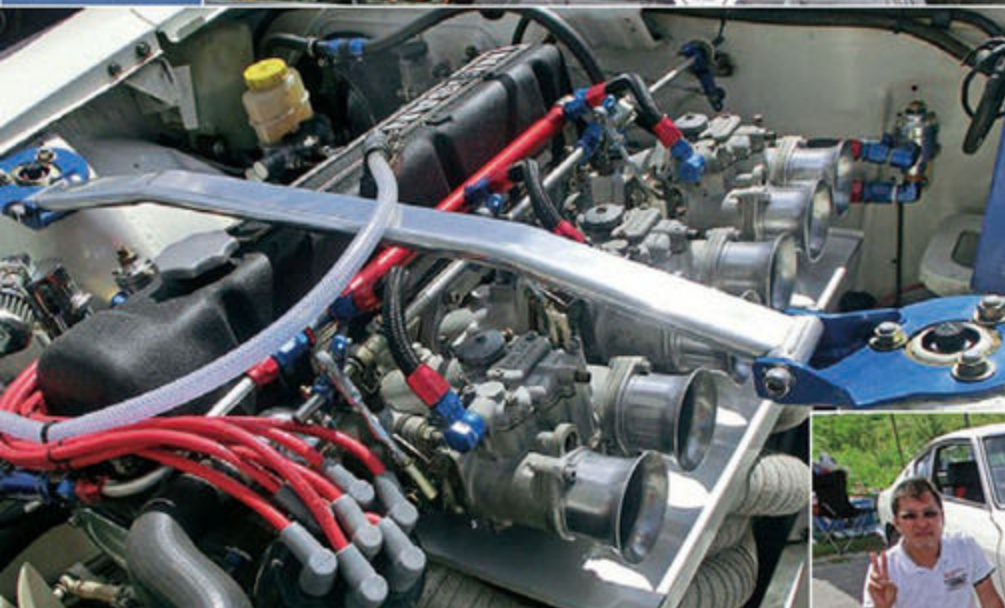
LDクランク仕様のメカチューンに エスコート製ワンオフエキゾースト!!
