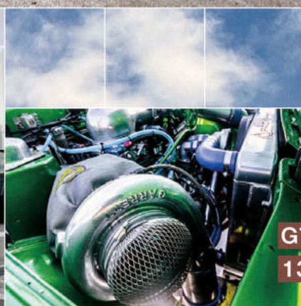
強化ピストン&コンロッドの2JZに T51R SPLタービンを装着
