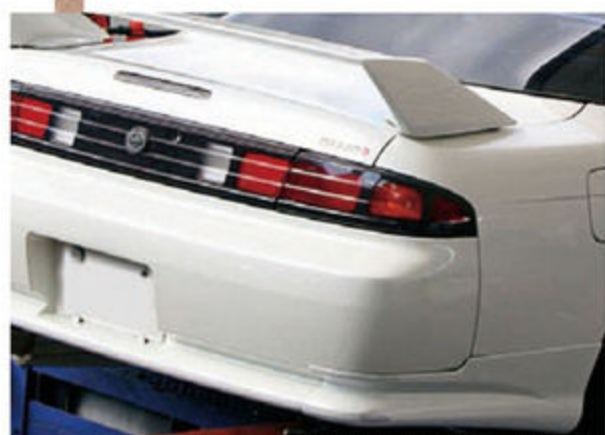
フロントはコアサポートの溶接が必要となるものの、リアまわりは基本的にはボルトオンで交換が可能。テールライトのデザイン変更や大型化したリヤウイングでスポーティなイメージに変身する。
