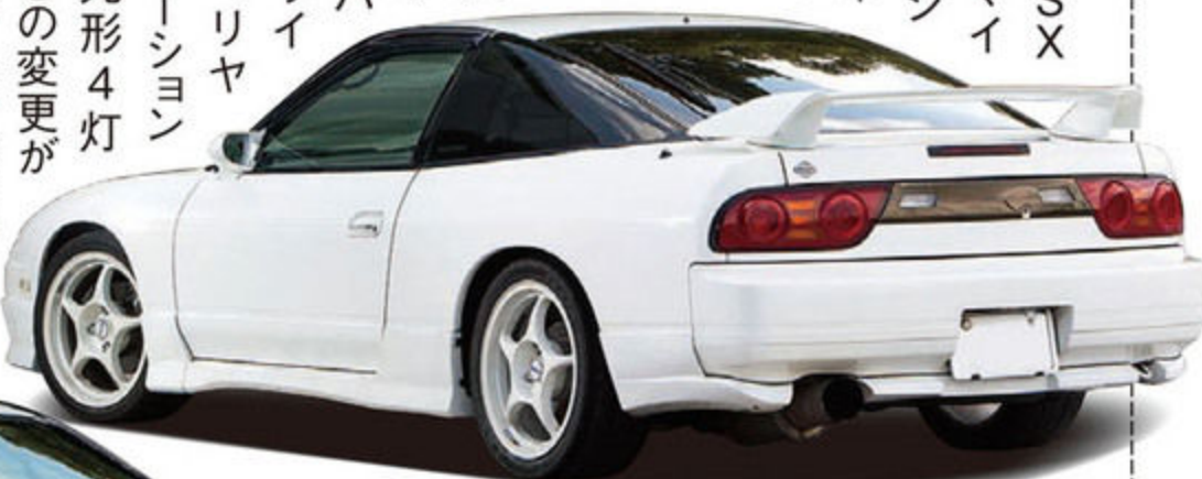
リアコンビネーションランプを交換する際には、その下のガーニッシュ部分(シールド、サイト、リアバンパー)も交換が必要となるので注意したい。
